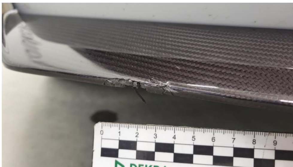
Fot. 75. Spoiler zderzaka przedniego() - Pęknięcie/rozerwanie 3
