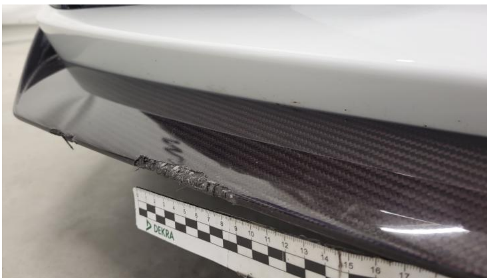
Fot. 74. Spoiler zderzaka przedniego - Pęknięcie/rozerwanie 2
