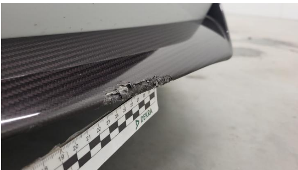
Fot. 73. Spoiler zderzaka przedniego - Pęknięcie/rozerwanie 1
