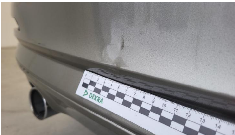
Fot. 59. Zderzak tylny - Wgniecenie/odkształcenie 2
