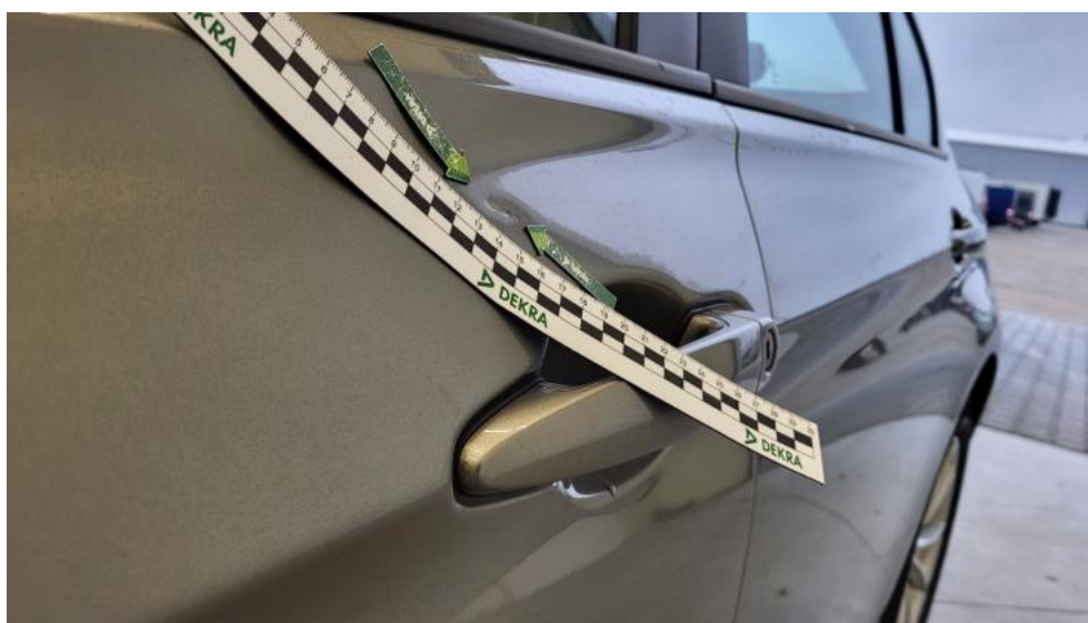
Fot. 67. Drzwi przed L - Wgniecenie/odkształcenie 1
