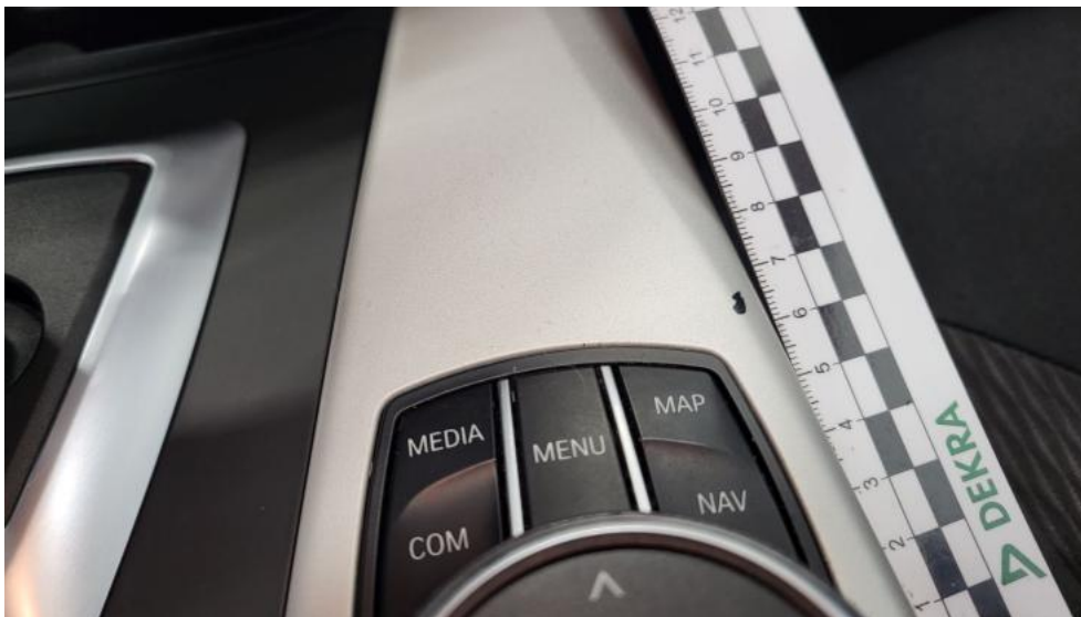
Fot. 71. Konsola środkowa - Rysa/odprysk 1
