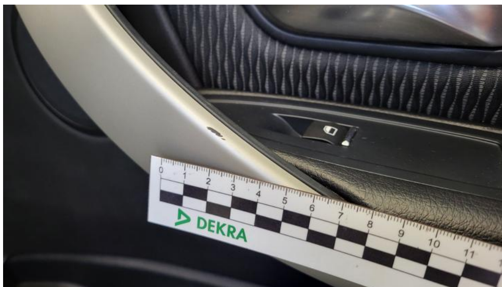
Fot. 79. Uchwyt drzwi prze P - Rysa/odprysk 1
