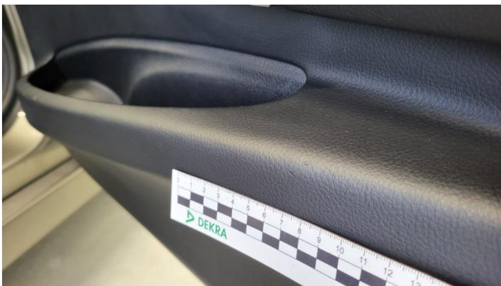
Fot. 77. Tapicerka drzwi przednich P - Wgniecenie/odkształcenie 2
