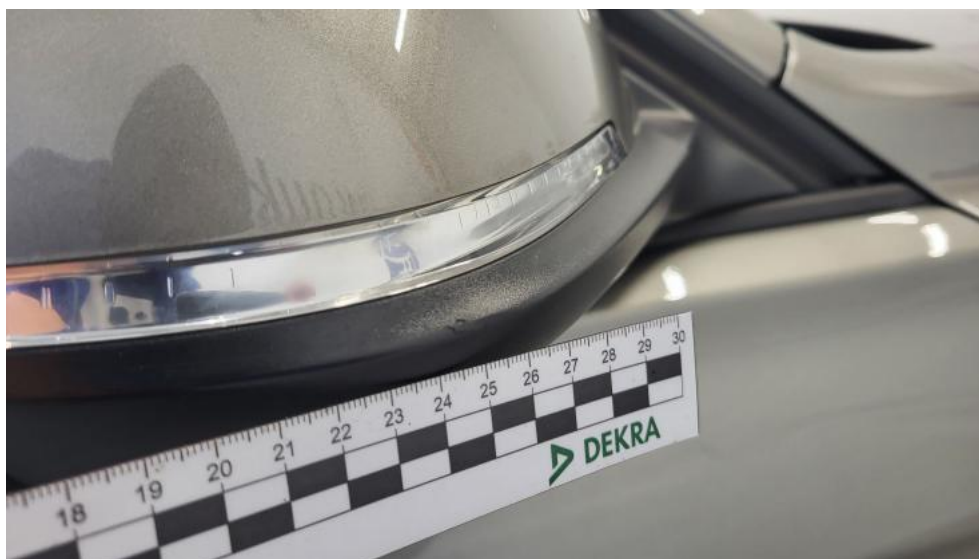
Fot. 55. Lusterko zew P - Rysa/odprysk 1
