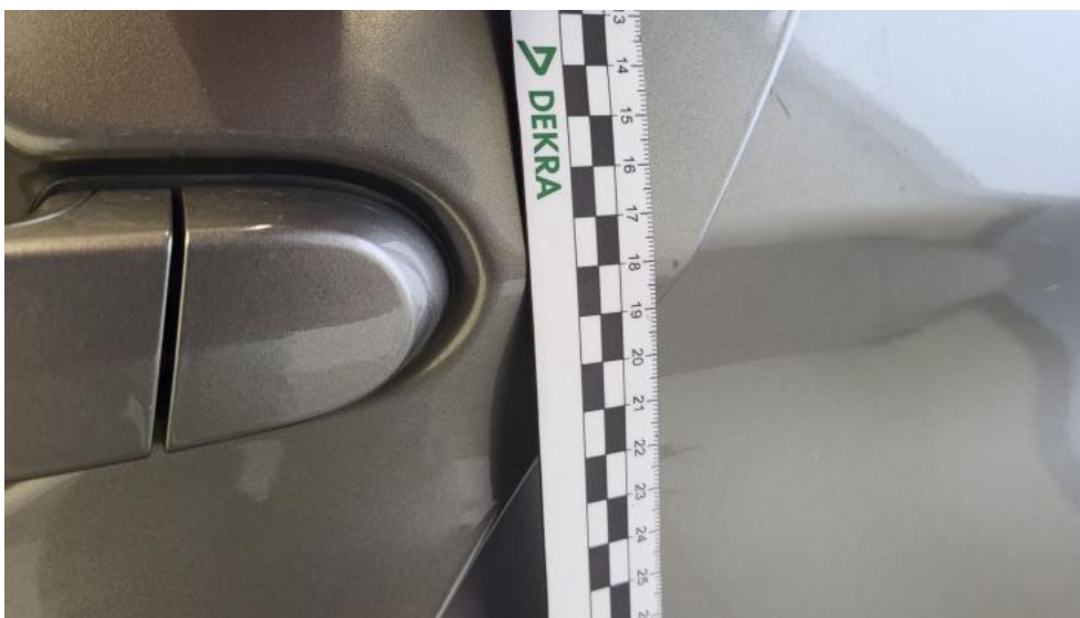
Fot. 69. Drzwi tylne L - Rysa/odprysk 2
