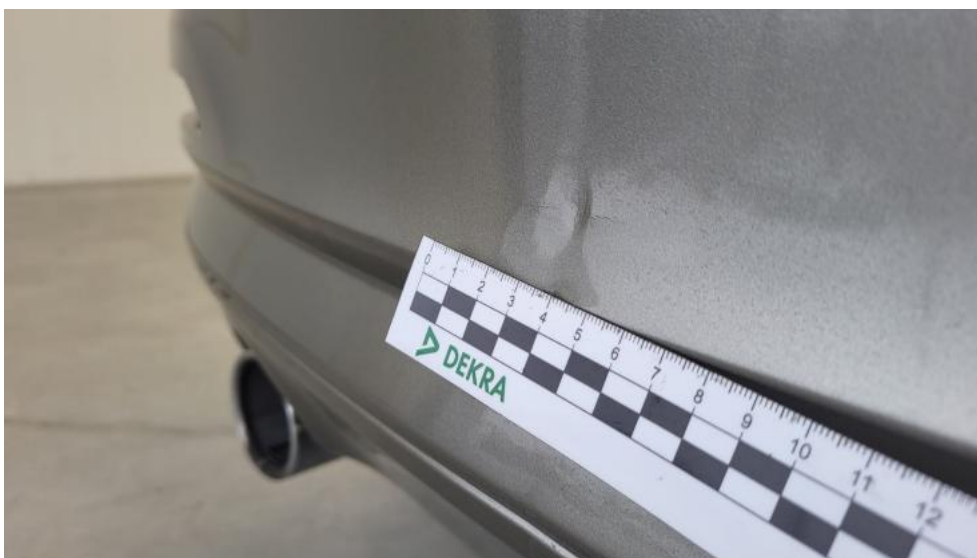
Fot. 60. Zderzak tylny - Pęknięcie/rozerwanie 1
