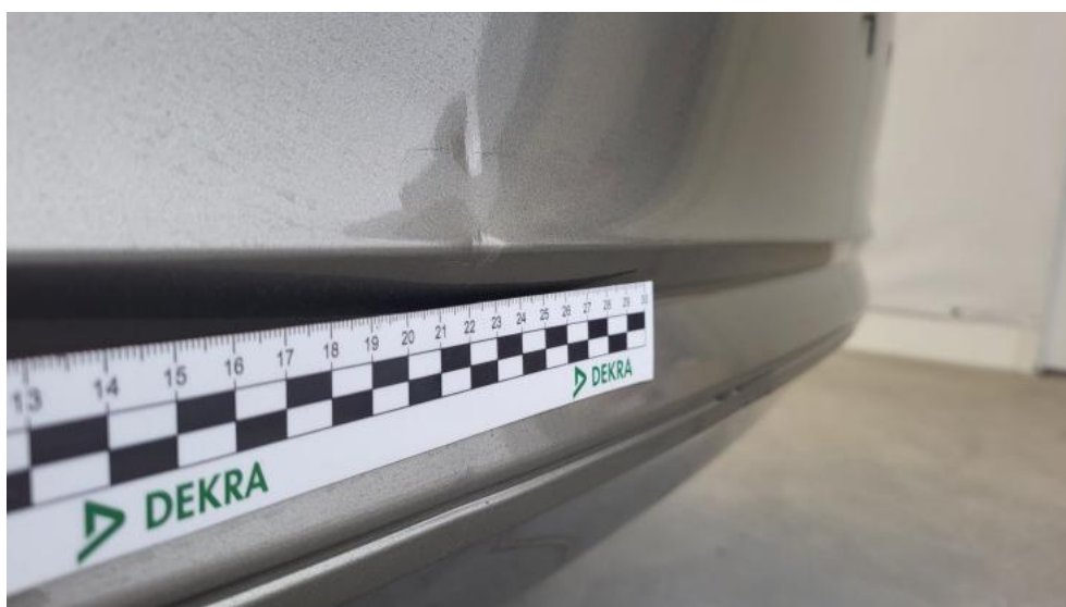
Fot. 58. Zderzak tylny - Wgniecenie/odkształcenie 1
