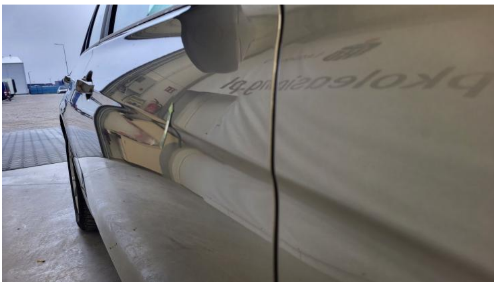
Fot. 54. Drzwi przednie P - Wgniecenie/odkształcenie 1
