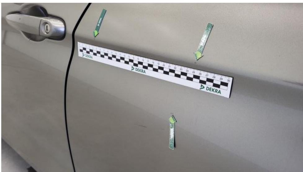
Fot. 70. Drzwi tylne L() - Rysa/odprysk 3
