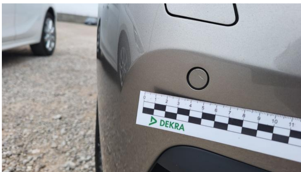
Fot. 44. Czujniki parkowania przód - Rysa/odprysk 1
