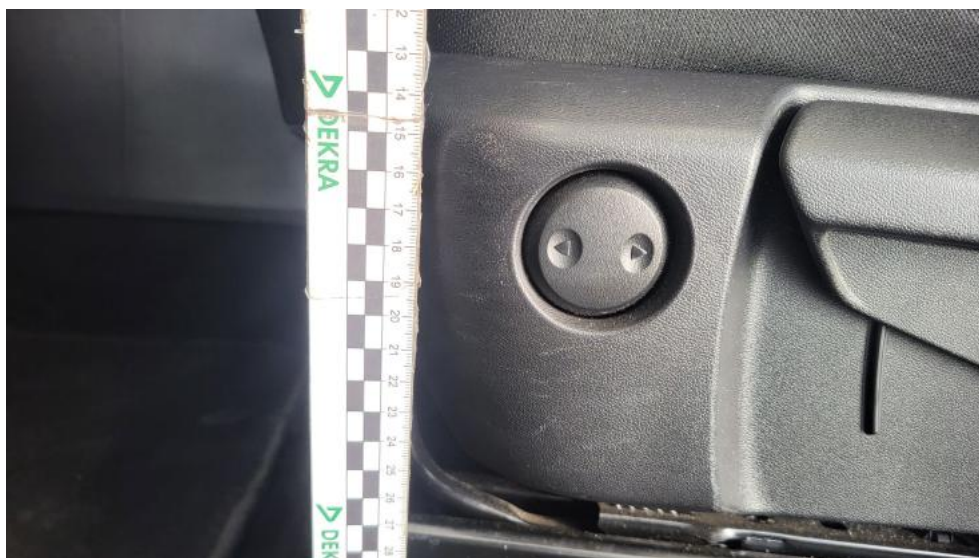
Photo 70. Fotel prz. lew. - Rysa/odprysk 1
