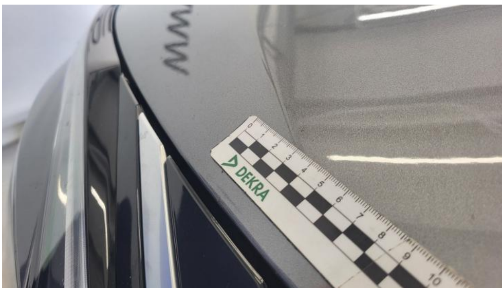
Photo 41. Pokrywa komory silnika() - Rysa/odprysk 3
