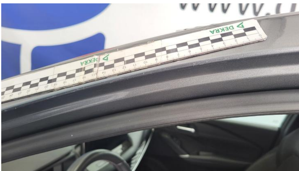
Photo 64. Stupek przedni L - Rysa/odprysk 2
