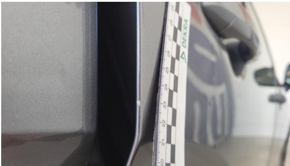
Photo 51. Drzwi tylne P - Rysa/odprysk 1
