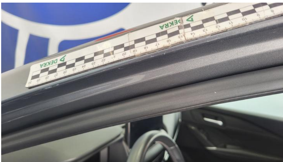
Photo 63. Stupek przedni L - Rysa/odprysk 1
