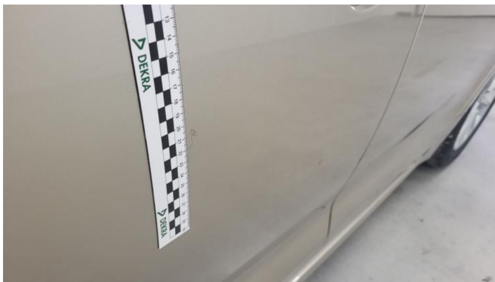
Fot. 45. Drzwi przed L - Rysa/odprysk 1
