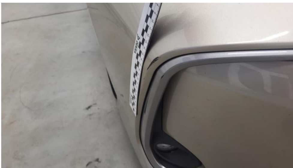
Fot. 39. Zderzak - Rysa/odprysk 2
