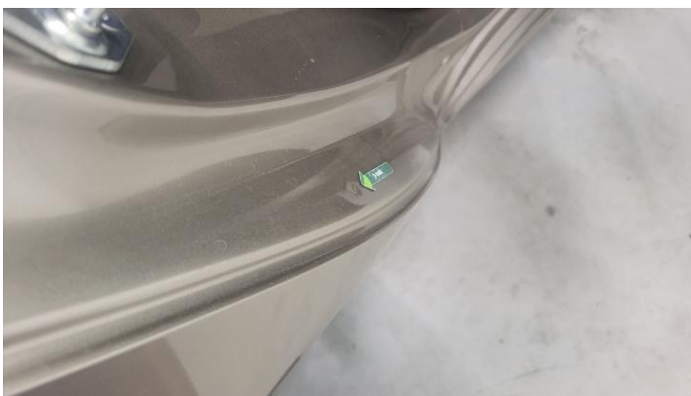
Fot. 40. Słupek tylny prawy - Wgniecenie/odkształcenie 1
