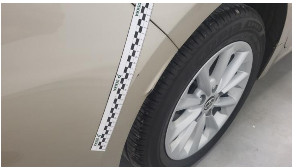
Fot. 42. Zderzak tylny - Rysa/odprysk 2
