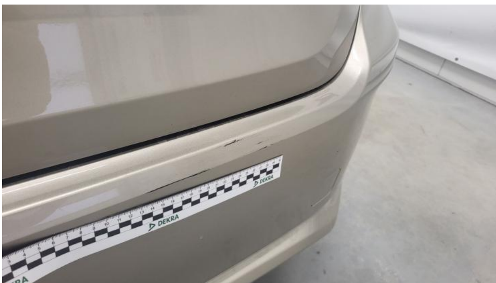
Fot. 41. Zderzak tylny - Rysa/odprysk 1
