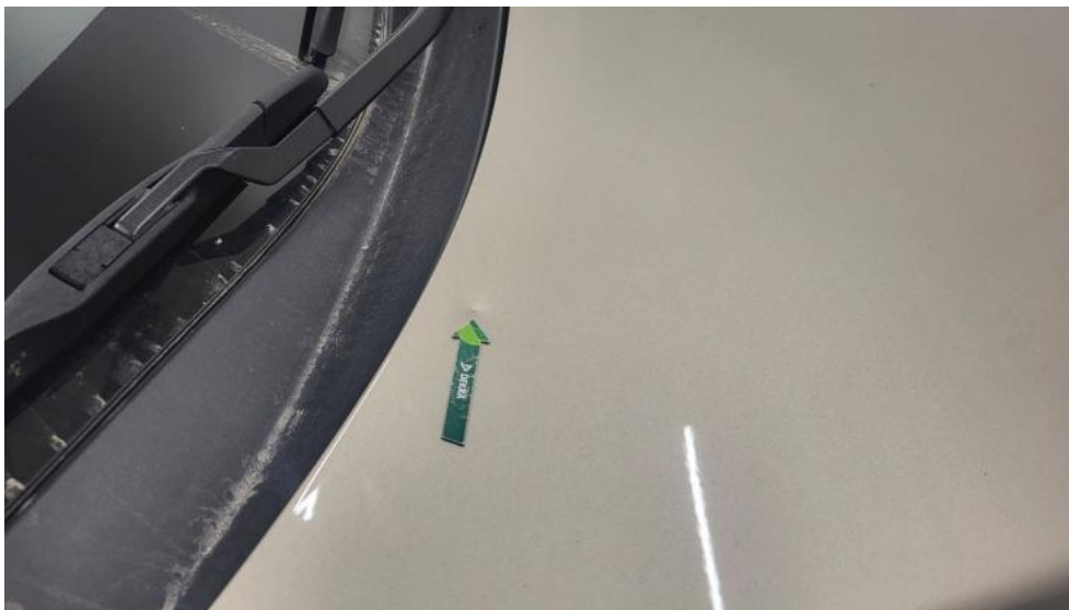
Fot. 37. Pokrywa komory silnika - Wgniecenie/odkształcenie 1
