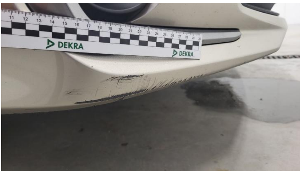
Fot. 38. Zderzak - Rysa/odprysk 1
