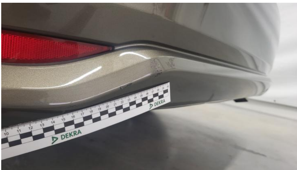
Photo 44. Zderzak tylny - Rysa/odprysk 2
