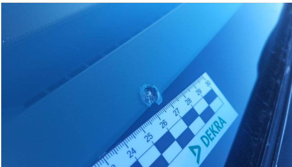
Photo 40. Szyba czołowa - Pęknięcie/rozerwanie 2
