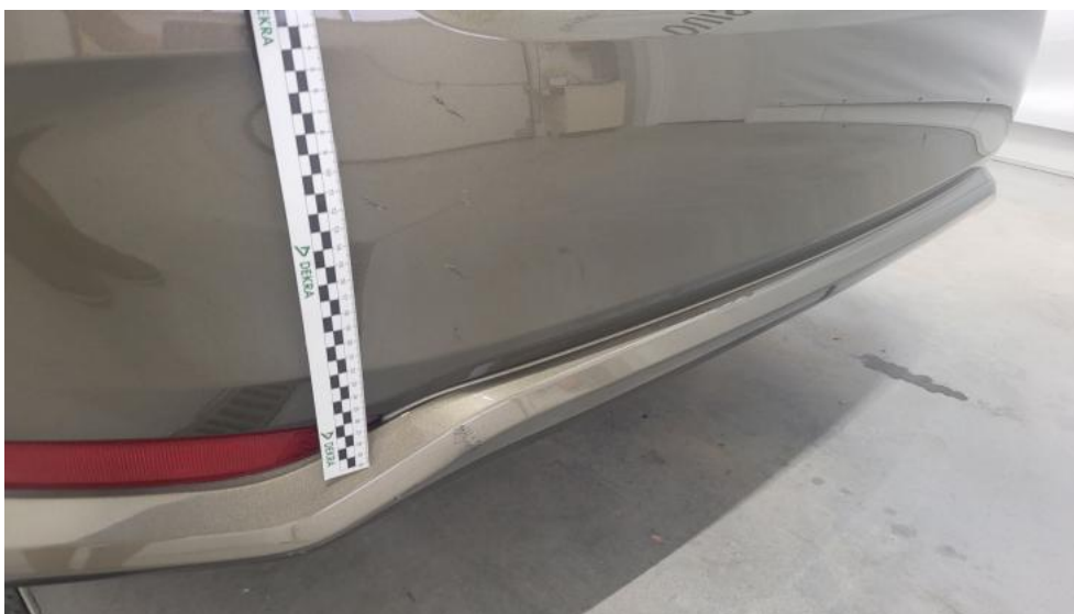
Photo 43. Zderzak tylny - Rysa/odprysk 1
