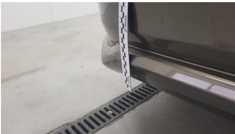
Photo 45. Zderzak tylny - Wgniecenie/odkształcenie 1
