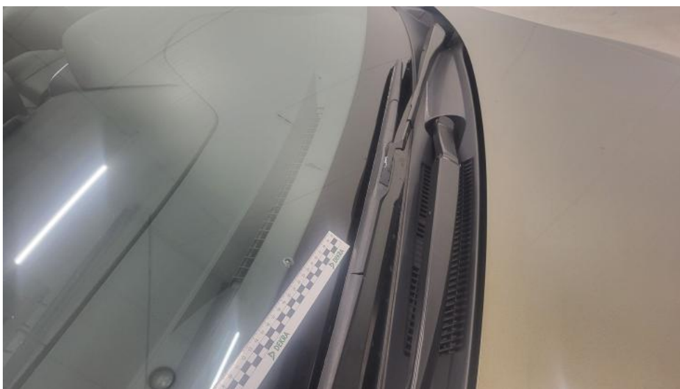
Photo 39. Szyba czołowa - Pęknięcie/rozerwanie 1
