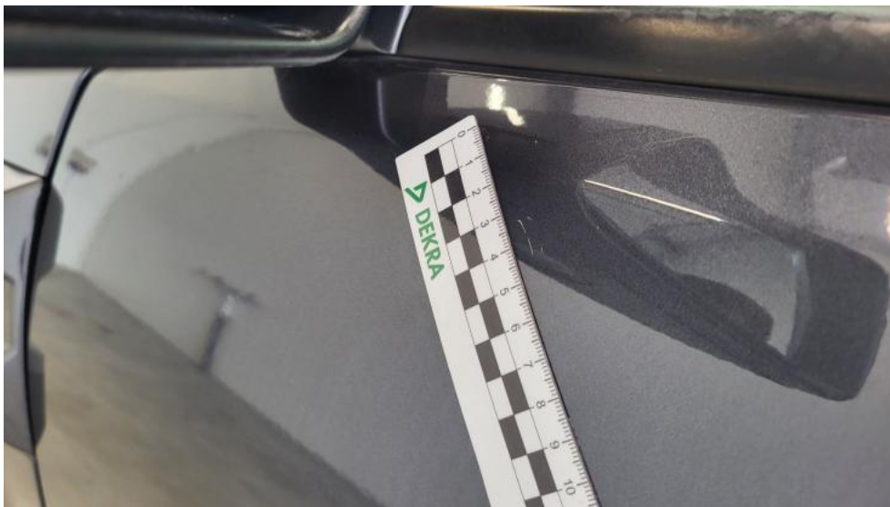
Fot. 59. Drzwi przed L - Rysa/odprysk 1
