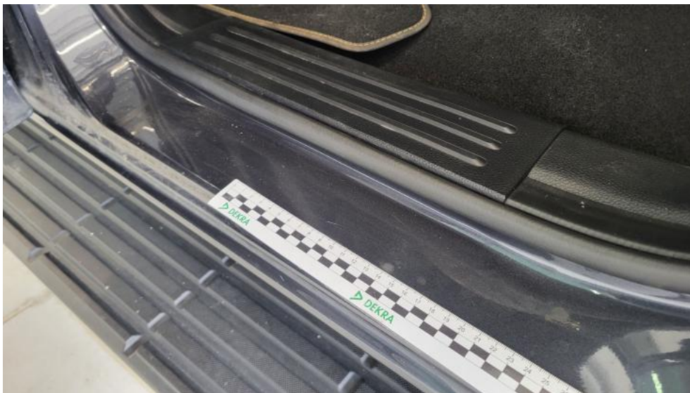
Fot. 65. Próg L - Rysa/odprysk 1
