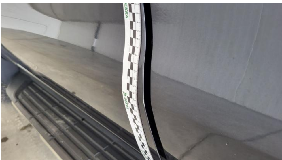
Fot. 60. Drzwi przed L - Rysa/odprysk 2
