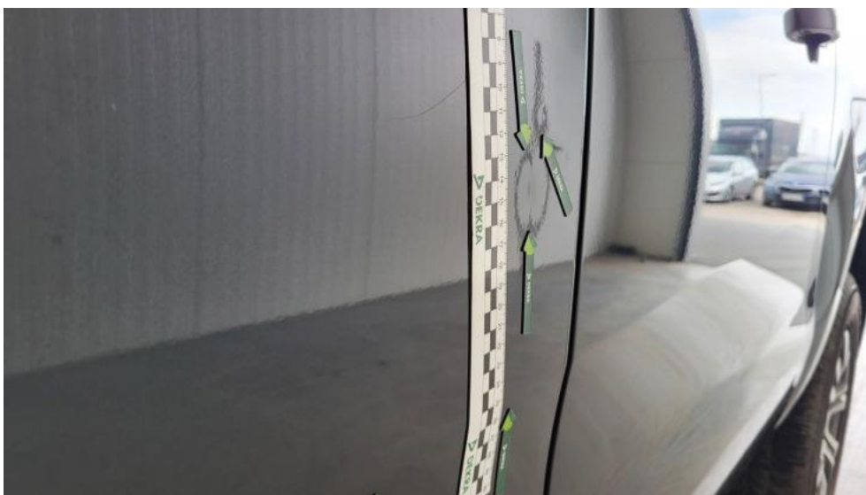
Fot. 61. Drzwi przed L - Wgniecenie/odkształcenie 1
