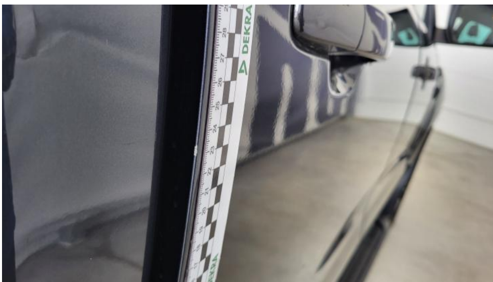
Fot. 43. Drzwi tylne P - Rysa/odprysk 1
