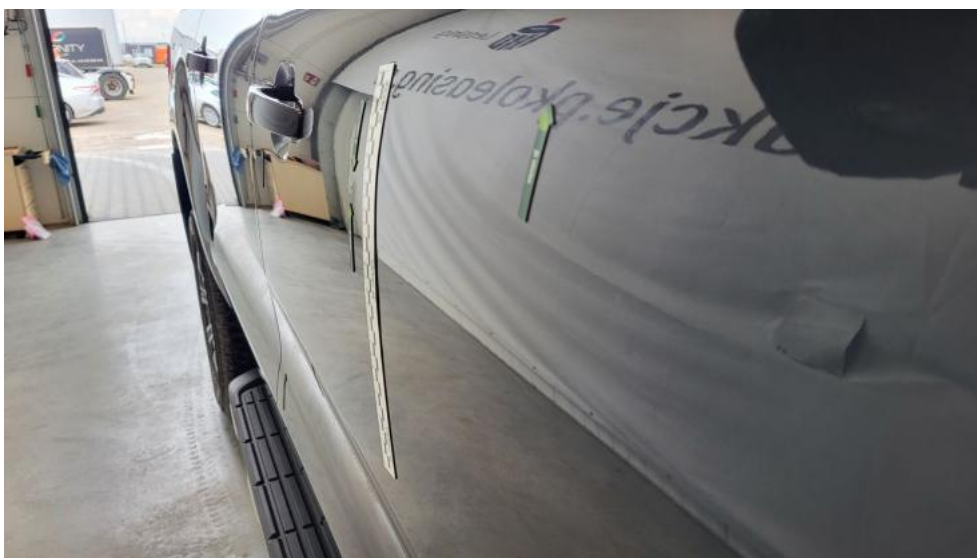
Fot. 42. Drzwi przednie P - Wgniecenie/odkształcenie 1
