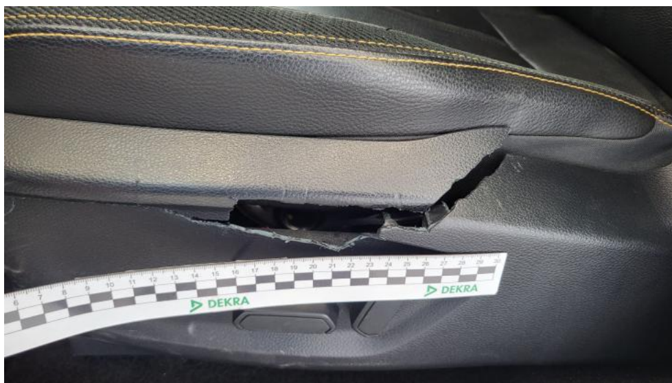
Fot. 70. Fotel prz. lew. - Pęknięcie/rozerwanie 1
