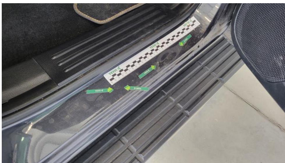
Fot. 46. Próg P - Wgniecenie/odkształcenie 2
