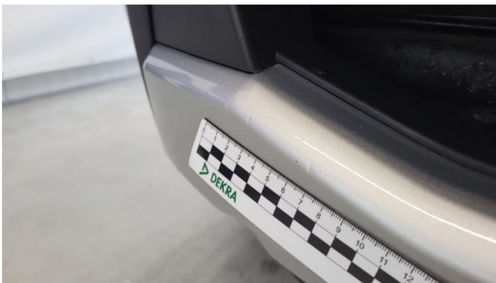
Fot. 38. Spoiler zderzaka przedniego - Wgniecenie/odkształcenie 1
