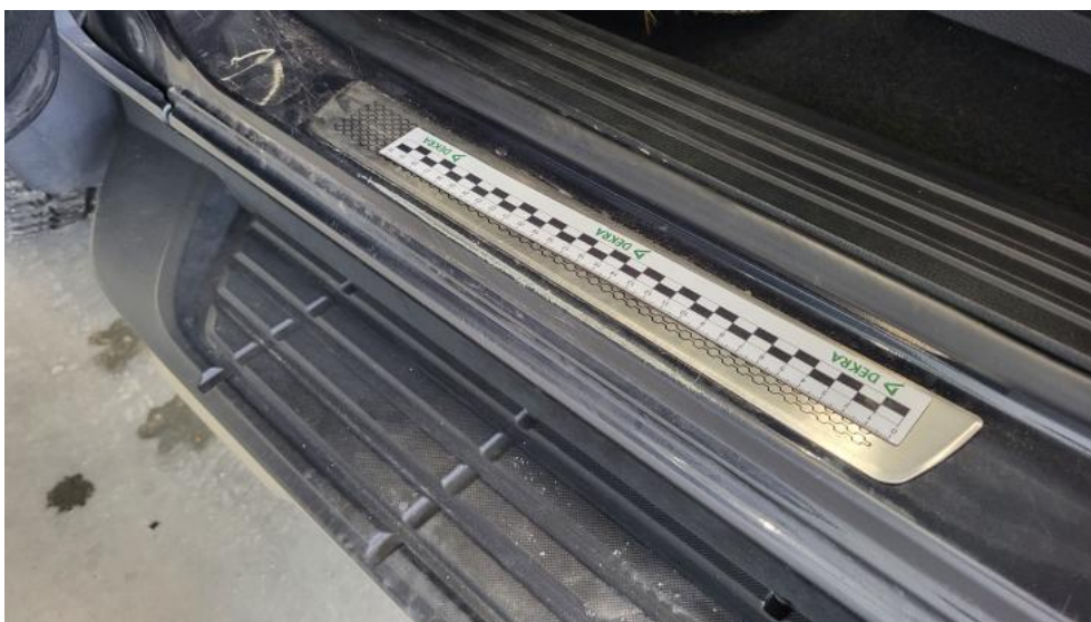
Fot. 66. Próg L - Rysa/odprysk 2
