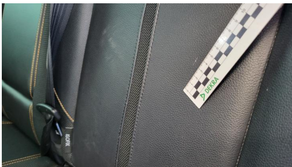
Fot. 72. Kanapa tyl. - Rysa/odprysk 1
