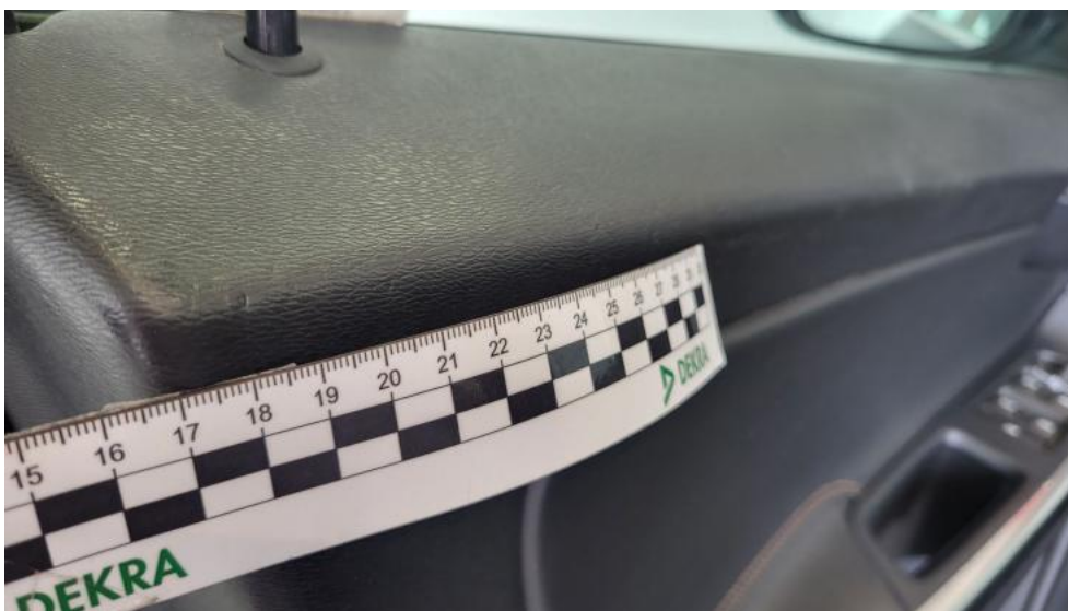
Fot. 67. Tapicerka drzwi przednich L - Wgniecenie/odkształcenie 2
