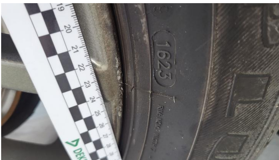
Fot. 52. Felga aluminiowa tylna P - Rysa/odprysk 1
