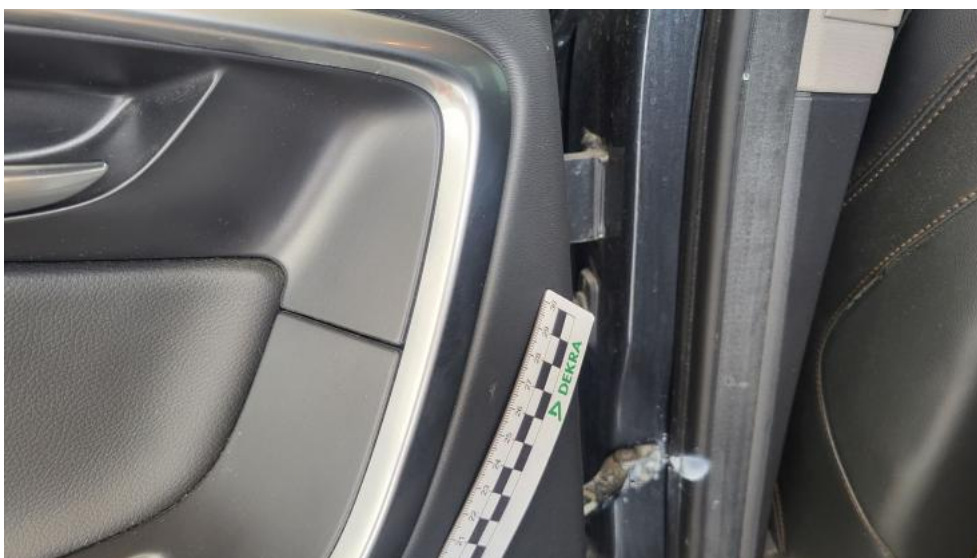
Fot. 70. Tapicerka drzwi tylnych L - Wgniecenie/odkształcenie 2
