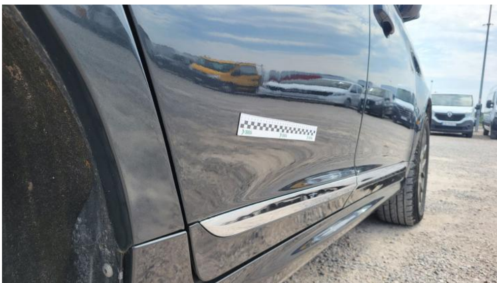
Fot. 48. Drzwi tylne P - Wgniecenie/odkształcenie 2
