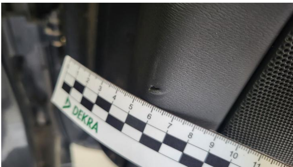
Fot. 68. Tapicerka drzwi przednich P - Pęknięcie/rozerwanie 1
