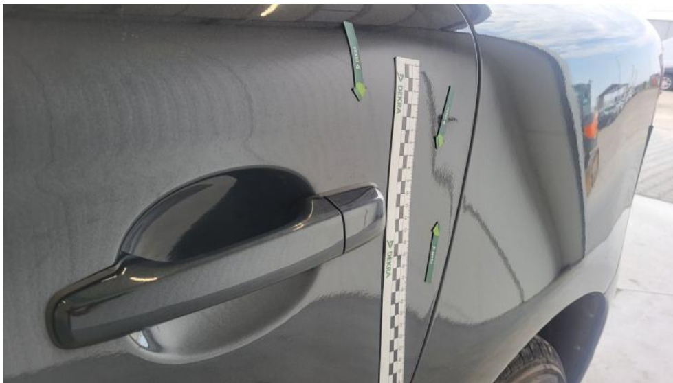
Fot. 61. Drzwi tylne L() - Wgniecenie/odkształcenie 3
