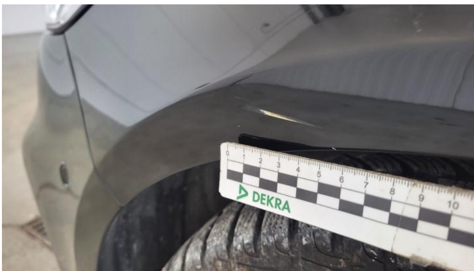
Photo 68. Błotnik przedni L - Rysa/odprysk 1
