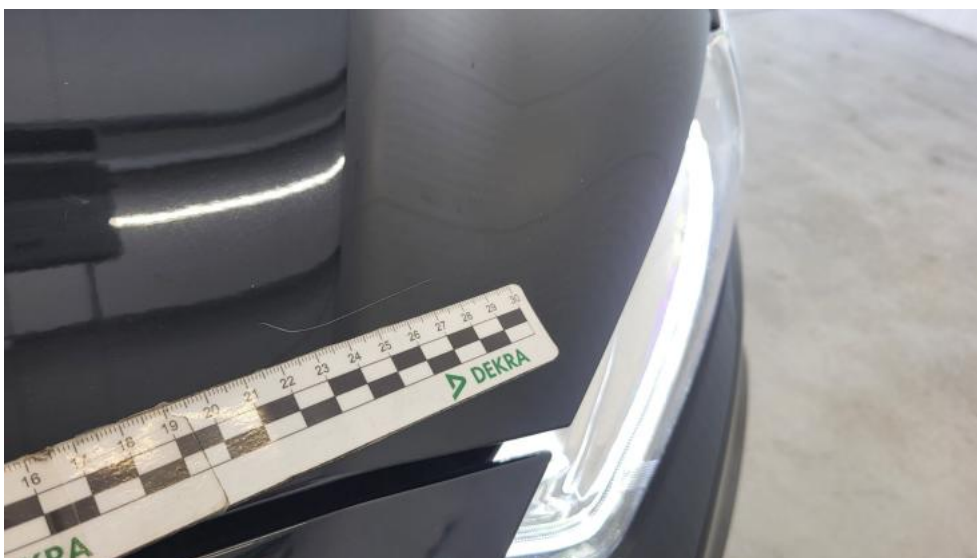
Photo 40. Pokrywa komory silnika - Rysa/odprysk 2
