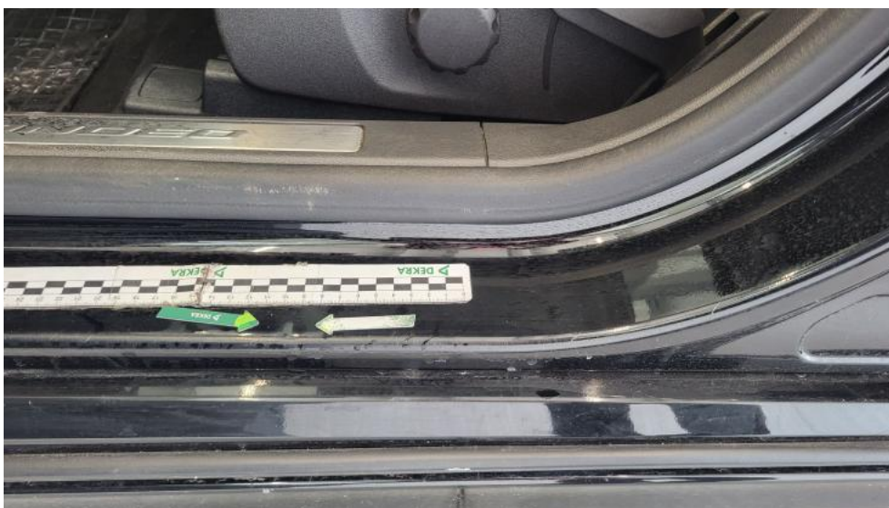
Photo 67. Próg L - Wgniecenie/odkształcenie 1
