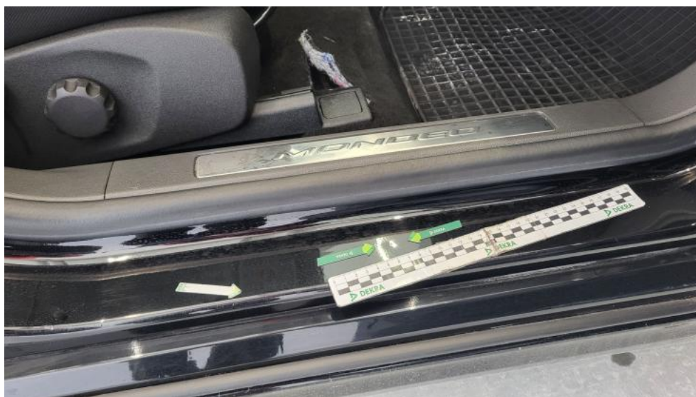
Photo 51. Próg P - Wgniecenie/odkształcenie 1
