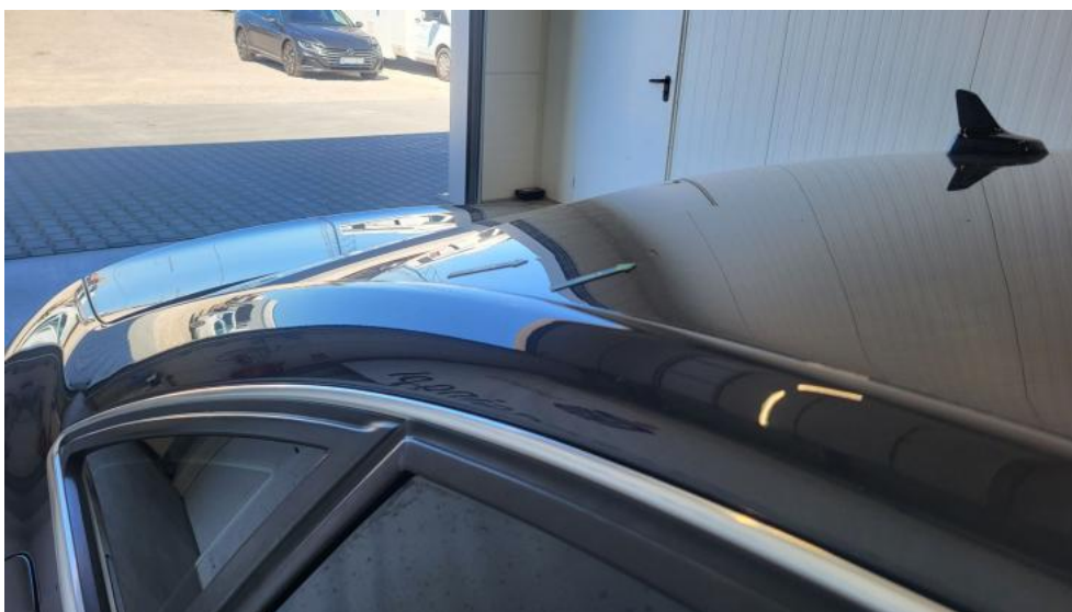
Fot. 56. Dach - Wgniecenie/odkształcenie 1
