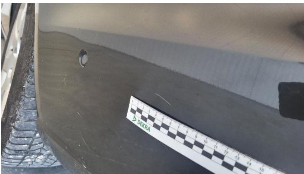
Fot. 55. Zderzak tylny() - Rysa/odprysk 3
