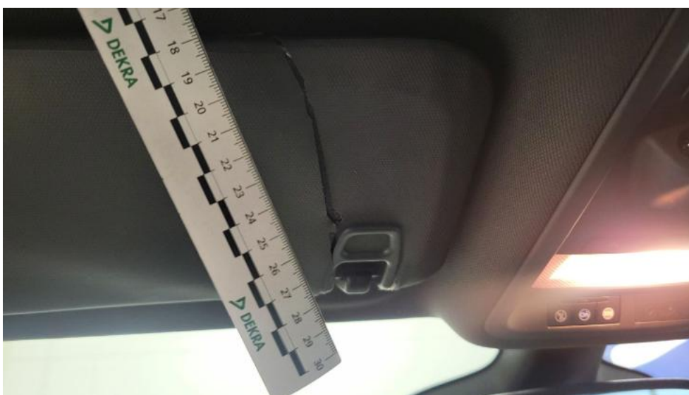
Photo 80. Osłona p/słoneczna lewa - Pęknięcie/rozerwanie 1
