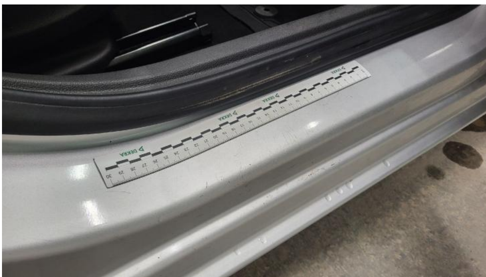
Photo 48. Próg P - Rysa/odprysk 1
