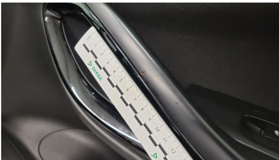
Photo 79. Uchwyt drzwi prze P - Rysa/odprysk 1
