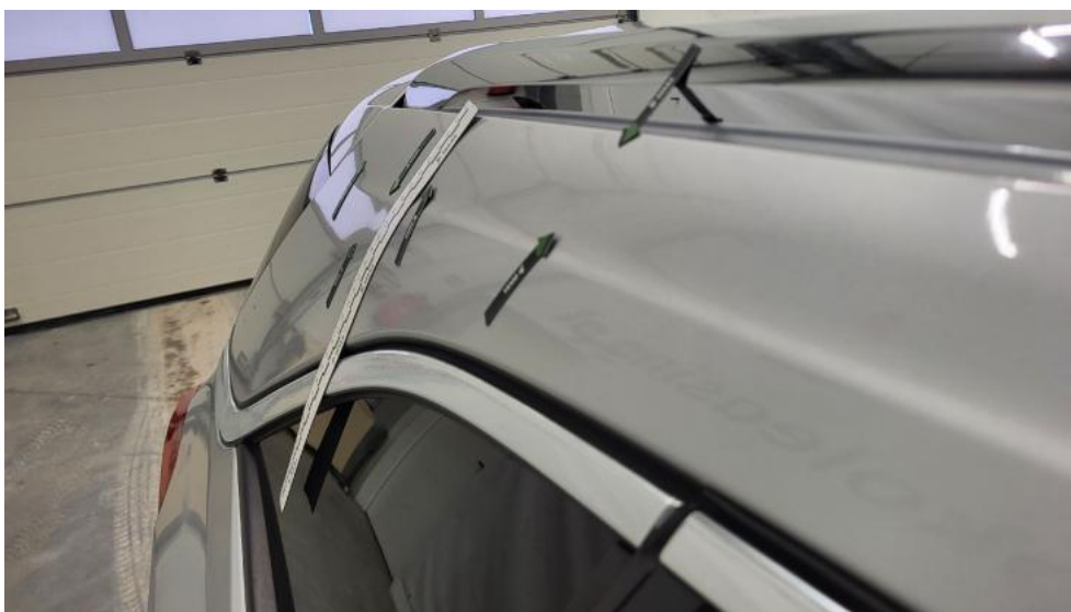
Photo 51. Błotnik tylny P / Ściana boczna P - Wgniecenie/odkształcenie 1
