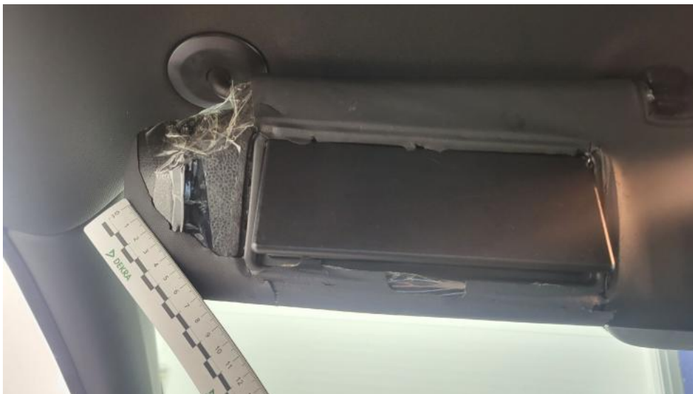
Photo 81. Osłona p/słoneczna lewa - Pęknięcie/rozerwanie 2
