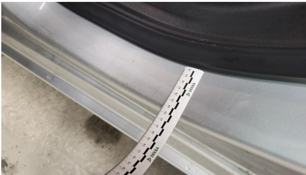
Photo 71. Próg L - Rysa/odprysk 1
