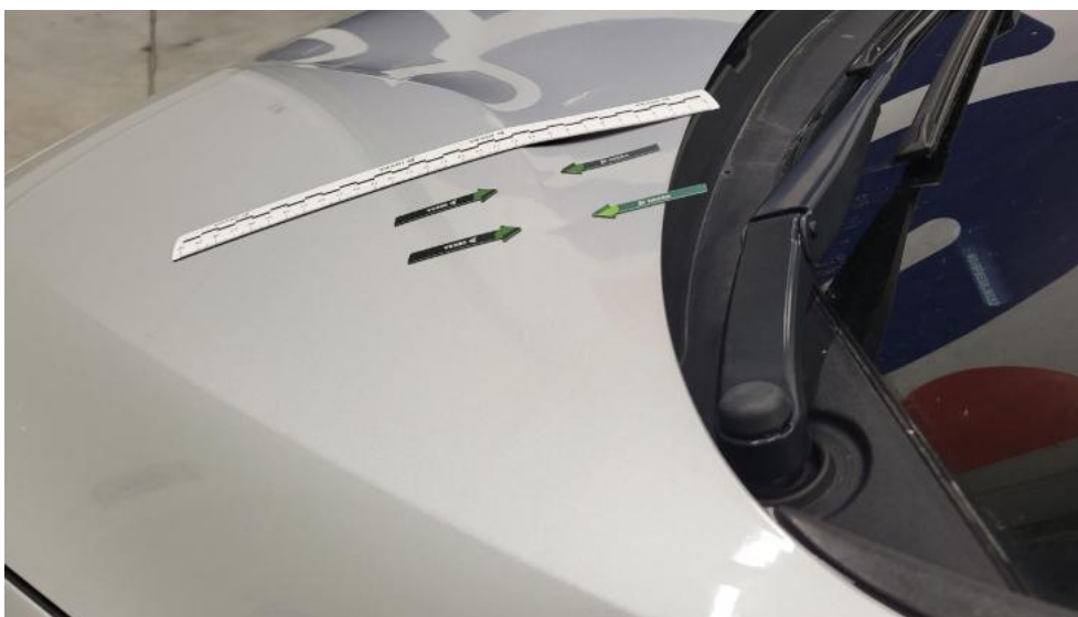
Photo 41. Pokrywa komory silnika - Wgniecenie/odkształcenie 1
