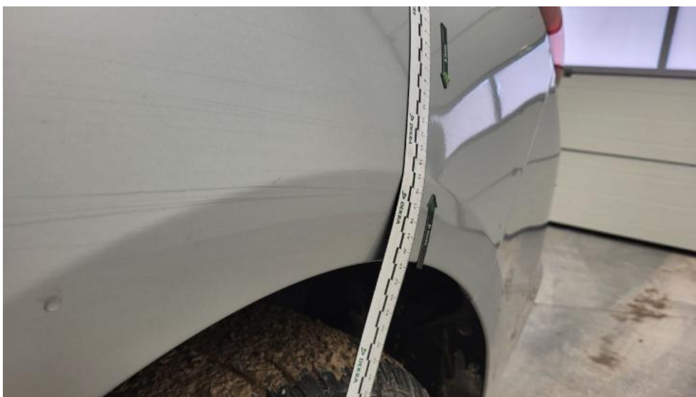
Photo 62. Błotnik tylny L / Ściana boczna L - Wgniecenie/odkształcenie 1
