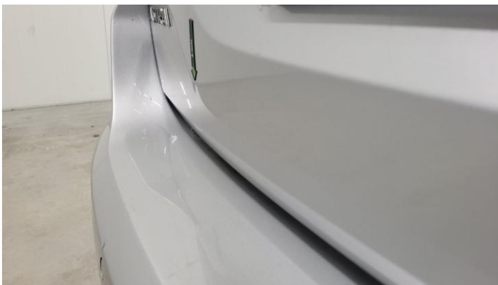
Photo 55. Pokrywy bagażnika - Wgniecenie/odkształcenie 2
