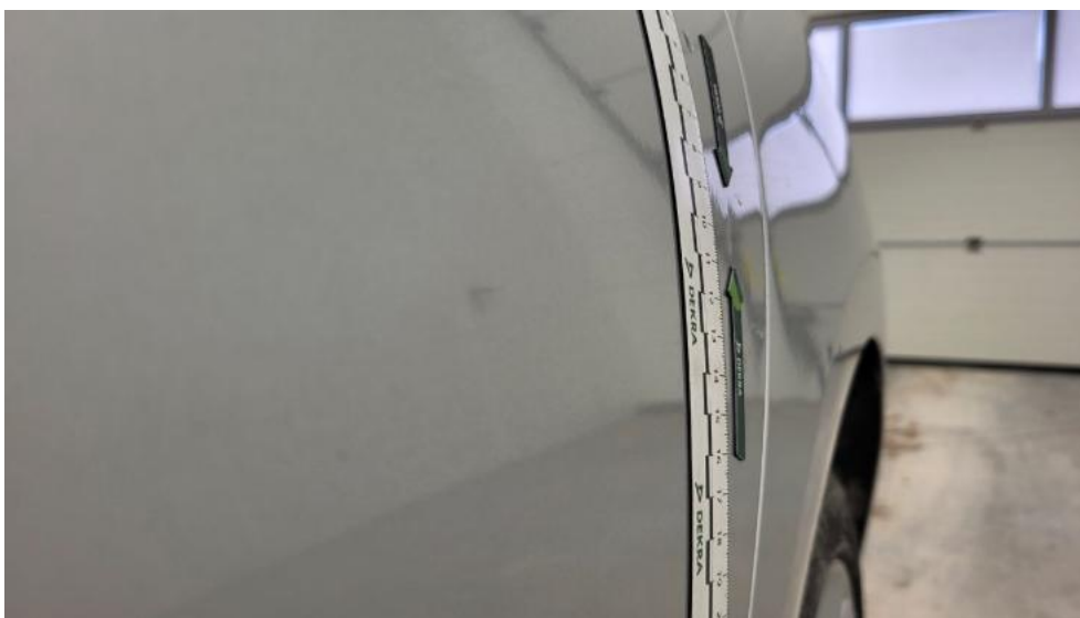
Photo 69. Drzwi tylne L - Wgniecenie/odkształcenie 1
