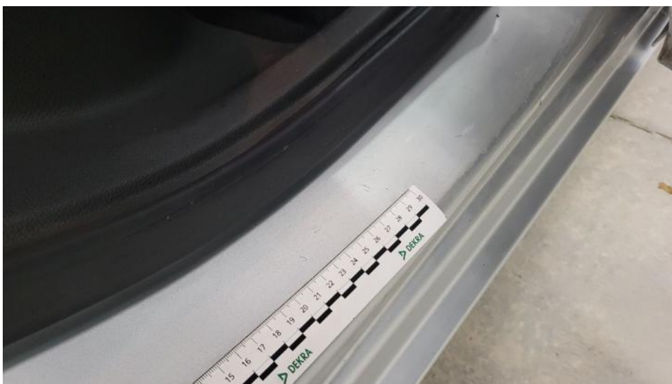
Photo 49. Próg P - Rysa/odprysk 2
