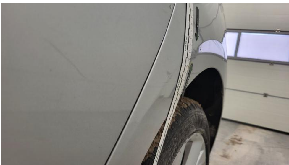
Photo 63. Błotnik tylny L / Ściana boczna L - Wgniecenie/odkształcenie 2
