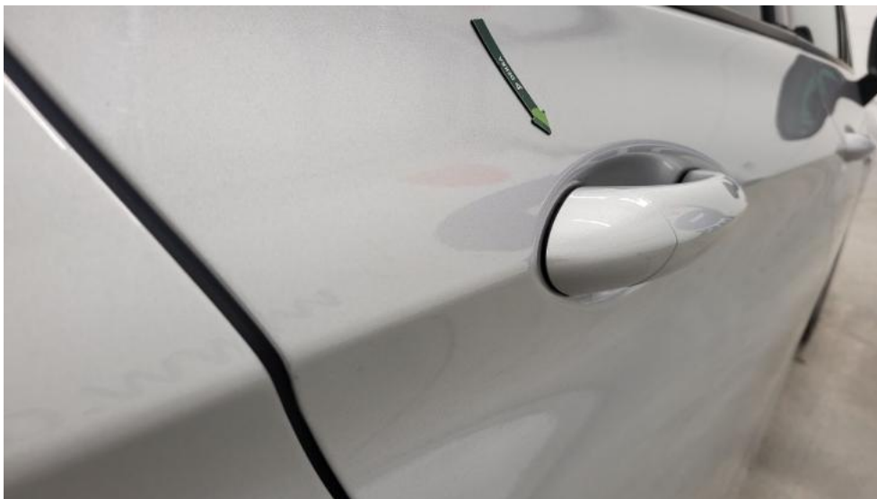
Photo 47. Drzwi tylne P - Wgniecenie/odkształcenie 1
