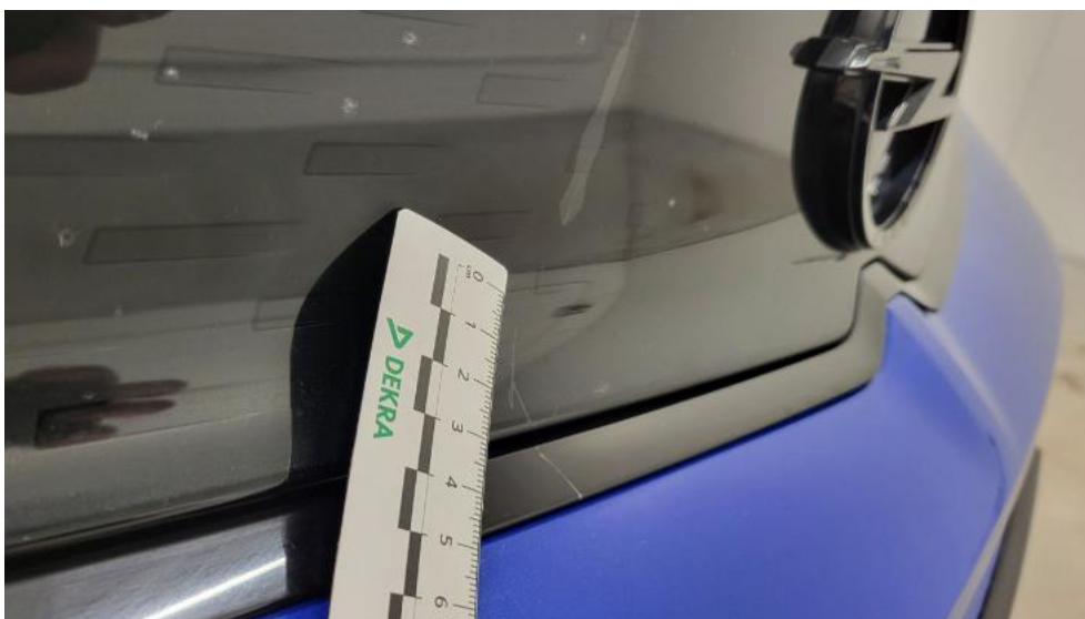
Fot. 38. Atrapa przednia - Rysa/odprysk 1
