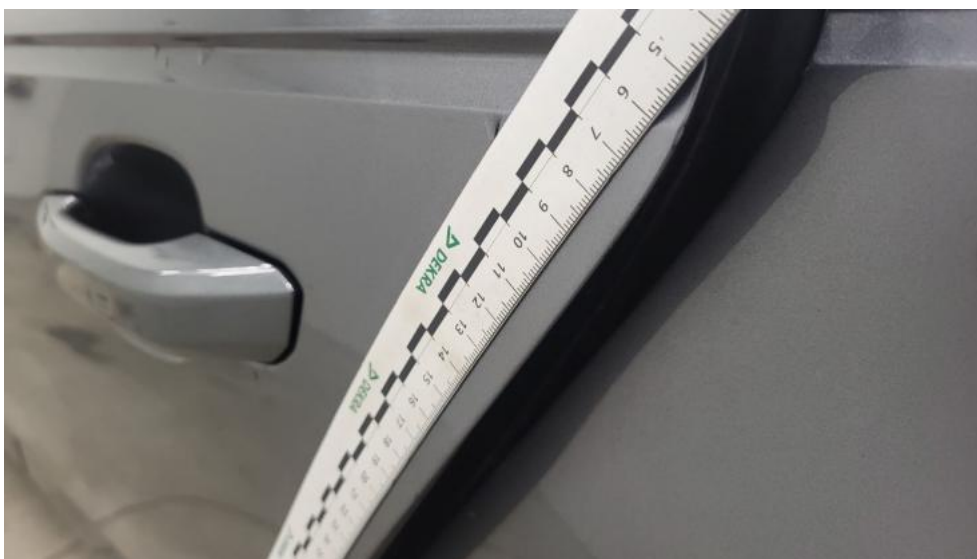
Photo 67. Drzwi tylne L - Rysa/odprysk 1
