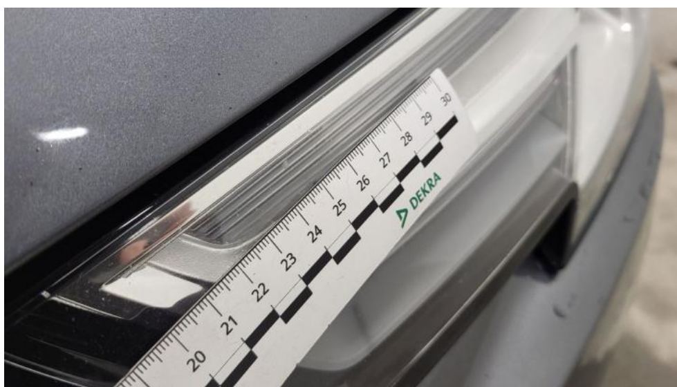
Photo 72. Reflektor L - Rysa/odprysk 1
