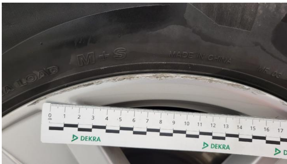
Photo 57. Felga aluminiowa tylna P - Rysa/odprysk 1
