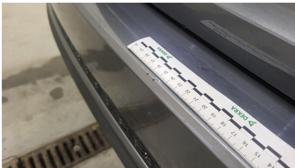
Photo 58. Zderzak tylny - Rysa/odprysk 1
