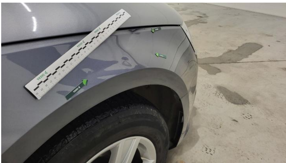
Photo 48. Błotnik przedni P - Wgniecenie/odkształcenie 1
