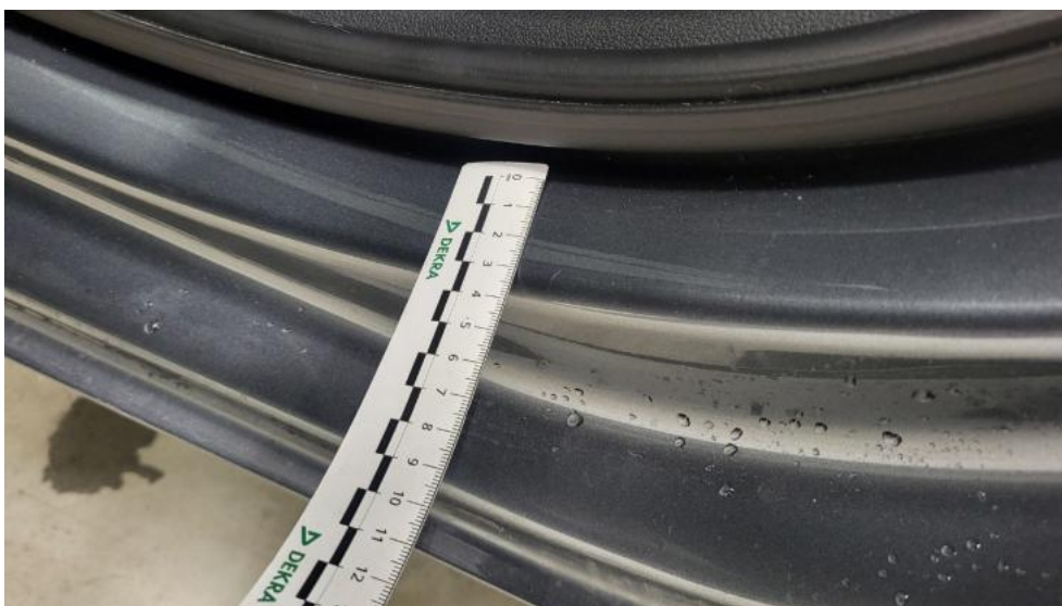
Photo 68. Próg L - Rysa/odprysk 1
