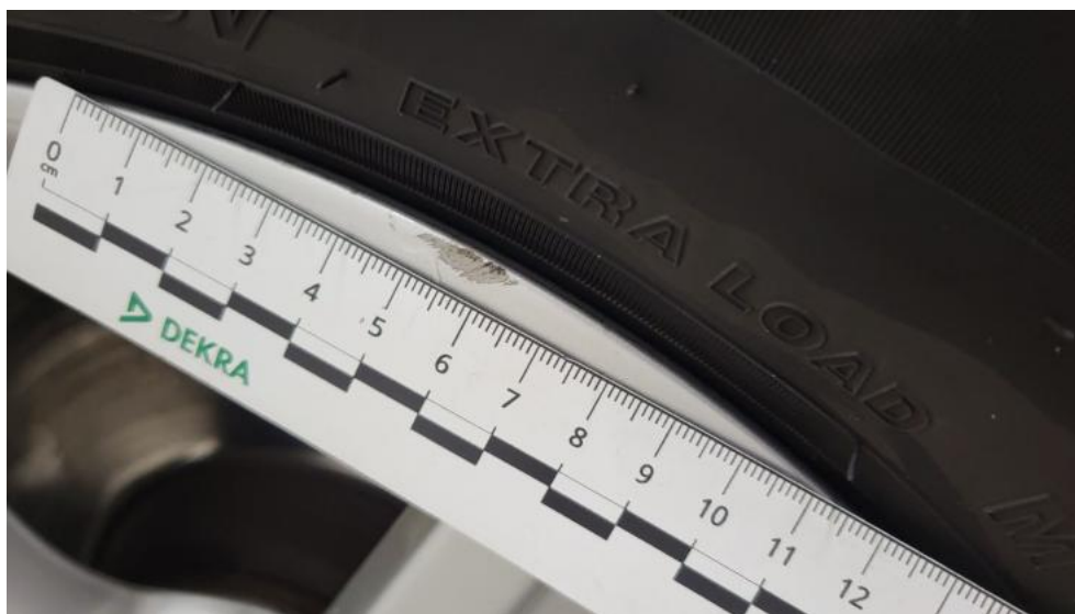
Photo 71. Felga Aluminiowa przednia L - Rysa/odprysk 1
