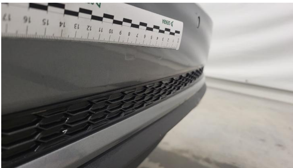
Photo 59. Zderzak tylny - Wgniecenie/odkształcenie 1
