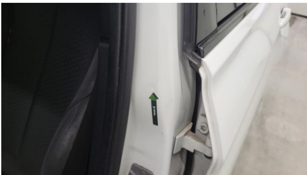
Photo 70. Słupek środkowy L - Wgniecenie/odkształcenie 1
