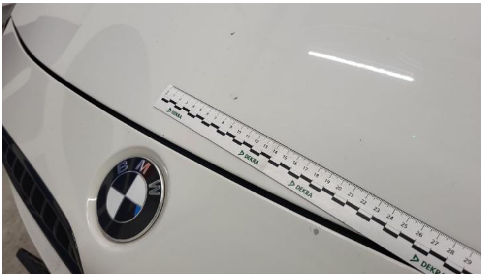
Photo 43. Pokrywa komory silnika - Rysa/odprysk 1
