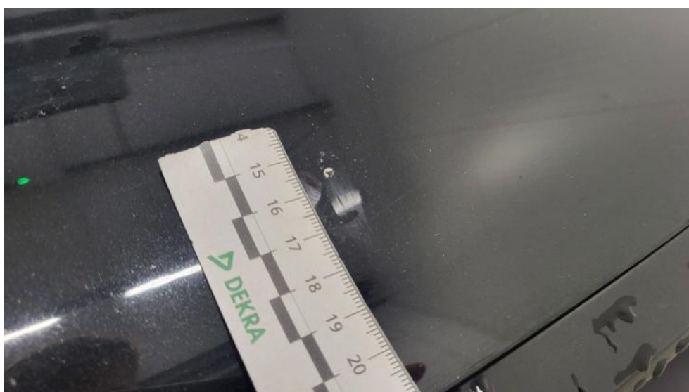
Fot. 50. Pokrywa komory silnika - Rysa/odprysk 1
