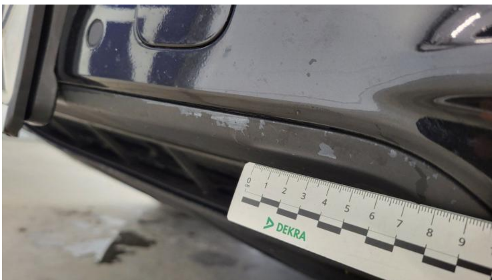
Fot. 52. Zderzak przedni cz dolna - Rysa/odprysk 1
