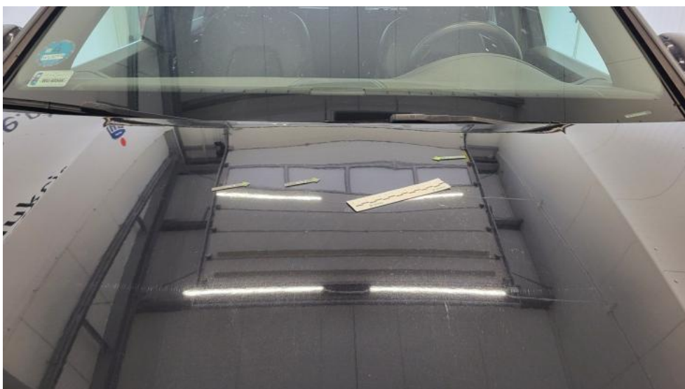
Fot. 44. Pokrywa komory silnika - Wgniecenie/odkształcenie 1
