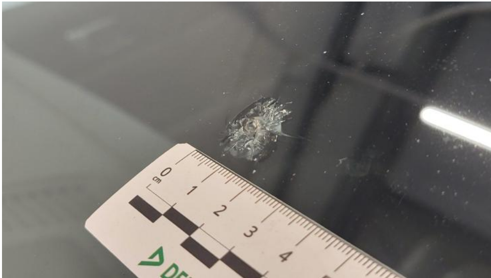
Fot. 47. Szyba czołowa - Pęknięcie/rozerwanie 1
