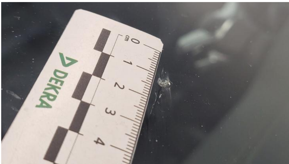
Fot. 48. Szyba czołowa - Pęknięcie/rozerwanie 2
