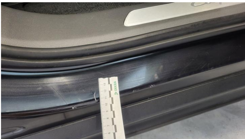
Fot. 62. Próg P - Rysa/odprysk 1
