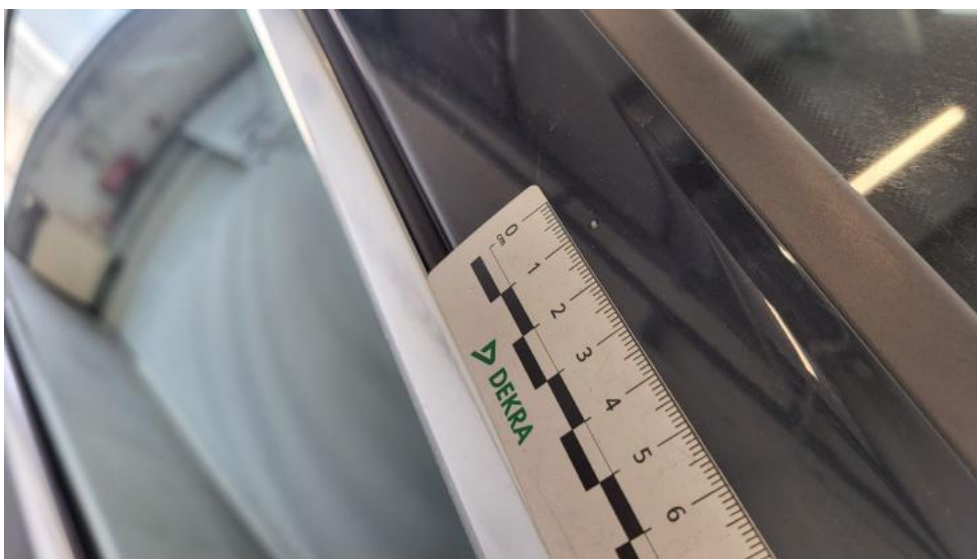
Fot. 47. Stupek przedni P - Rysa/odprysk 1
