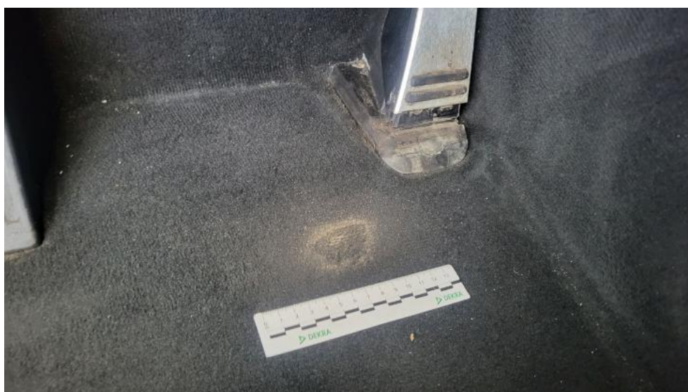
Fot. 72. Wykładzina podłogi - Rysa/odprysk 1
