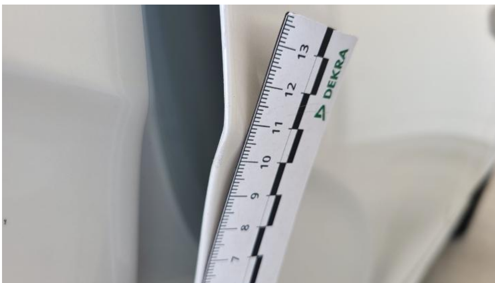
Fot. 48. Drzwi tylne P - Rysa/odprysk 1
