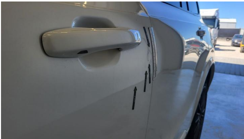
Fot. 59. Drzwi przed L - Wgniecenie/odkształcenie 1
