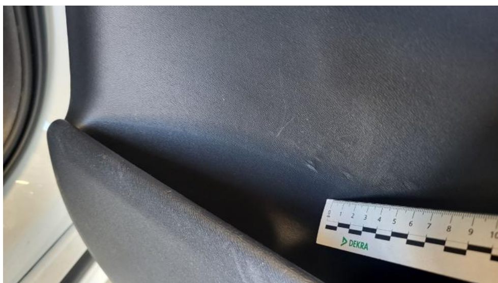
Fot. 70. Tapicerka drzwi tylnych P - Wgniecenie/odkształcenie 1
