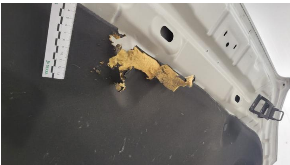
Fot. 44. Wykładzina pokrywy komory silnika - Pęknięcie/rozerwanie 1
