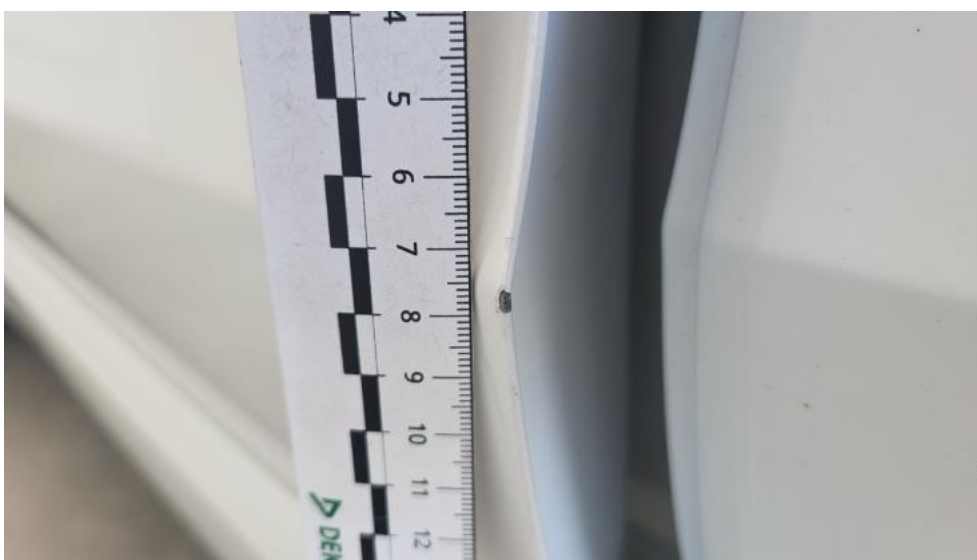
Fot. 58. Drzwi przed L - Rysa/odprysk 1
