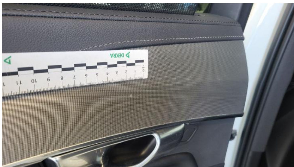
Fot. 68. Tapicerka drzwi tylnych L - Rysa/odprysk 1
