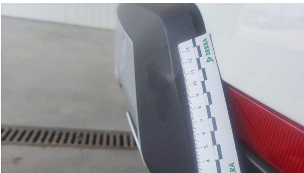
Photo 54. Zderzak tylny cz dolna - Wgniecenie/odkształcenie 1
