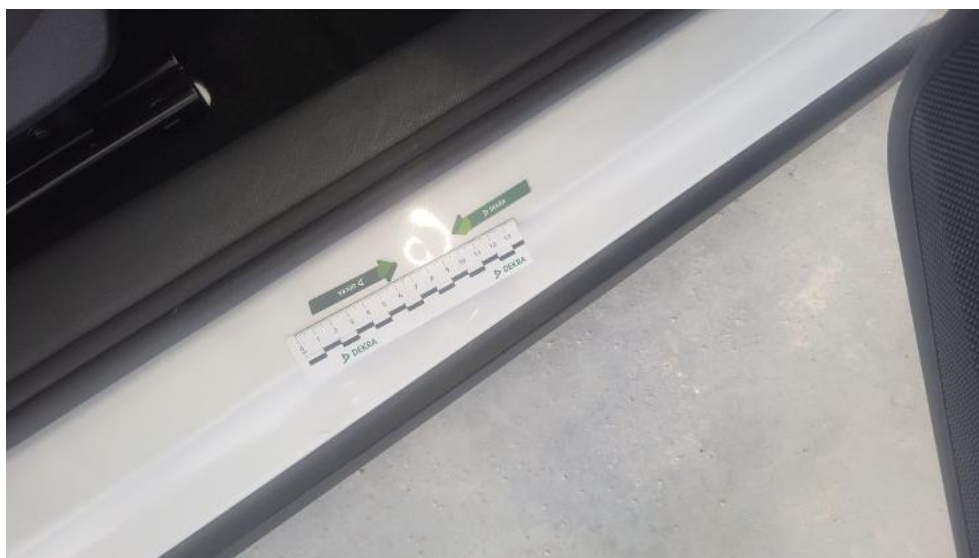
Photo 48. Próg P - Wgniecenie/odkształcenie 1
