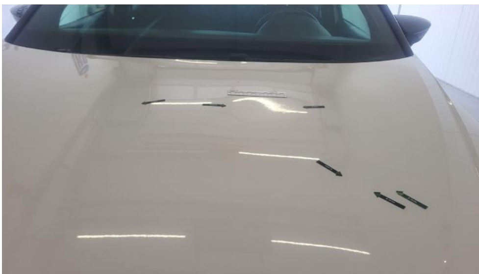
Photo 40. Pokrywa komory silnika - Wgniecenie/odkształcenie 1
