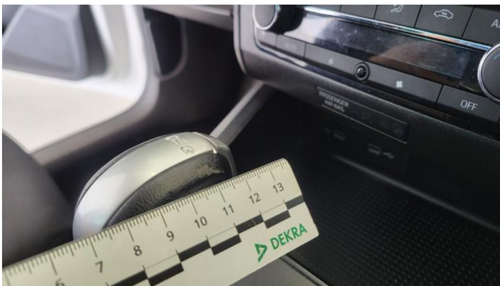
Photo 63. Gałka dźwigni zmiany biegów - Pęknięcie/rozerwanie 1
