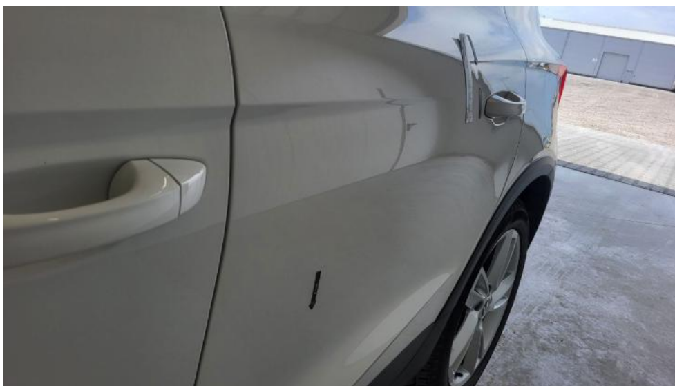
Photo 59. Drzwi tylne L - Wgniecenie/odkształcenie 1
