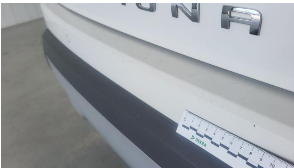
Photo 53. Zderzak tylny - Rysa/odprysk 1
