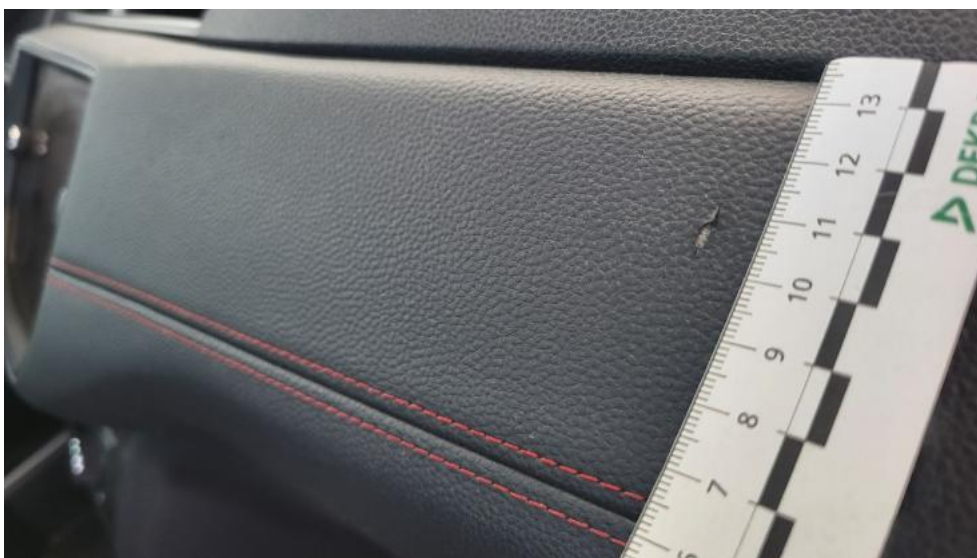
Photo 62. Deska rozdzielcza - Pęknięcie/rozerwanie 1
