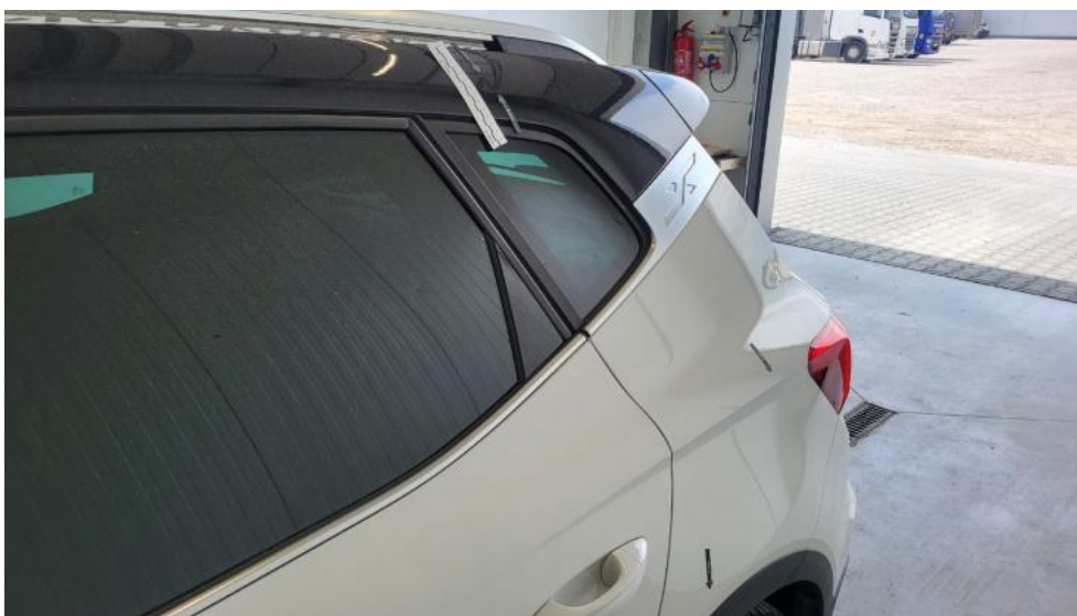
Photo 55. Błotnik tylny L / Ściana boczna L - Wgniecenie/odkształcenie 1
