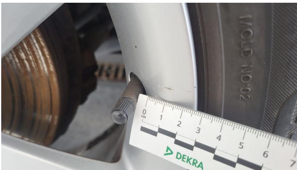
Photo 61. Felga Aluminiowa przednia L - Rysa/odprysk 1
