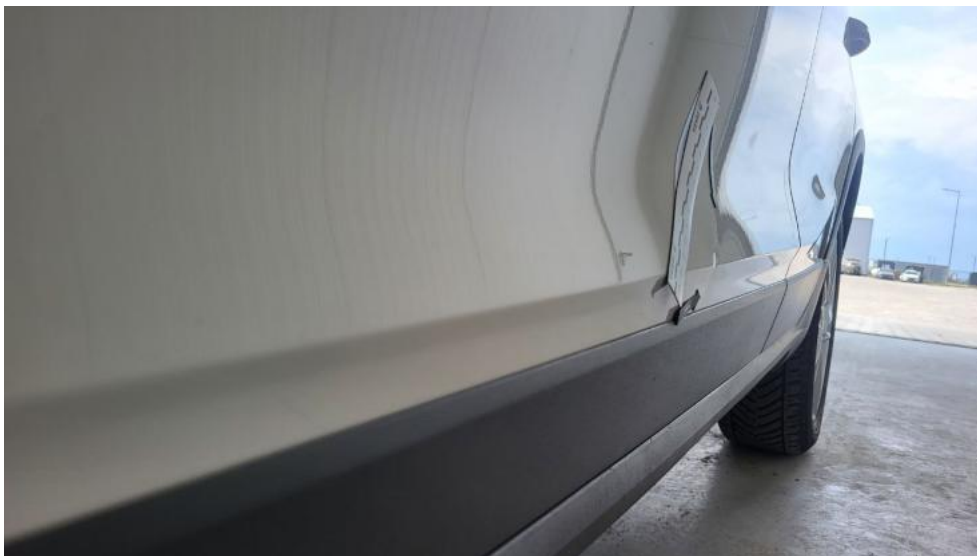
Photo 57. Drzwi przed L - Wgniecenie/odkształcenie 1
