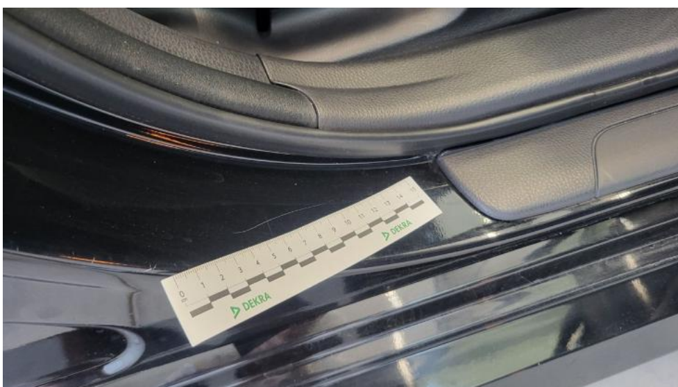
Fot. 48. Próg P - Rysa/odprysk 1
