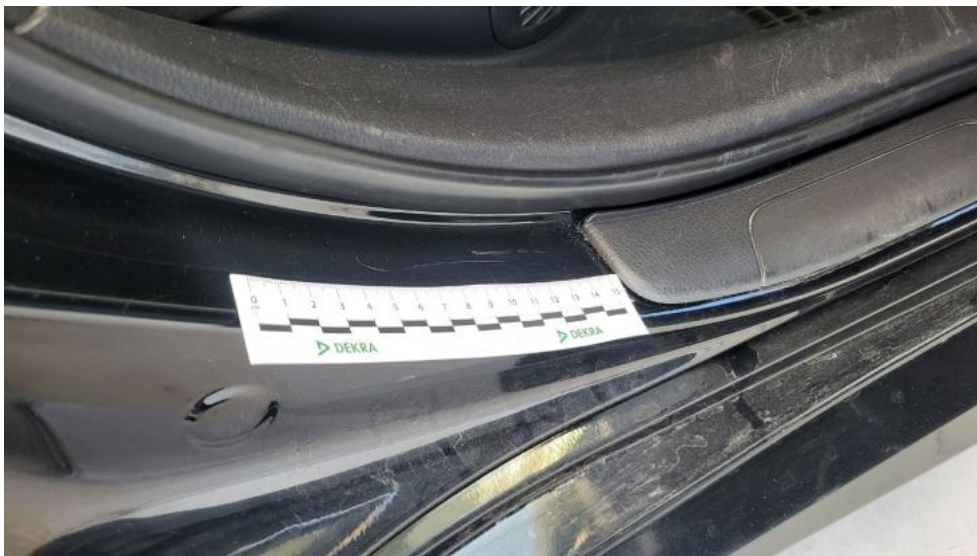
Fot. 49. Próg P - Rysa/odprysk 2
