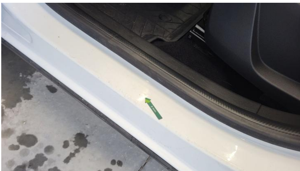
Fot. 53. Próg L - Wgniecenie/odkształcenie 1
