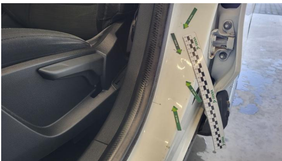
Fot. 54. Słupek środkowy L - Wgniecenie/odkształcenie 1
