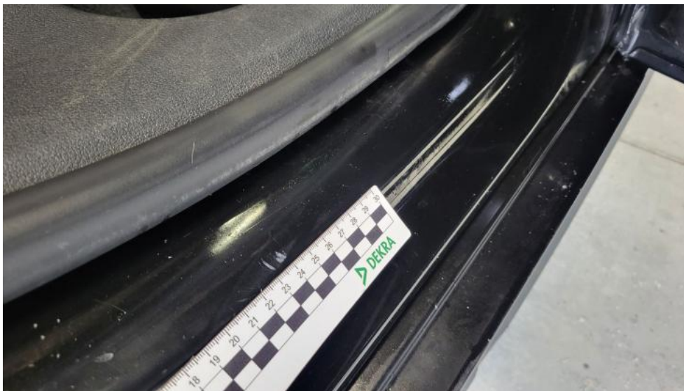
Fot. 57. Próg P - Rysa/odprysk 1
