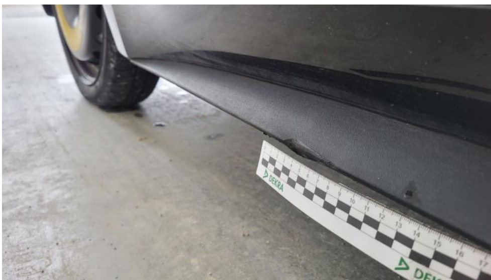
Fot. 58. Próg P - Wgniecenie/odkształcenie 1
