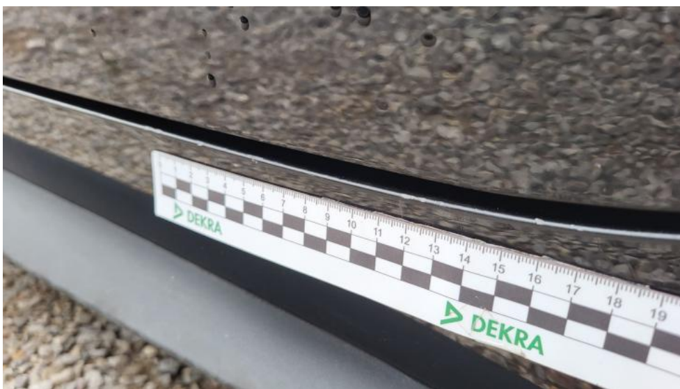
Fot. 79. Próg L - Rysa/odprysk 1
