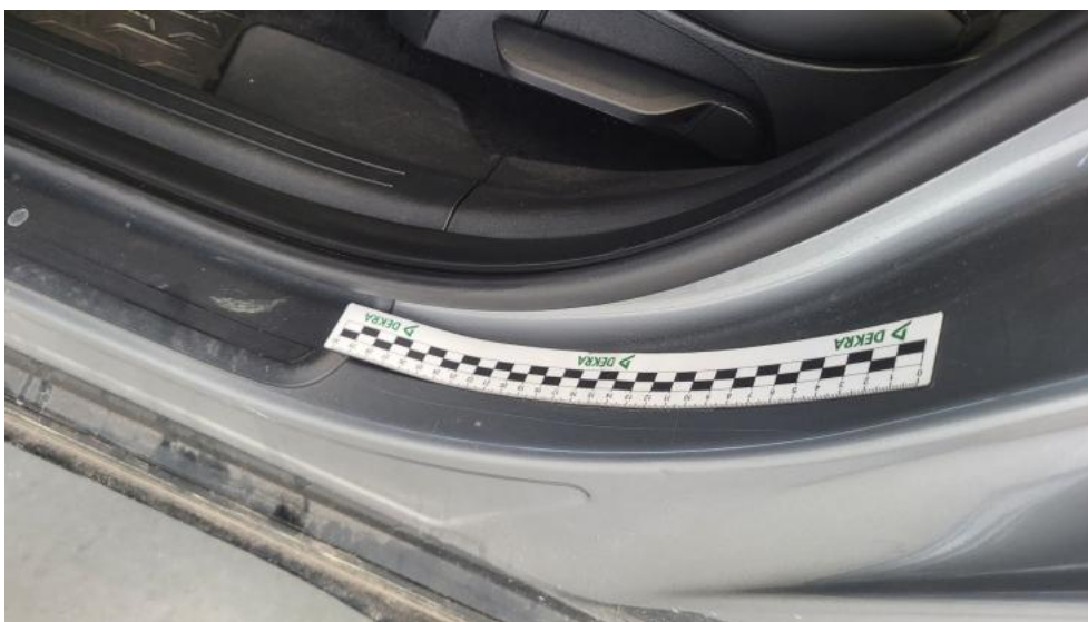
Fot. 65. Próg L - Rysa/odprysk 1
