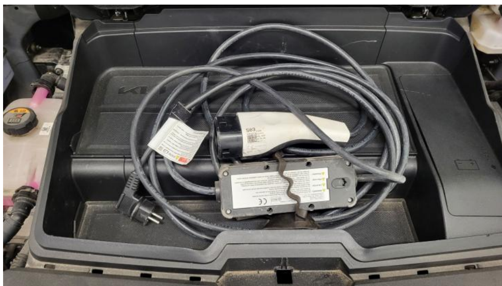
Fot. 36. Przewód ładowania baterii trakcyjnej
