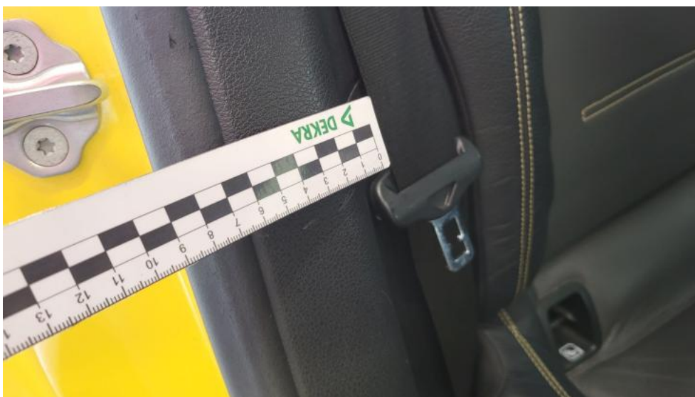
Photo 98. Wykładzina(y) słupka tylnego P - Rysa/odprysk 1
