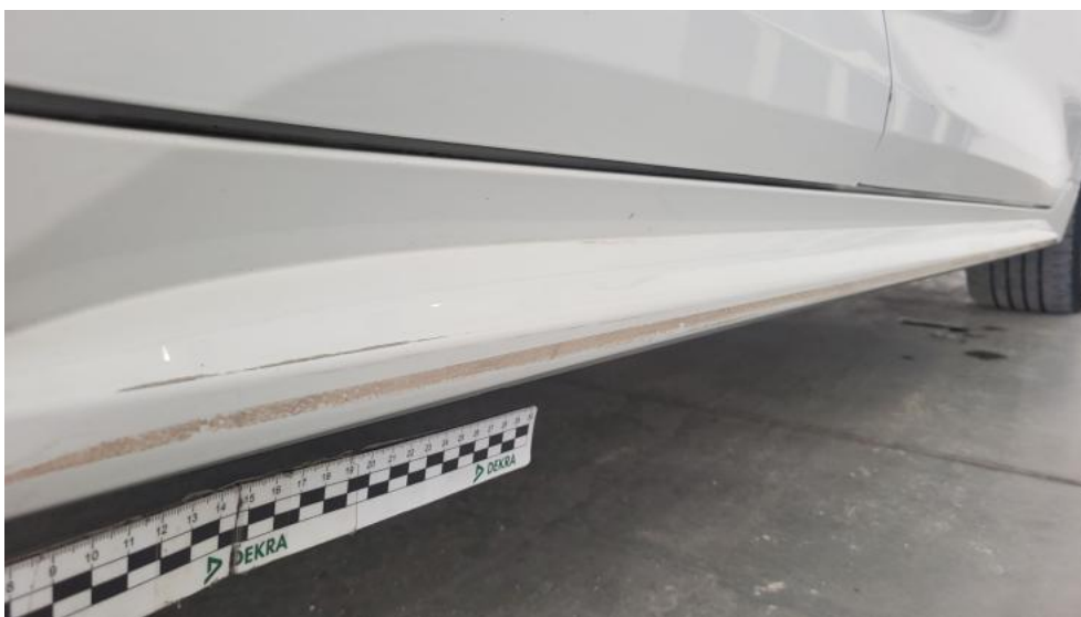
Photo 74. Próg P() - Rysa/odprysk 3
