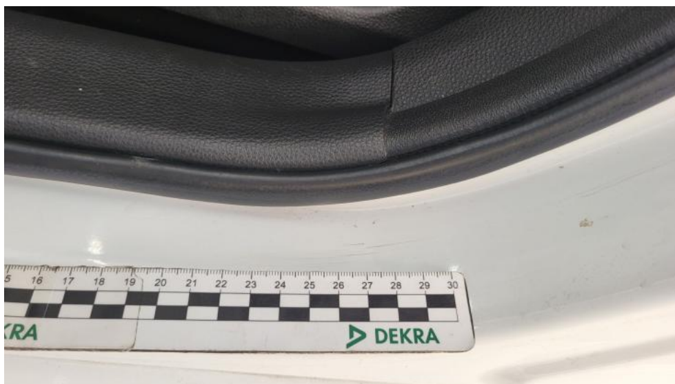
Photo 104. Próg L - Rysa/odprysk 2
