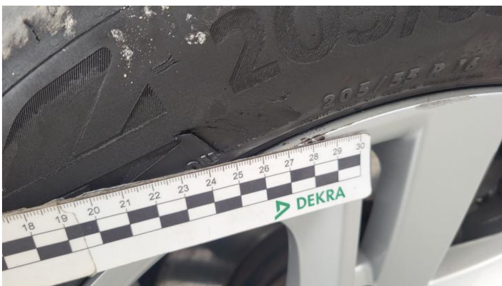
Photo 52. Opona przednia P - Pęknięcie/rozerwanie 1
