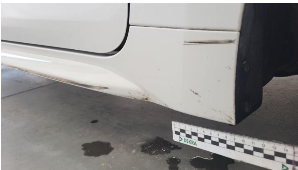
Photo 72. Próg P - Rysa/odprysk 1
