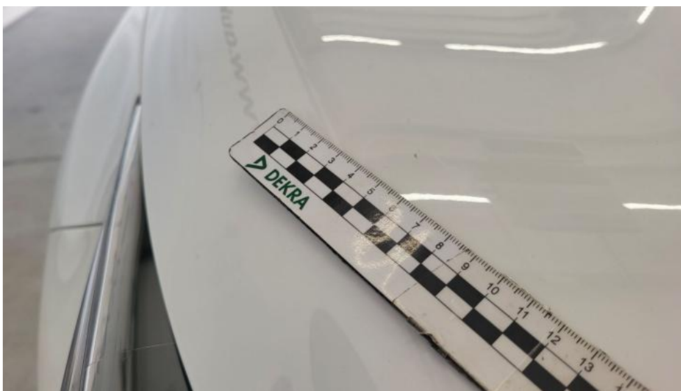
Photo 43. Pokrywa komory silnika - Rysa/odprysk 1
