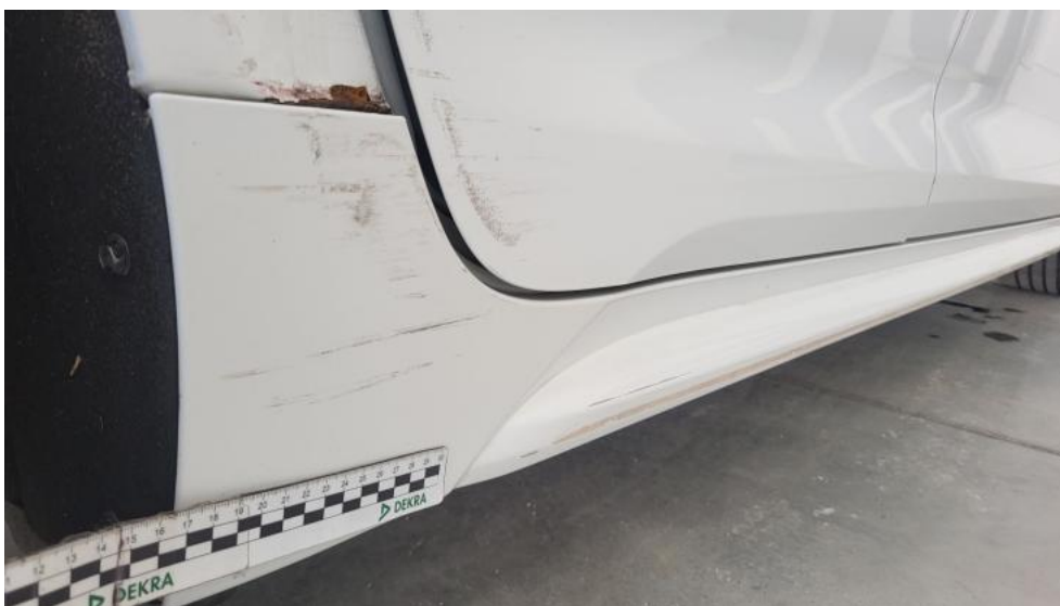
Photo 73. Próg P - Rysa/odprysk 2
