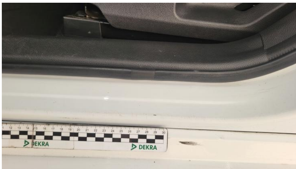
Photo 103. Próg L - Rysa/odprysk 1
