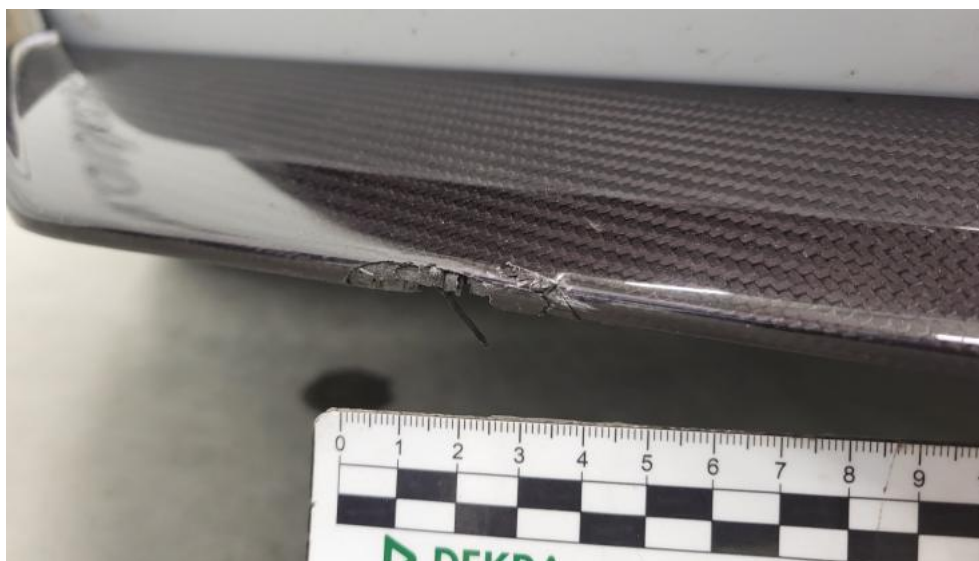
Photo 75. Spoiler zderzaka przedniego() - Pęknięcie/rozerwanie 3
