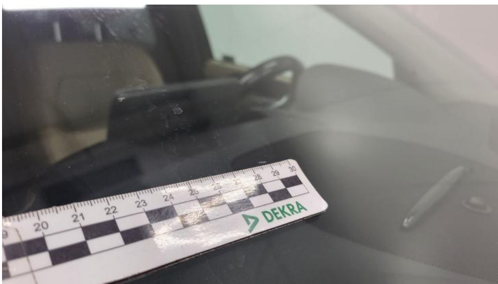
Fot. 40. Szyba czołowa - Rysa/odprysk 1
