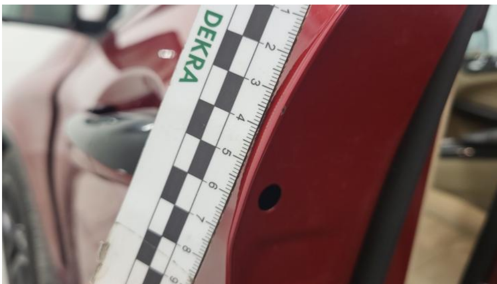
Fot. 69. Drzwi przed L - Rysa/odprysk 1
