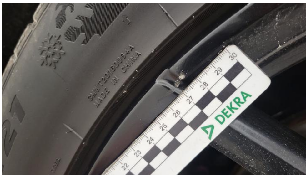
Fot. 67. Felga aluminiowa tylna L - Rysa/odprysk 1
