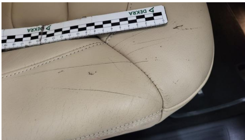
Fot. 85. Kanapa tyl. - Rysa/odprysk 1
