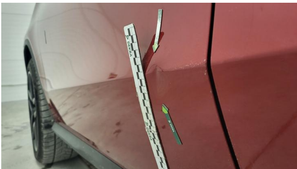
Fot. 70. Drzwi przed L - Wgniecenie/odkształcenie 1
