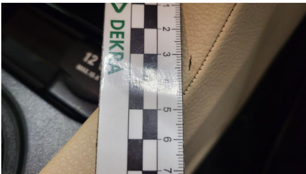
Fot. 80. Konsola tunelu śr. - Pęknięcie/rozerwanie 1
