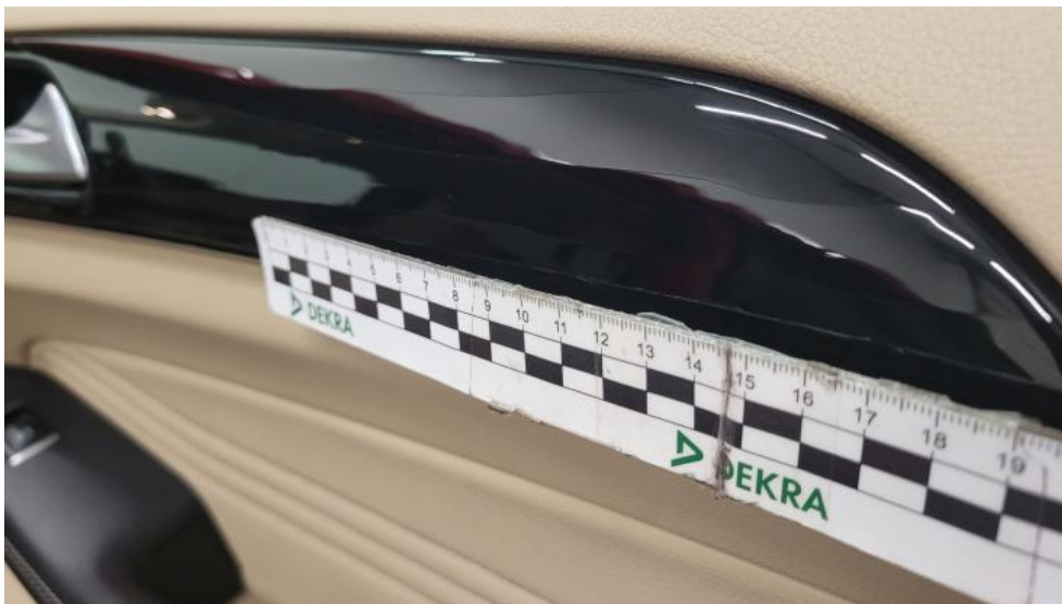
Fot. 93. Tapicerka drzwi przednich P - Pęknięcie/rozerwanie 1
