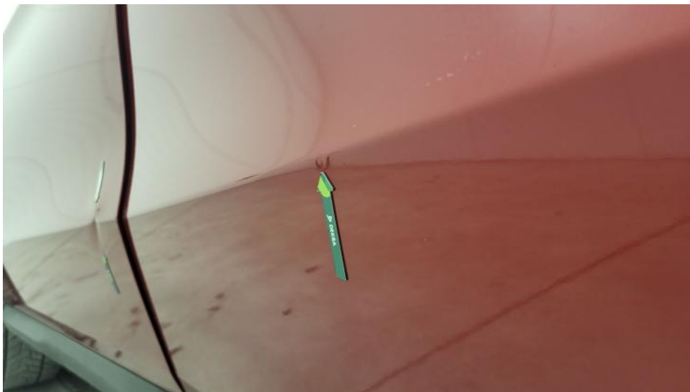
Fot. 73. Drzwi tylne L - Wgniecenie/odkształcenie 1
