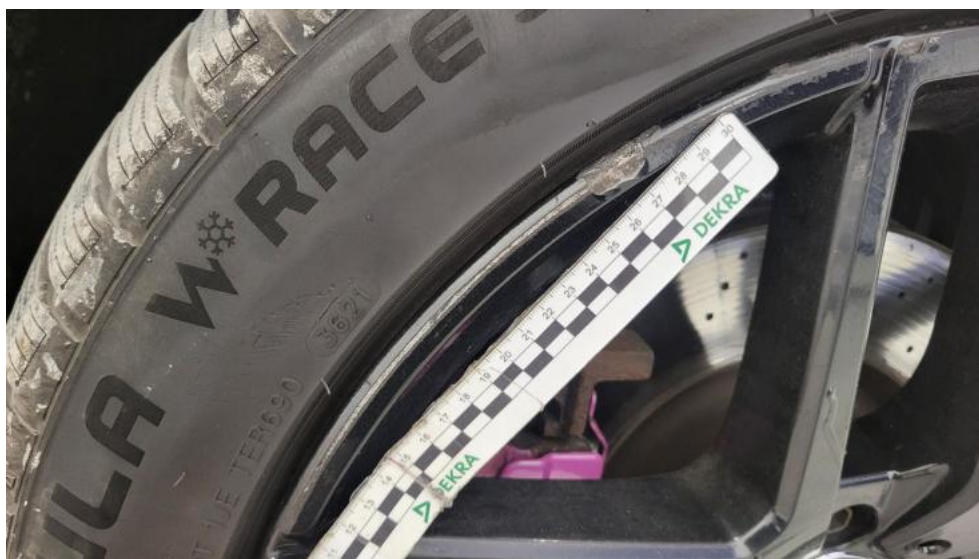
Fot. 45. Felga aluminiowa przednia P - Rysa/odprysk 1
