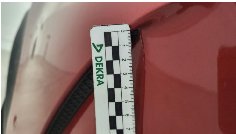
Fot. 62. Zderzak tylny - Pęknięcie/rozerwanie 1
