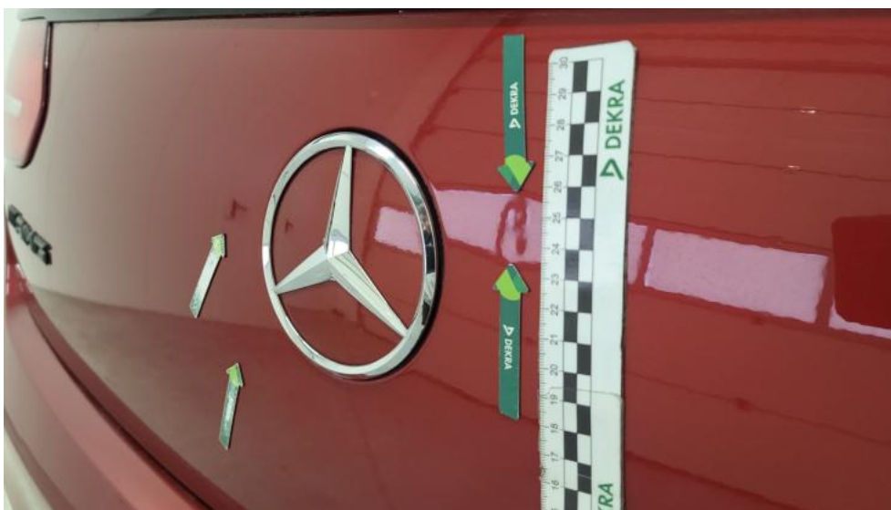
Fot. 57. Pokrywy bagażnika - Wgniecenie/odkształcenie 1
