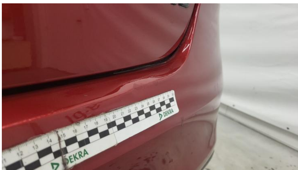
Fot. 60. Zderzak tylny - Wgniecenie/odkształcenie 1
