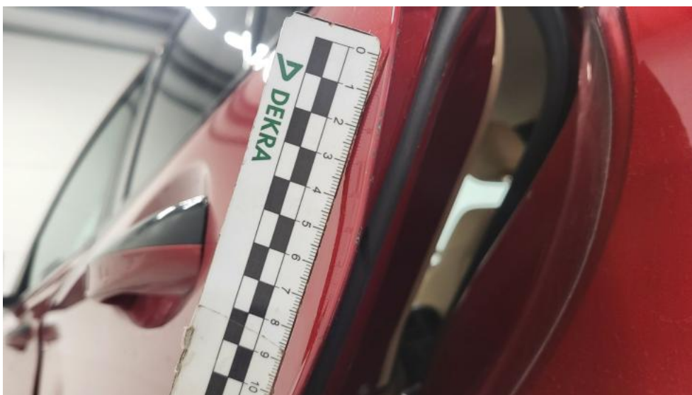
Fot. 72. Drzwi tylne L - Rysa/odprysk 1
