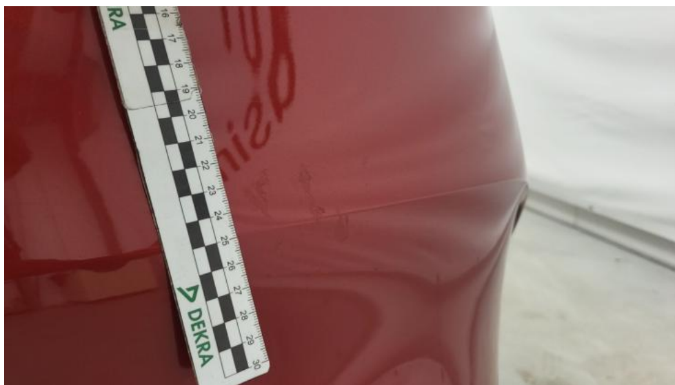
Fot. 59. Zderzak tylny - Rysa/odprysk 2
