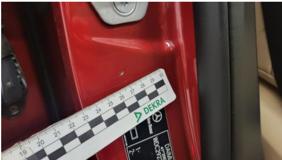
Fot. 55. Stupek środkowy P - Rysa/odprysk 1
