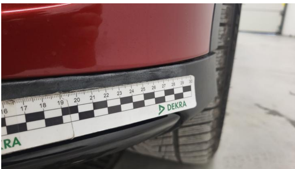
Fot. 44. Zderzak przedni cz dolna - Rysa/odprysk 1
