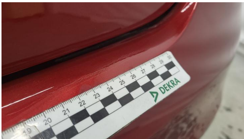
Fot. 63. Zderzak tylny - Pęknięcie/rozerwanie 2
