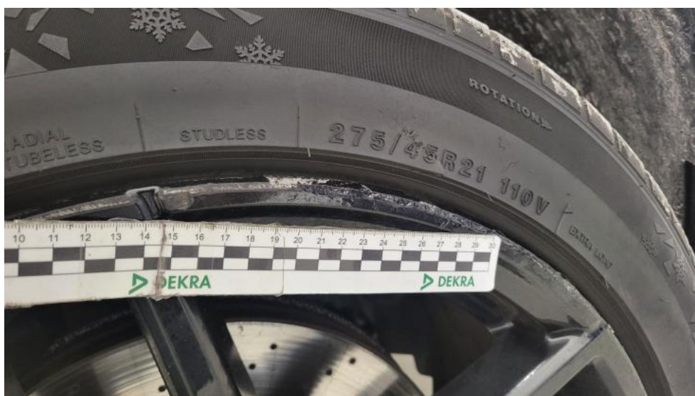
Fot. 46. Felga aluminiowa przednia P - Rysa/odprysk 2
