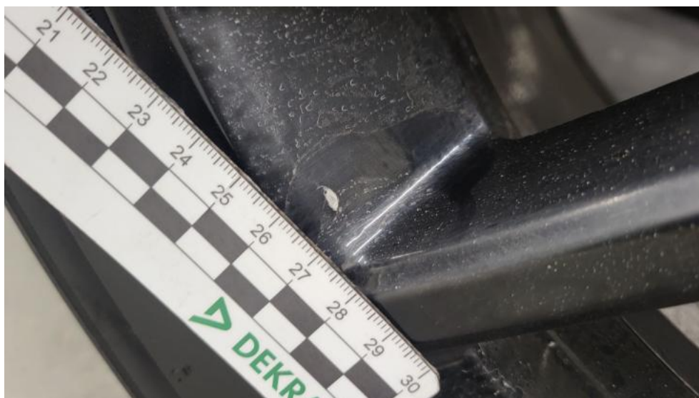
Fot. 68. Felga aluminiowa tylna L - Rysa/odprysk 2
