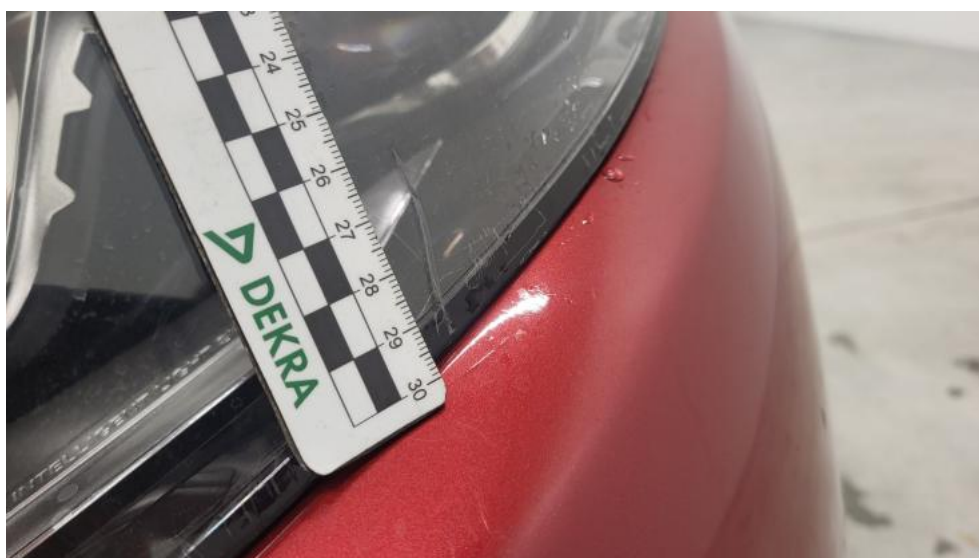
Fot. 78. Reflektor L() - Pęknięcie/rozerwanie 3
