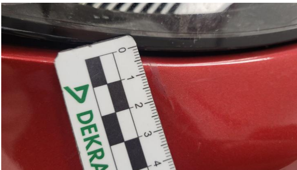
Fot. 42. Zderzak - Pęknięcie/rozerwanie 1
