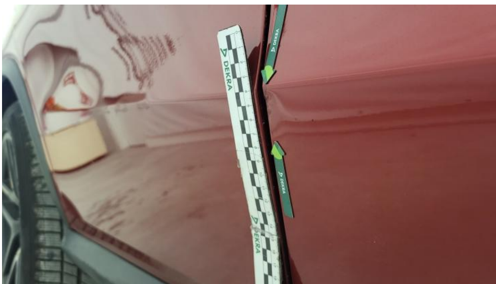
Fot. 49. Drzwi przednie P - Wgniecenie/odkształcenie 1
