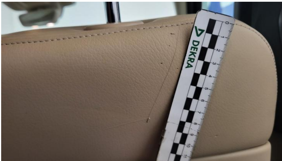
Fot. 83. Fotel prz. praw. - Pęknięcie/rozerwanie 1
