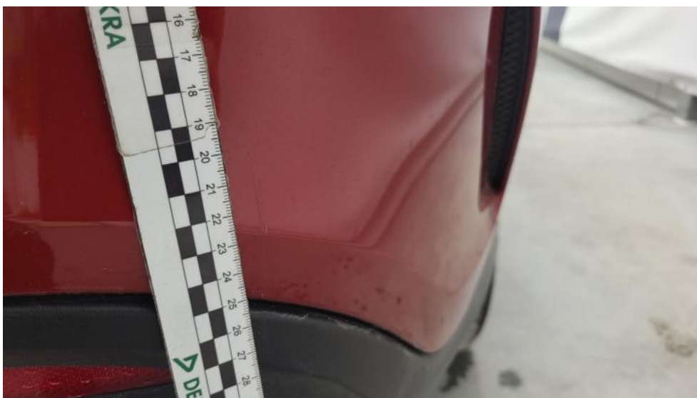
Fot. 58. Zderzak tylny - Rysa/odprysk 1
