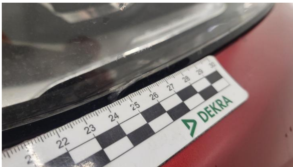
Fot. 77. Reflektor L - Pęknięcie/rozerwanie 2
