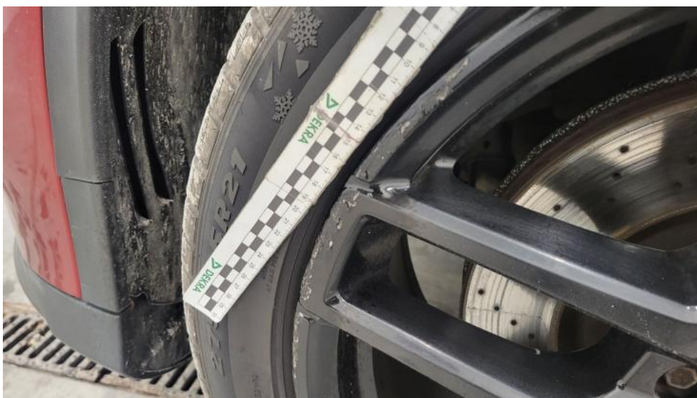
Fot. 74. Felga Aluminiowa przednia L - Rysa/odprysk 1
