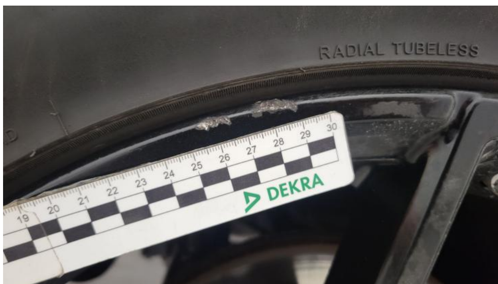
Fot. 56. Felga aluminiowa tylna P - Rysa/odprysk 1
