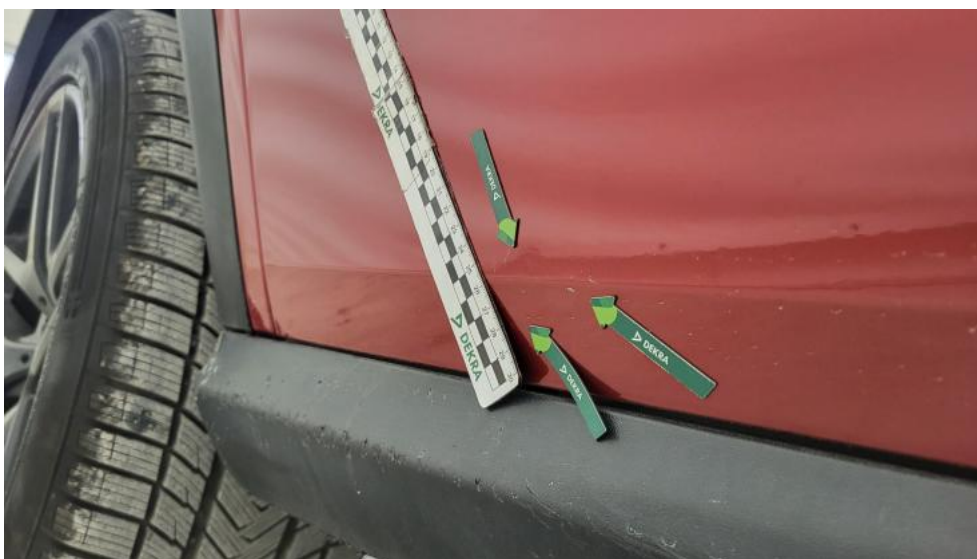
Fot. 53. Drzwi tylne P - Wgniecenie/odkształcenie 1
