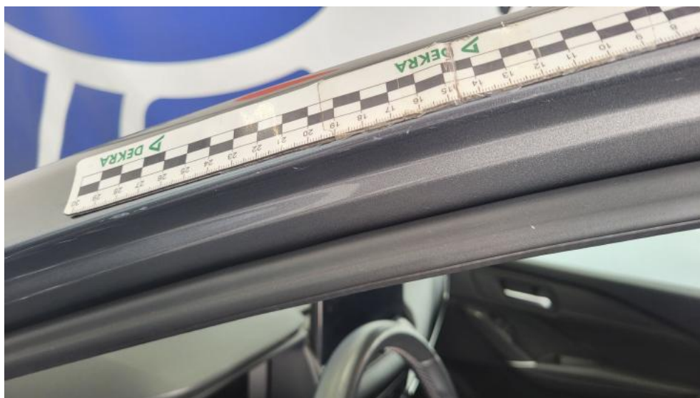
Fot. 63. Stupek przedni L - Rysa/odprysk 1
