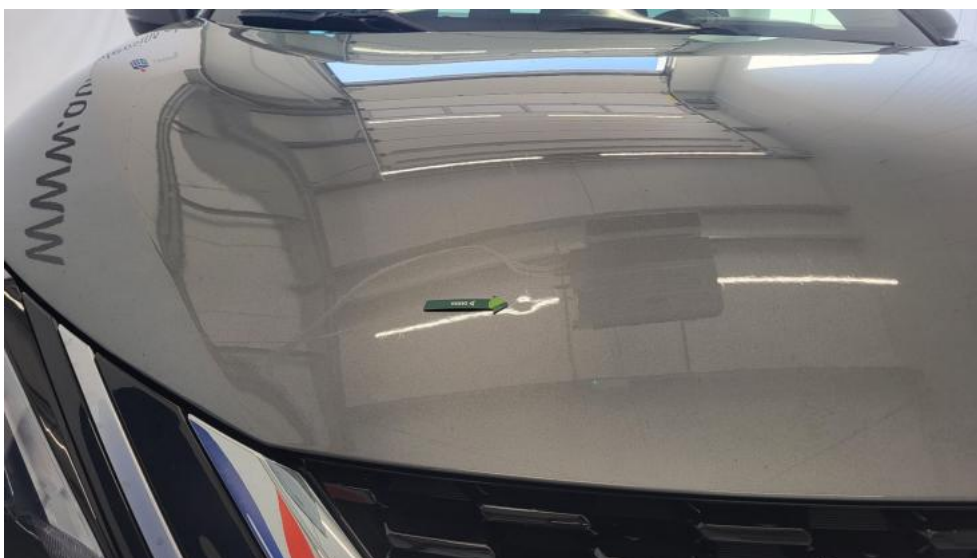
Fot. 42. Pokrywa komory silnika - Wgniecenie/odkształcenie 1
