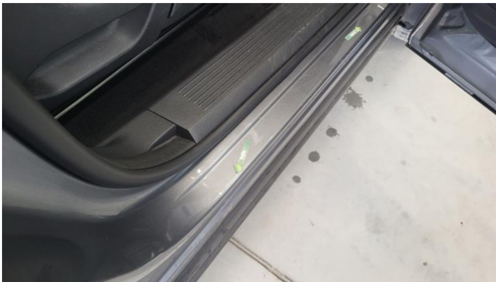
Fot. 53. Próg P - Wgniecenie/odkształcenie 1
