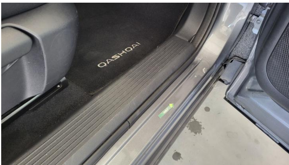
Fot. 54. Próg P - Wgniecenie/odkształcenie 2
