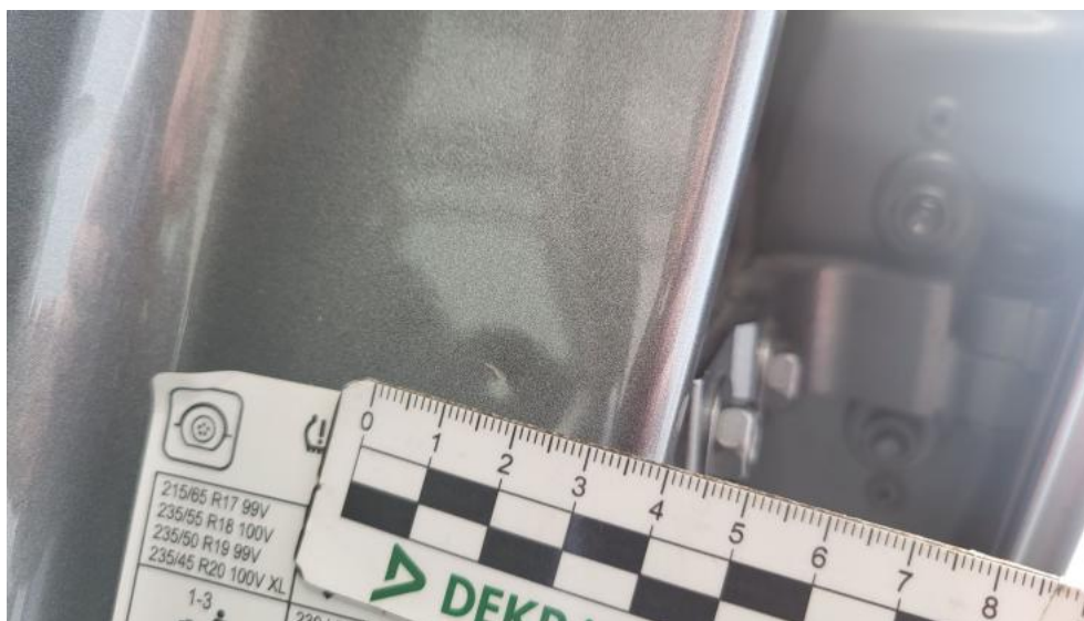
Fot. 65. Słupek środkowy L - Rysa/odprysk 1
