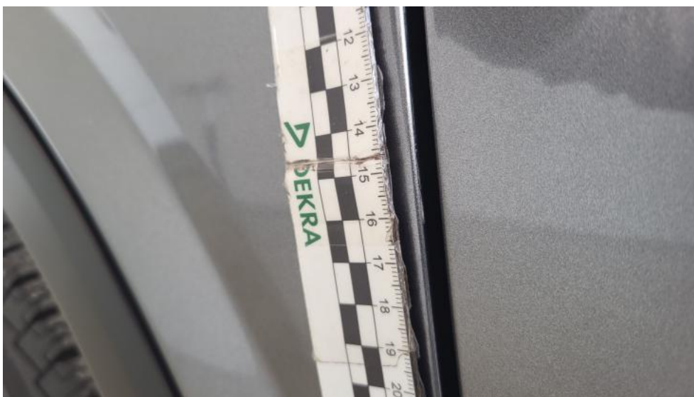
Fot. 67. Błotnik przedni L - Rysa/odprysk 1
