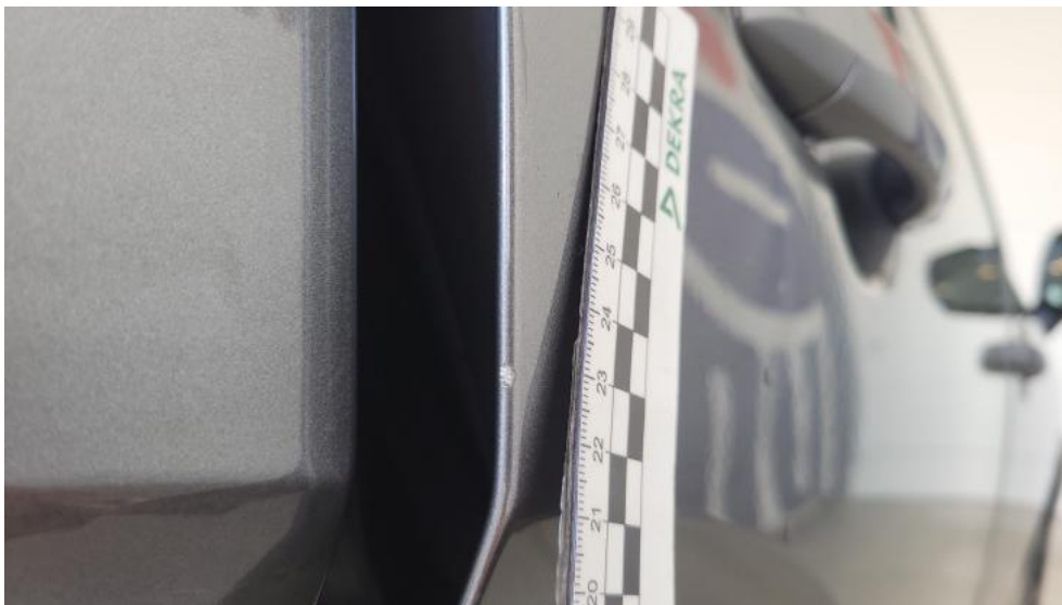
Fot. 51. Drzwi tylne P - Rysa/odprysk 1
