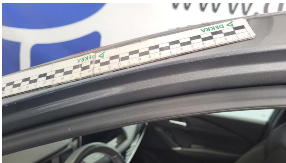
Fot. 64. Stupek przedni L - Rysa/odprysk 2
