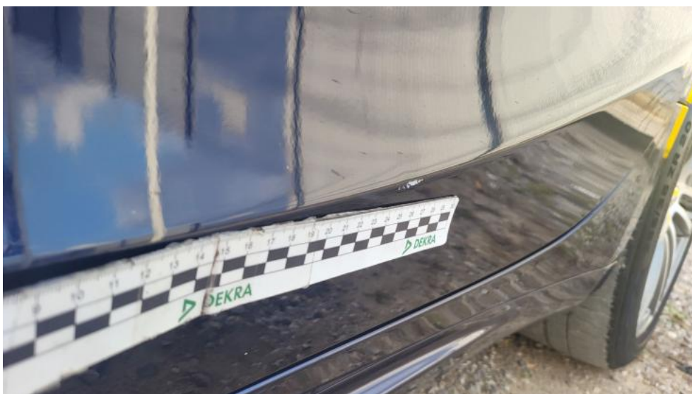
Photo 70. Drzwi tylne L() - Wgniecenie/odkształcenie 3
