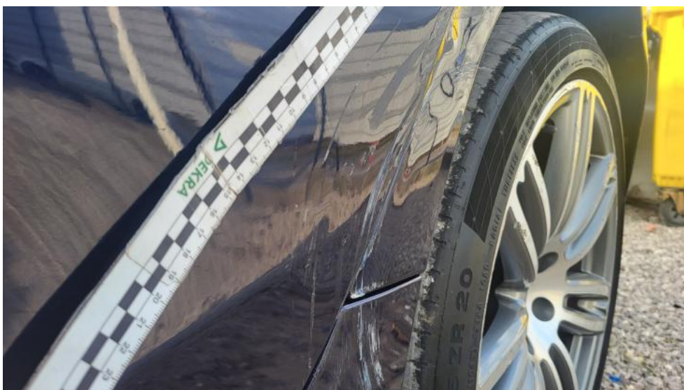
Photo 68. Drzwi tylne L - Wgniecenie/odkształcenie 1
