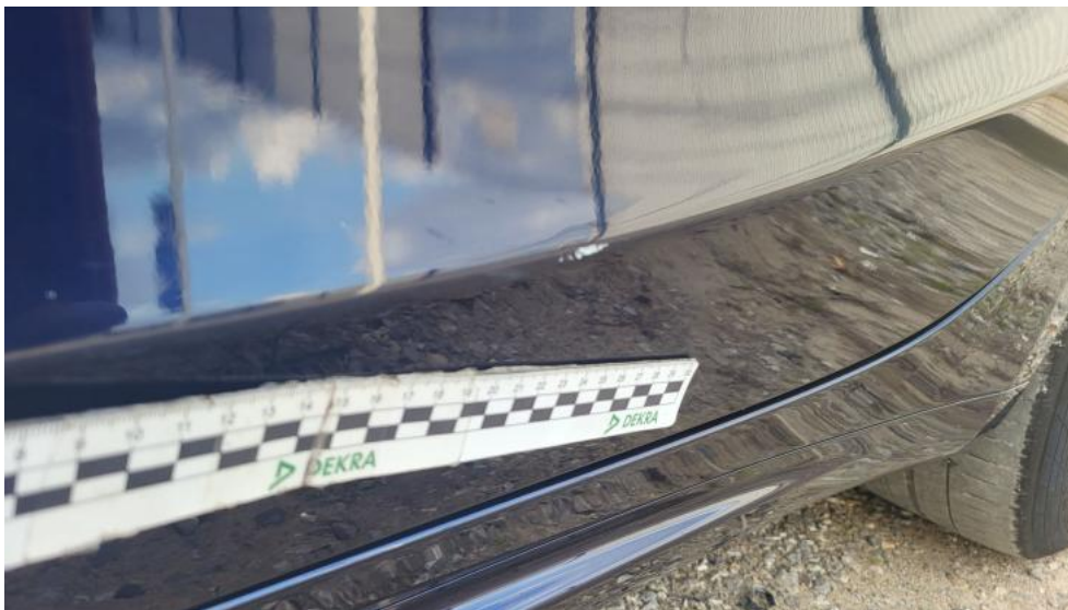
Photo 67. Drzwi tylne L() - Rysa/odprysk 3
