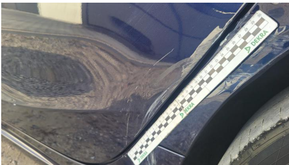
Photo 65. Drzwi tylne L - Rysa/odprysk 1
