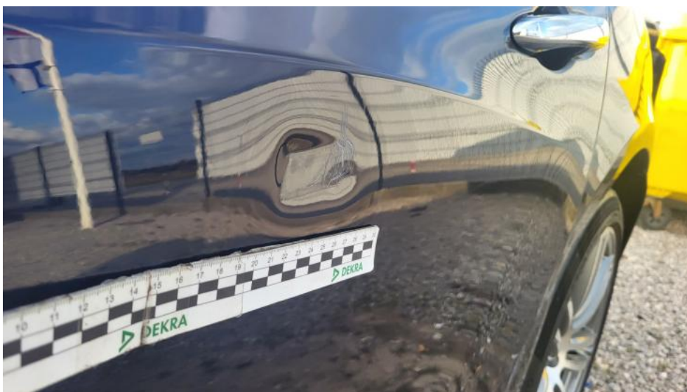
Photo 69. Drzwi tylne L - Wgniecenie/odkształcenie 2
