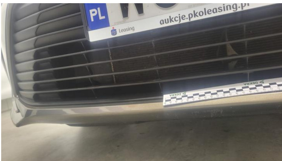
Fot. 42. Zderzak - Rysa/odprysk 2
