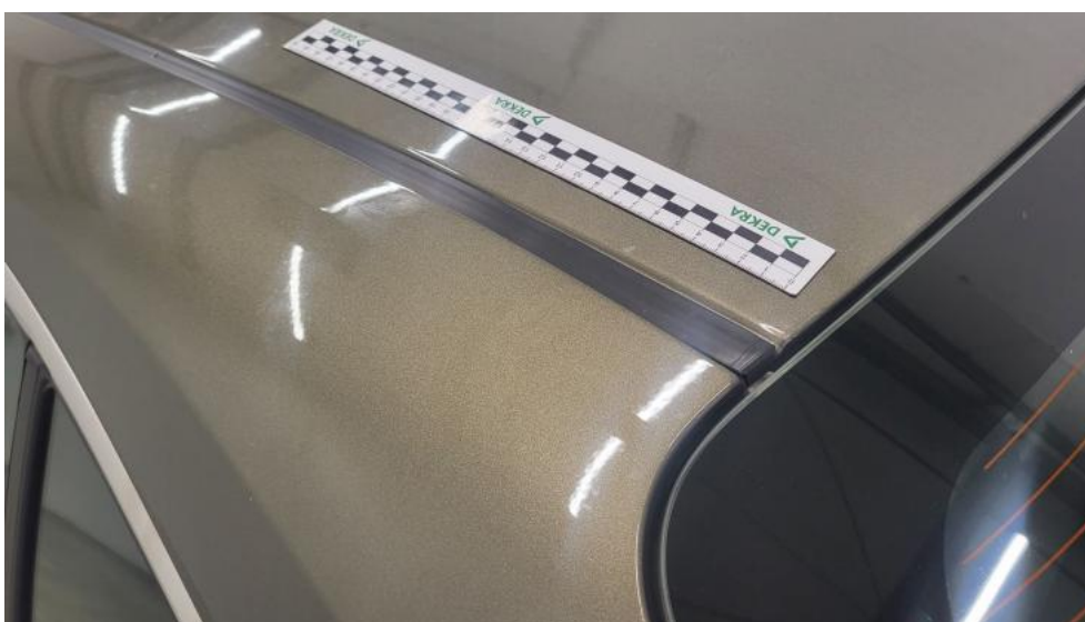
Fot. 46. Dach - Rysa/odprysk 1
