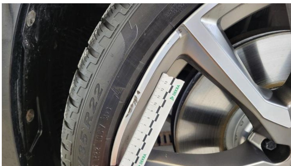
Felga Aluminiowa przednia L - Wgniecenie/odkształcenie 1
