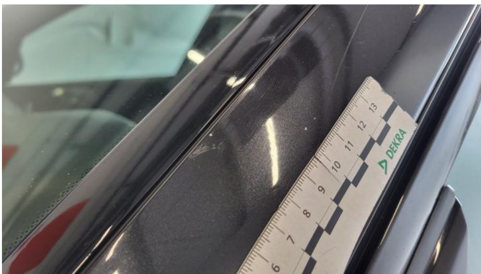
Photo 86. Słupek przedni L - Rysa/odprysk 1
