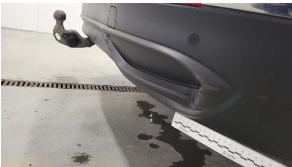
Fot. 74. Zderzak tylny cz dolna - Wgniecenie/odkształcenie 1
