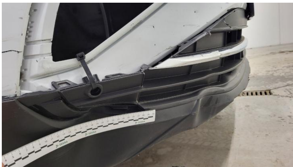
Fot. 42. Krata zderzaka prz. - Wgniecenie/odkształcenie 1
