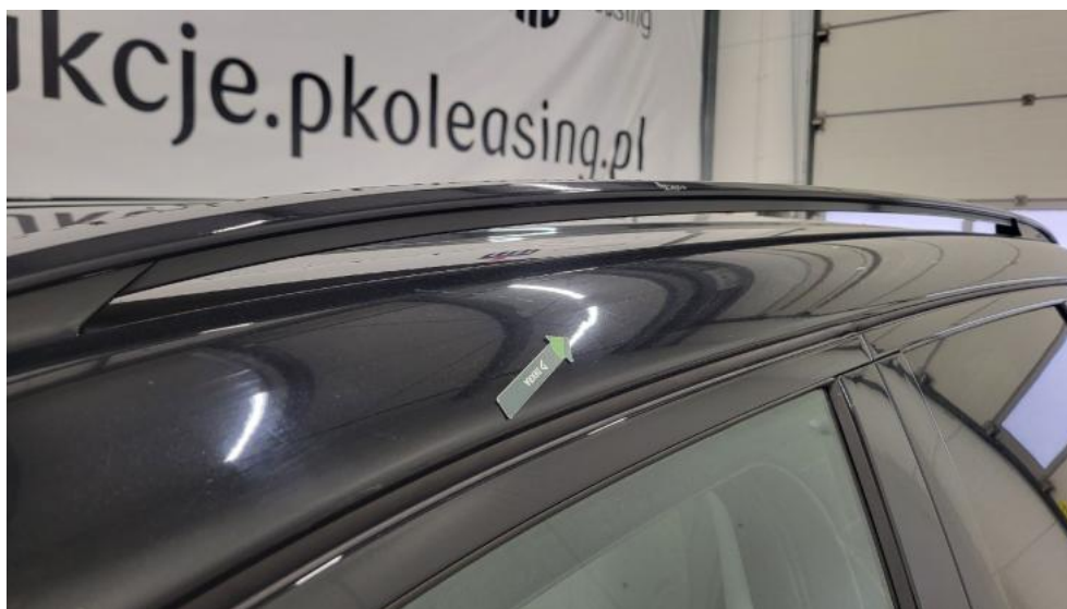
Photo 59. Stupek przedni L - Wgniecenie/odkształcenie 1
