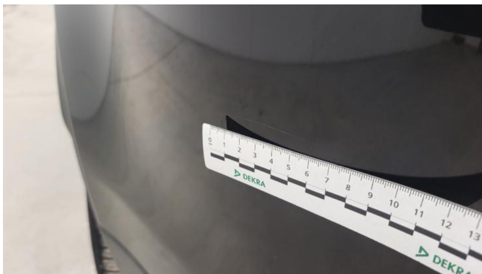
Photo 46. Zderzak tylny - Rysa/odprysk 1
