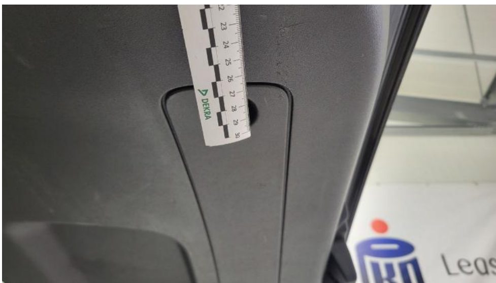
Photo 68. Wykładzina pokrywy tylnej - Rysa/odprysk 1
