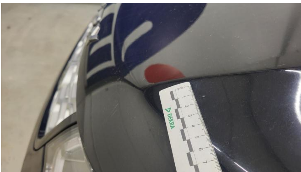
Photo 38. Pokrywa komory silnika - Rysa/odprysk 1
