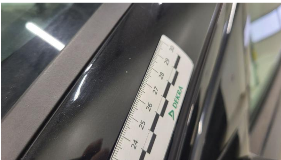
Photo 58. Słupek przedni L - Rysa/odprysk 1
