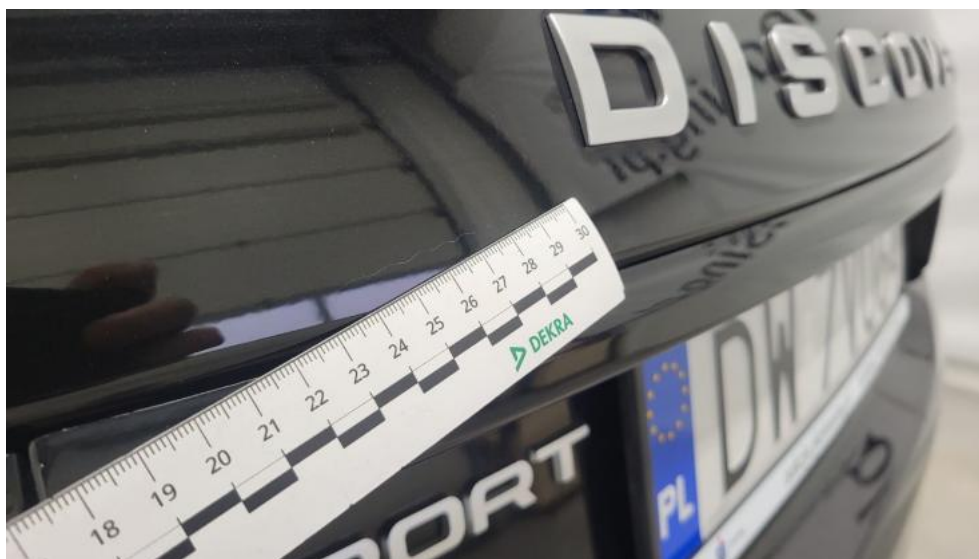
Photo 45. Pokrywy bagażnika - Rysa/odprysk 1
