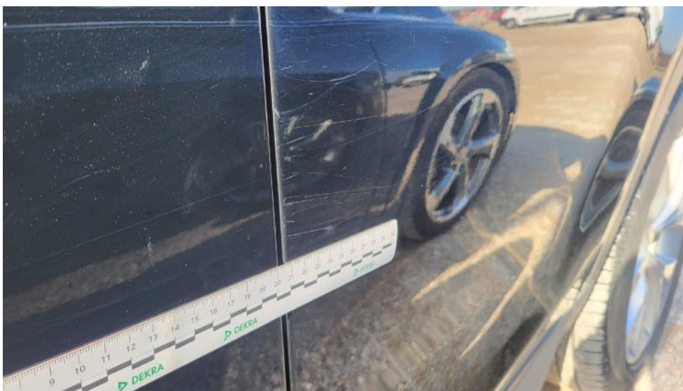
Photo 57. Drzwi tylne L - Rysa/odprysk 1
