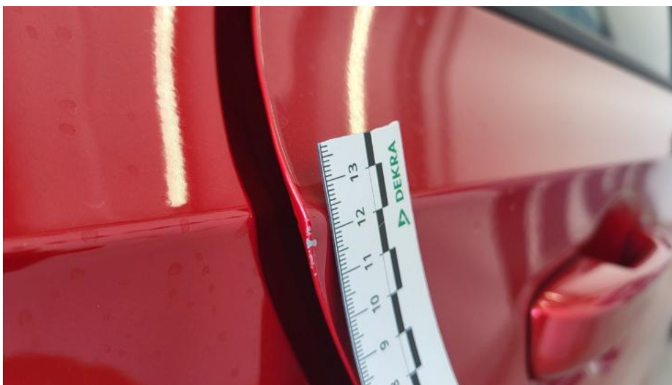
Photo 43. Drzwi tylne P - Rysa/odprysk 1
