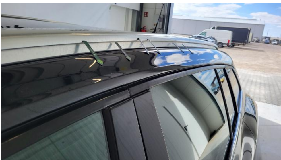
Photo 70. Błotnik tylny L / Ściana boczna L - Wgniecenie/odkształcenie 1
