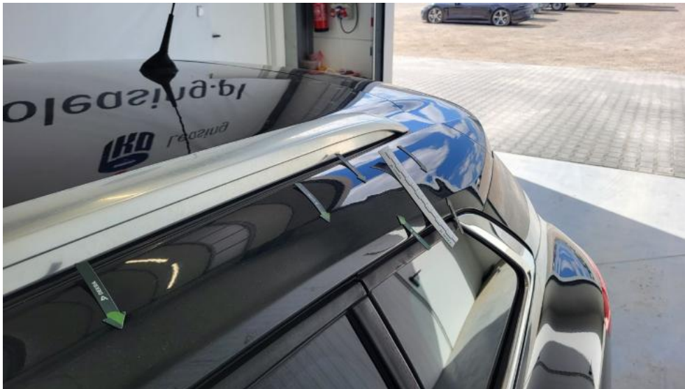
Photo 71. Błotnik tylny L / Ściana boczna L - Wgniecenie/odkształcenie 2
