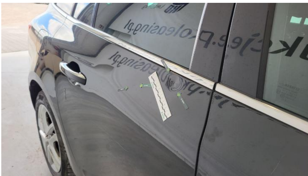
Photo 55. Drzwi tylne P - Wgniecenie/odkształcenie 1
