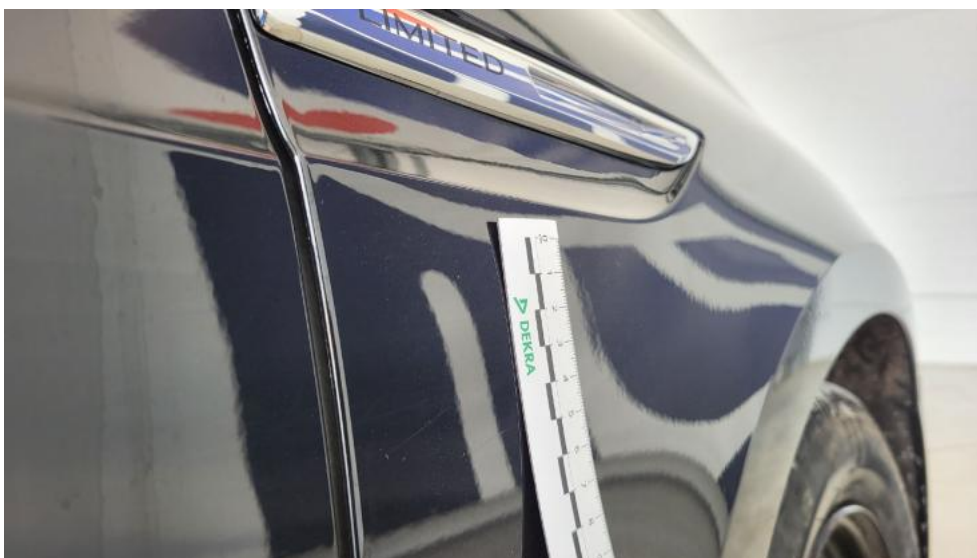
Photo 46. Błotnik przedni P - Wgniecenie/odkształcenie 1
