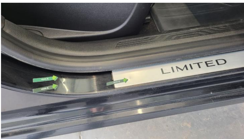
Photo 56. Próg P - Wgniecenie/odkształcenie 1
