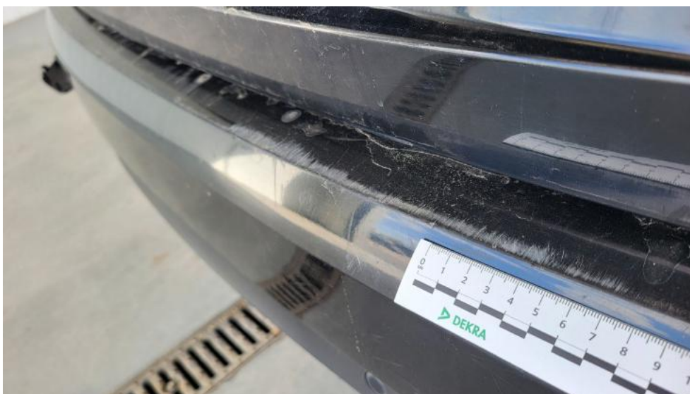
Photo 65. Zderzak tylny - Rysa/odprysk 1
