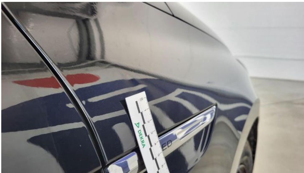
Photo 47. Błotnik przedni P - Wgniecenie/odkształcenie 2
