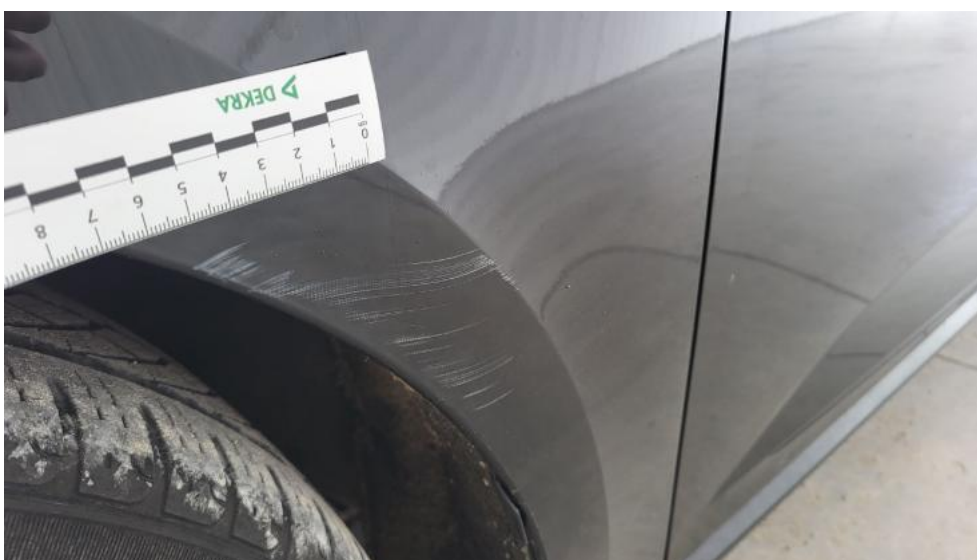
Photo 84. Błotnik przedni L - Rysa/odprysk 1
