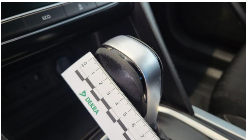
Photo 86. Gałka dźwigni zmiany biegów - Rysa/odprysk 1
