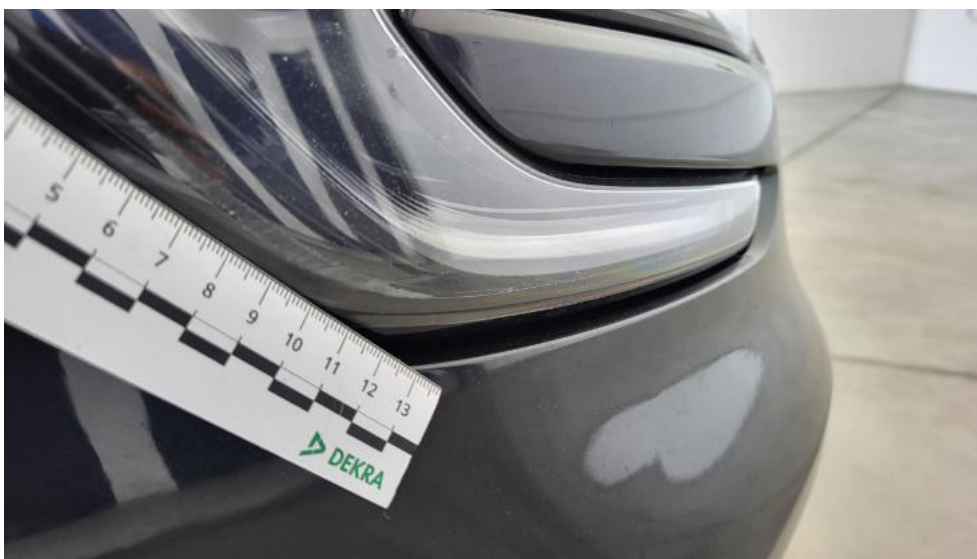
Photo 49. Reflektor P - Rysa/odprysk 1
