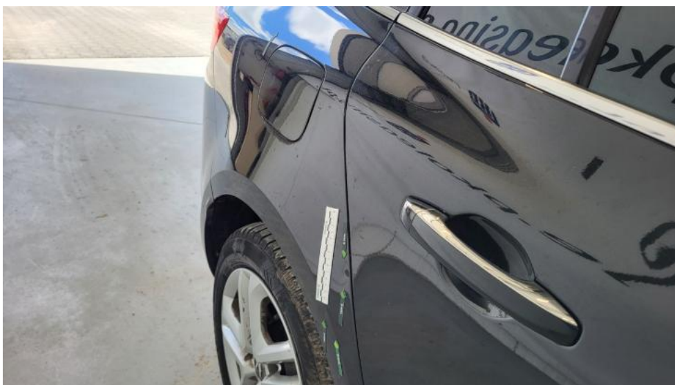
Photo 58. Błotnik tylny P / Ściana boczna P - Wgniecenie/odkształcenie 2
