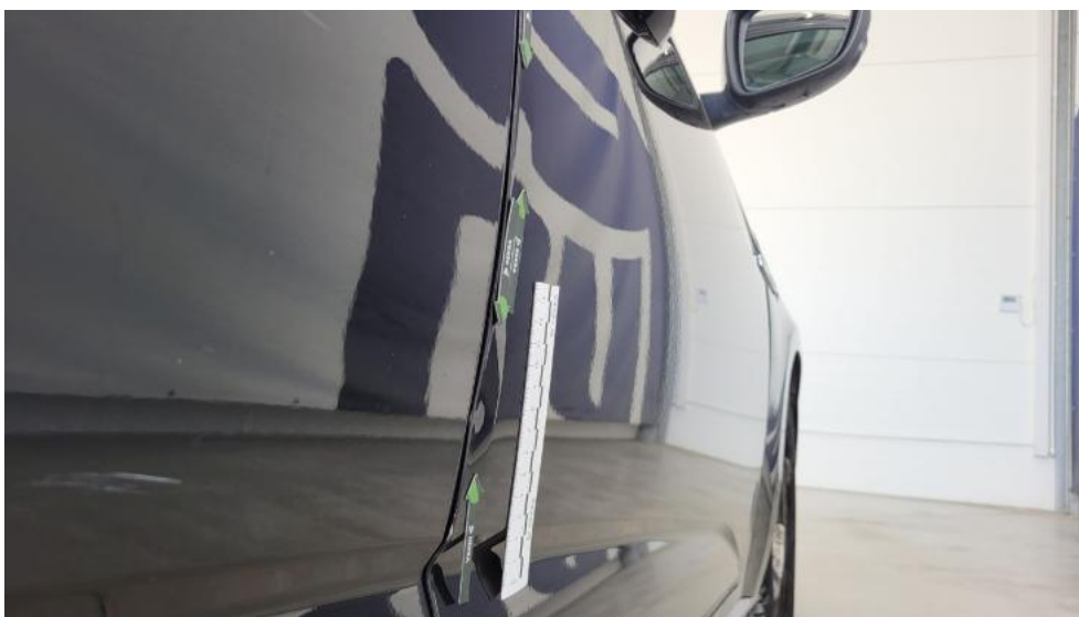
Photo 53. Drzwi przednie P - Wgniecenie/odkształcenie 1
