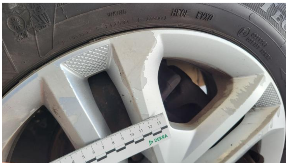
Photo 73. Kołpak tylny L - Rysa/odprysk 1
