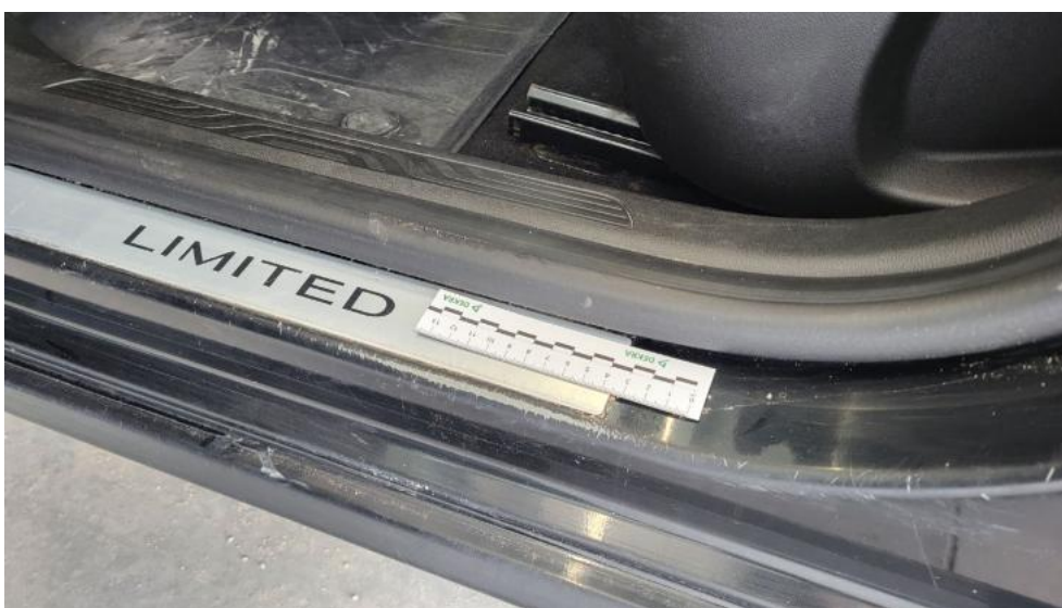
Photo 82. Próg L - Rysa/odprysk 2
