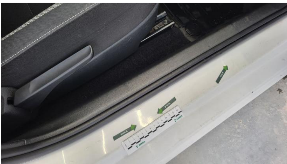
Photo 59. Próg P - Wgniecenie/odkształcenie 1
