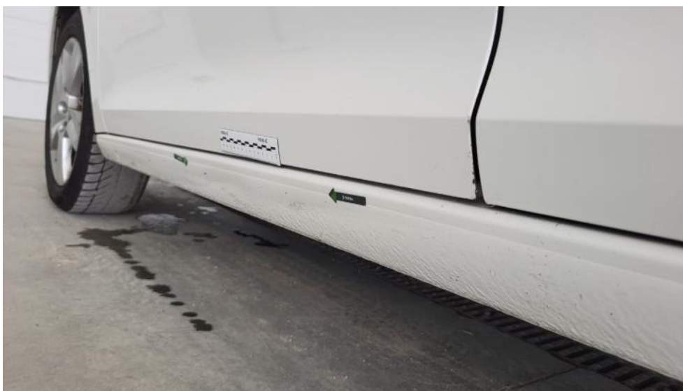
Photo 89. Próg L - Wgniecenie/odkształcenie 1
