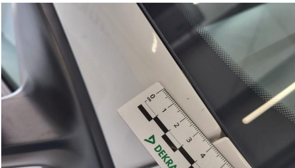
Photo 62. Słupek przedni P - Rysa/odprysk 1
