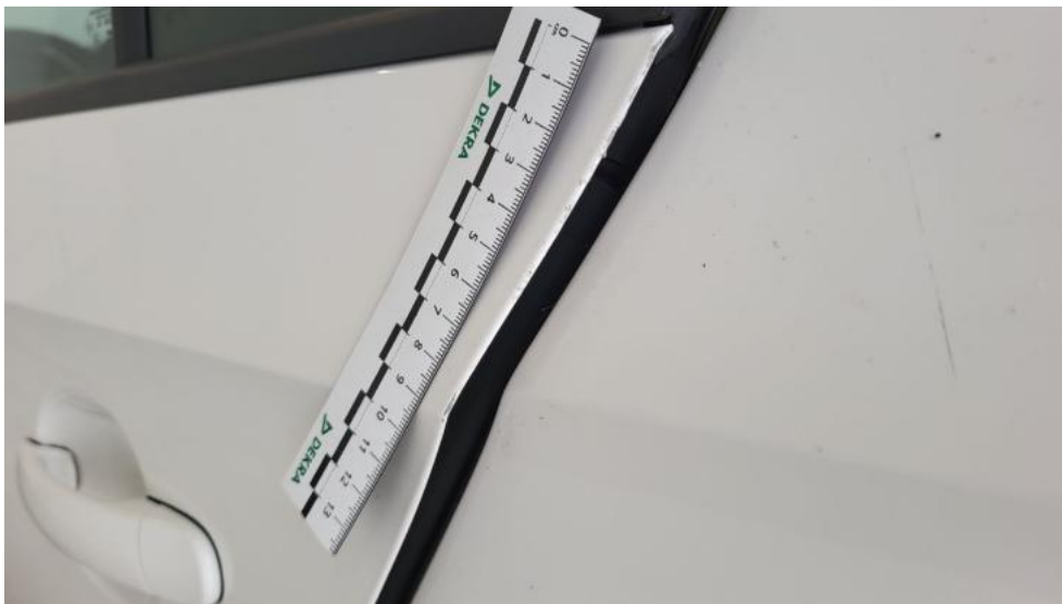
Photo 85. Drzwi tylne L - Rysa/odprysk 1
