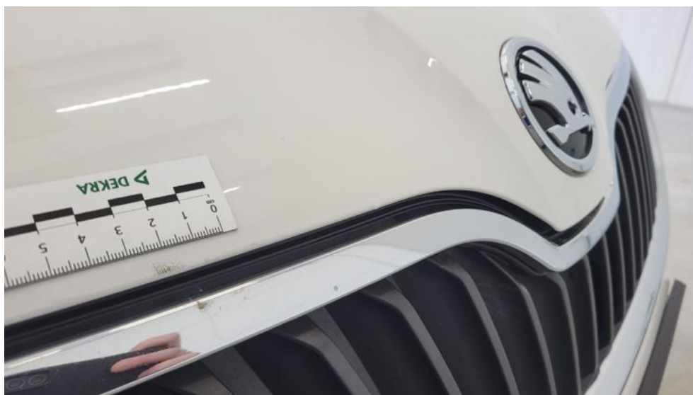
Photo 44. Pokrywa komory silnika - Rysa/odprysk 1
