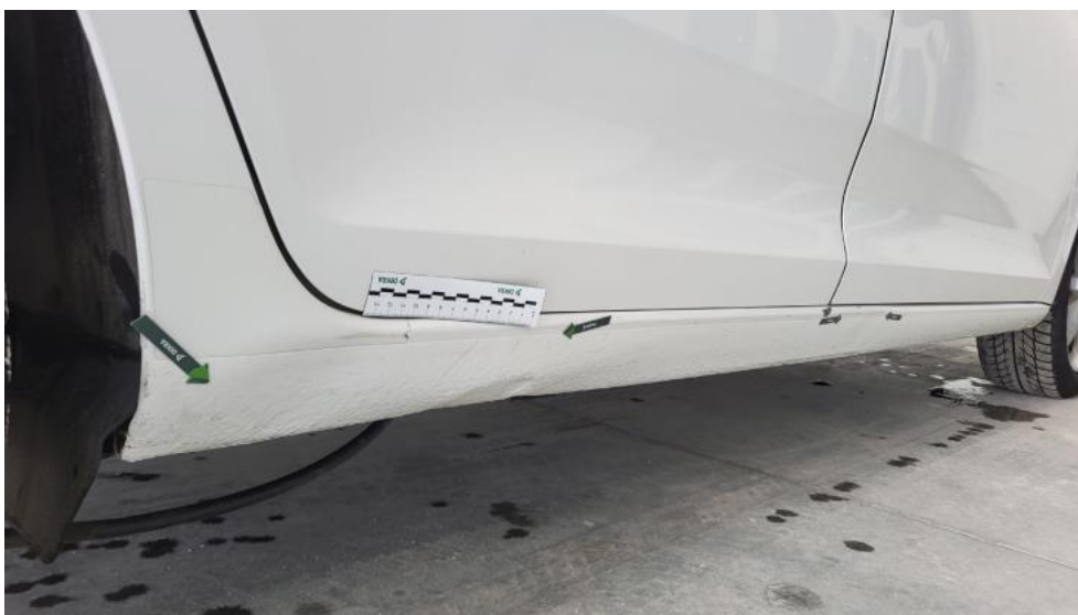
Photo 60. Próg P - Wgniecenie/odkształcenie 2
