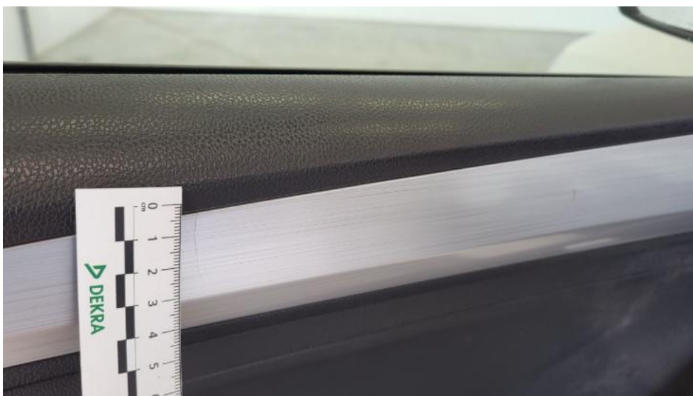
Photo 104. Tapicerka drzwi przednich L - Pęknięcie/rozerwanie 1
