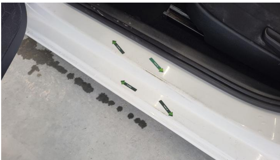
Photo 90. Próg L - Wgniecenie/odkształcenie 2
