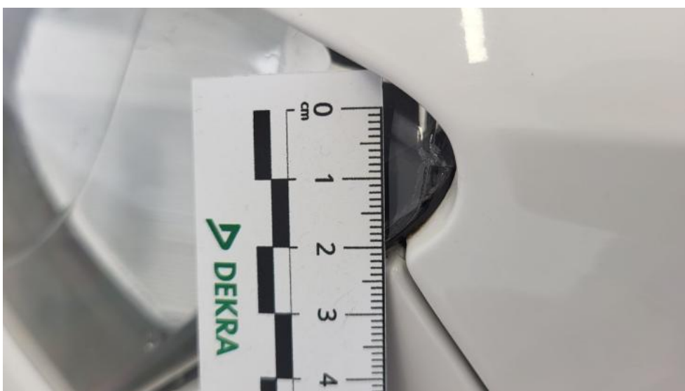
Photo 94. Reflektor L - Pęknięcie/rozerwanie 1
