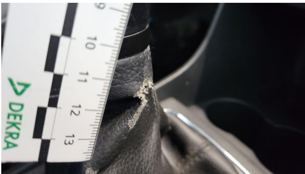
Photo 97. Gałka dźwigni zmiany biegów - Pęknięcie/rozerwanie 1
