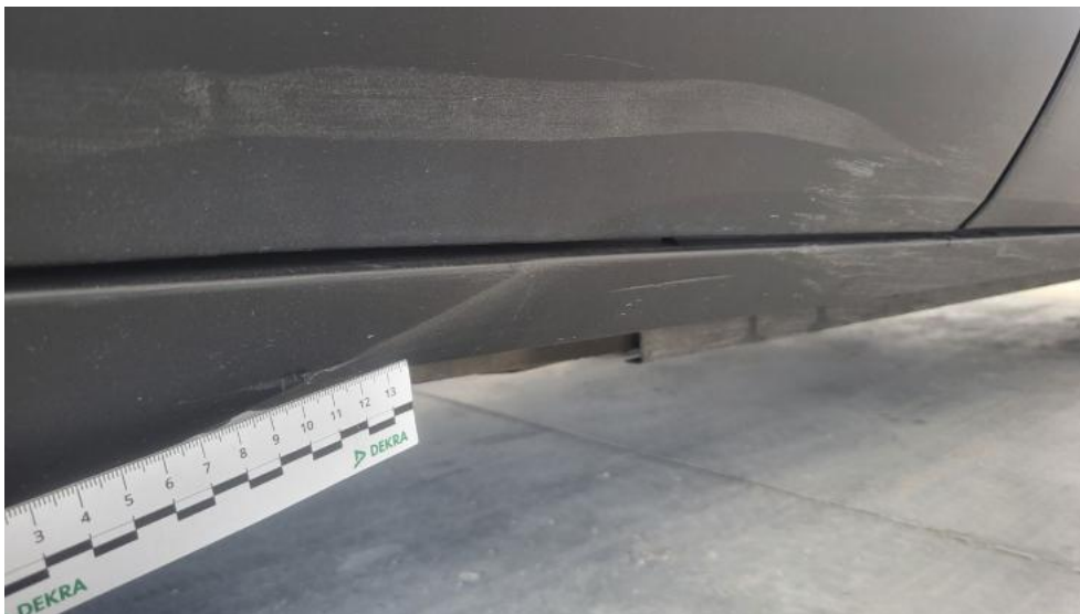
Photo 59. Próg P - Rysa/odprysk 1
