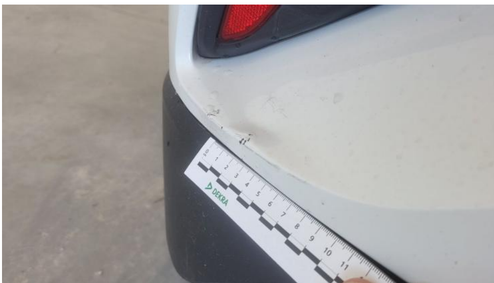
Photo 65. Zderzak tylny - Wgniecenie/odkształcenie 2
