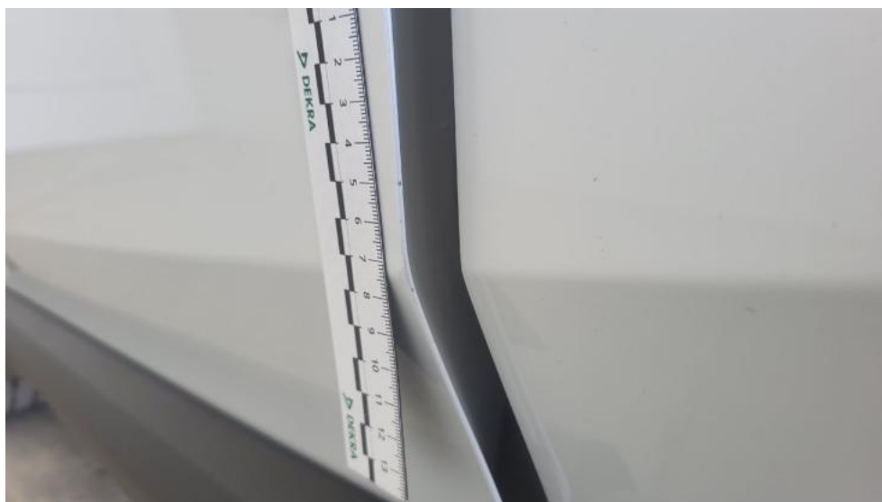
Photo 70. Drzwi przed L - Rysa/odprysk 1
