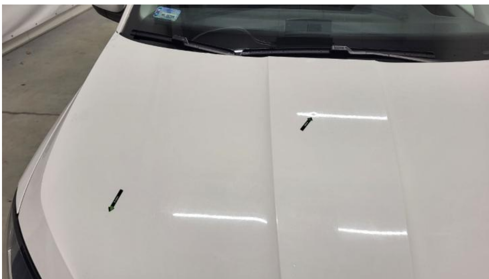
Photo 40. Pokrywa komory silnika - Wgniecenie/odkształcenie 1
