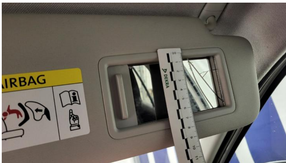
Photo 83. Osłona p/słoneczna prawa - Pęknięcie/rozerwanie 1
