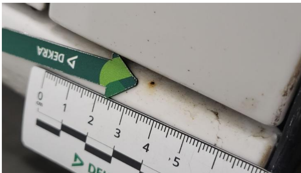
Photo 51. Próg P - Wgniecenie/odkształcenie 1
