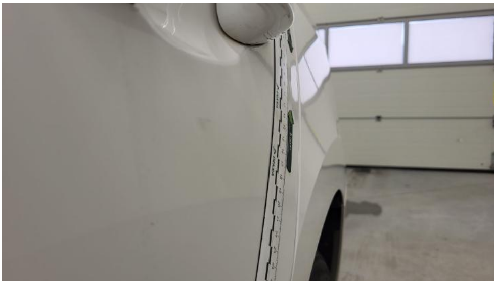
Photo 69. Drzwi tylne L - Wgniecenie/odkształcenie 1
