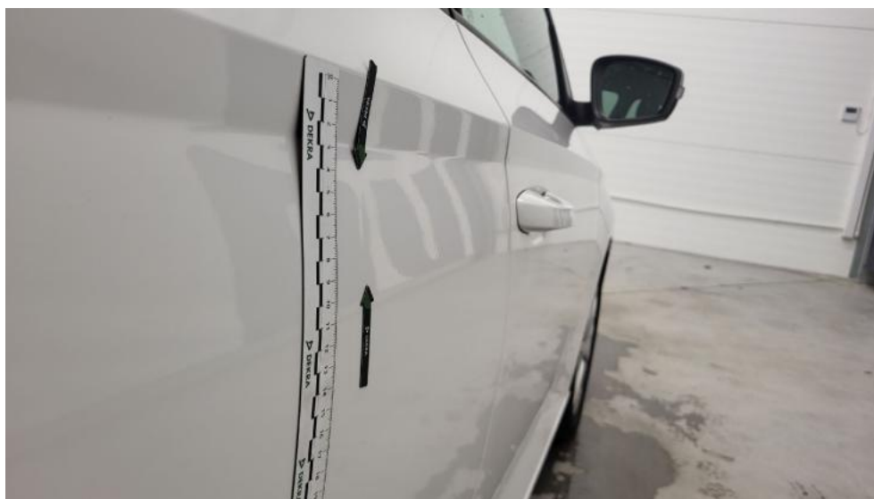
Photo 49. Drzwi tylne P - Wgniecenie/odkształcenie 1
