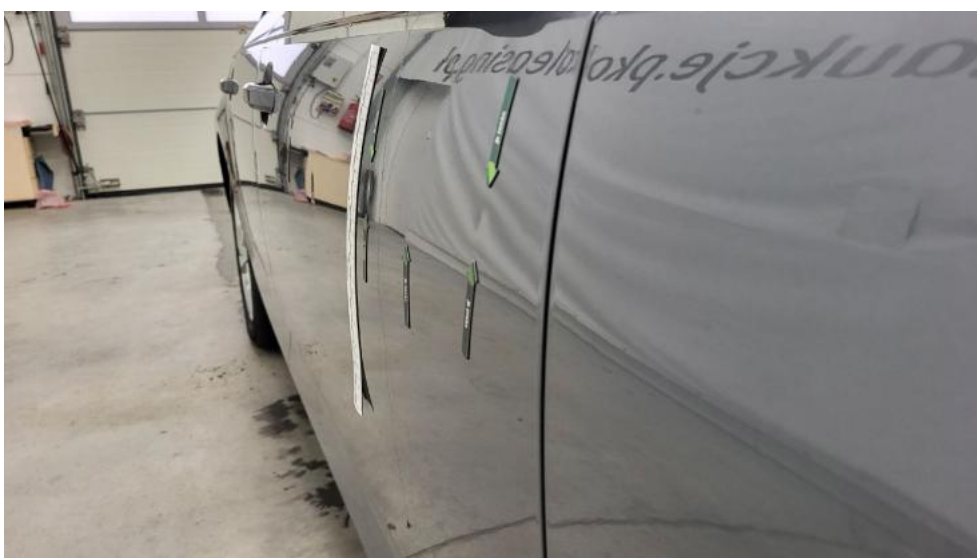
Fot. 52. Drzwi przednie P - Wgniecenie/odkształcenie 1
