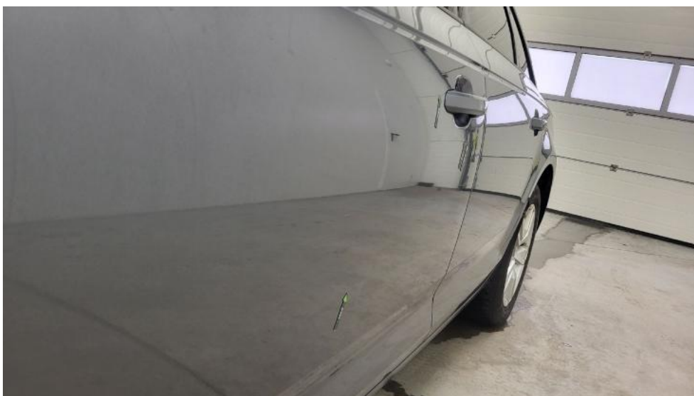
Fot. 66. Drzwi przed L - Wgniecenie/odkształcenie 1
