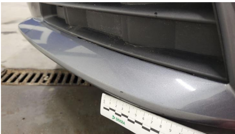
Fot. 43. Zderzak - Rysa/odprysk 1
