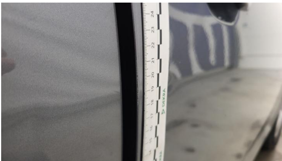
Fot. 51. Drzwi przednie P - Rysa/odprysk 1
