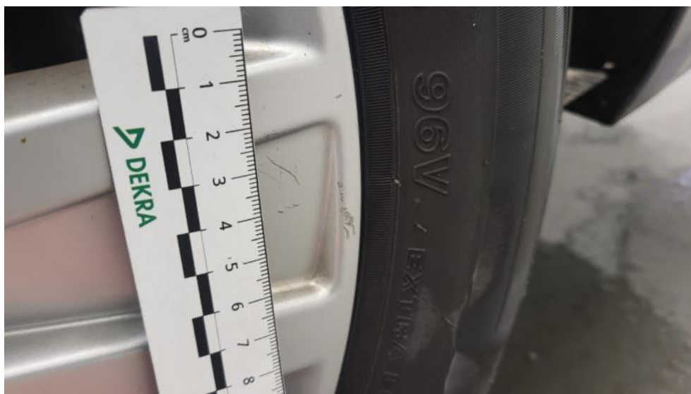
Fot. 63. Felga aluminiowa tylna L - Rysa/odprysk 1
