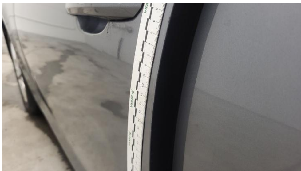
Fot. 64. Drzwi przed L - Rysa/odprysk 1
