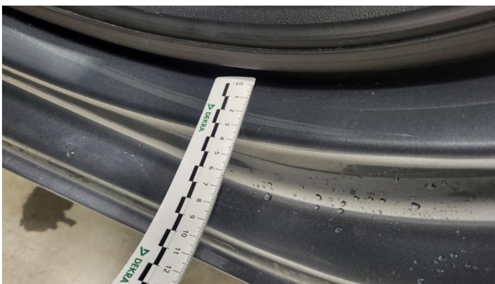
Fot. 68. Próg L - Rysa/odprysk 1
