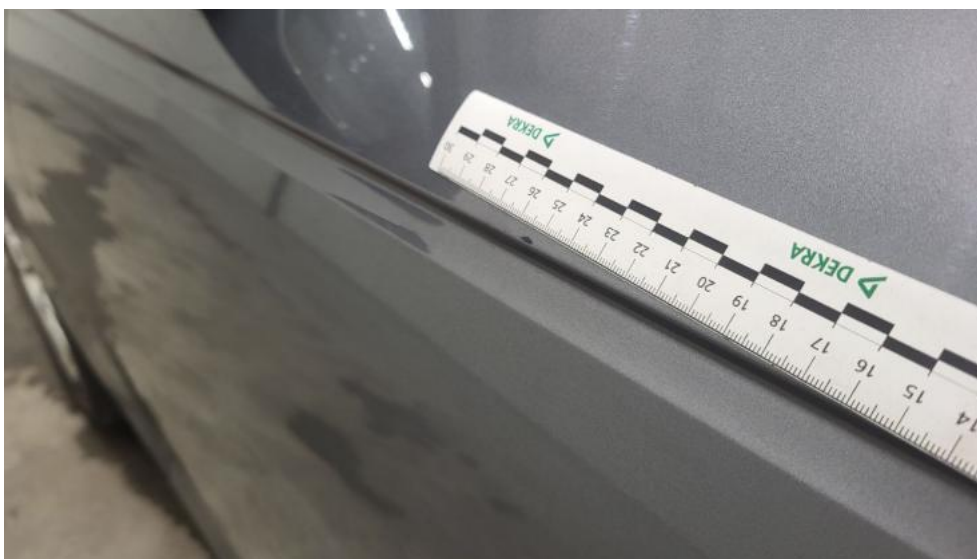
Fot. 65. Drzwi przed L - Rysa/odprysk 2
