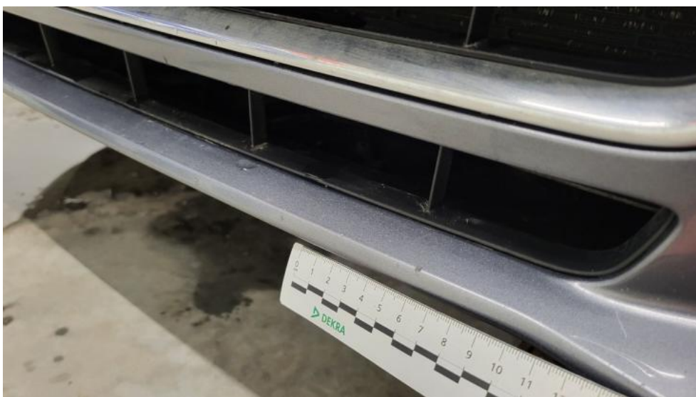
Fot. 44. Zderzak - Rysa/odprysk 2
