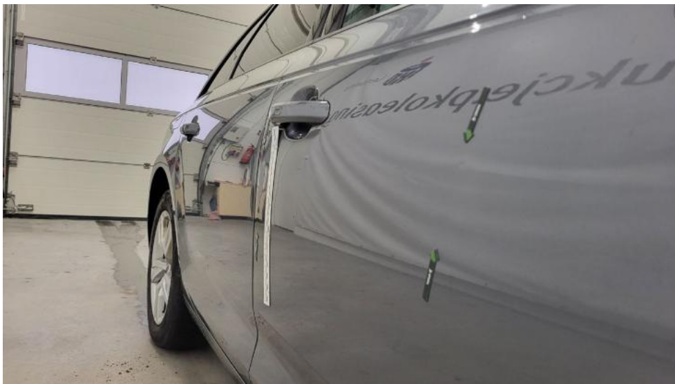
Fot. 53. Drzwi przednie P - Wgniecenie/odkształcenie 2
