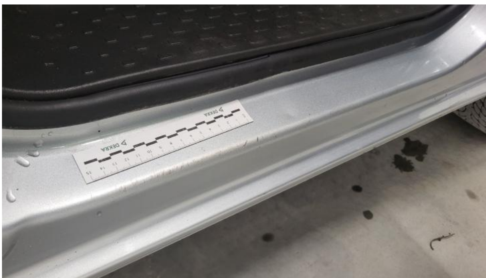
Photo 41. Próg P - Rysa/odprysk 1
