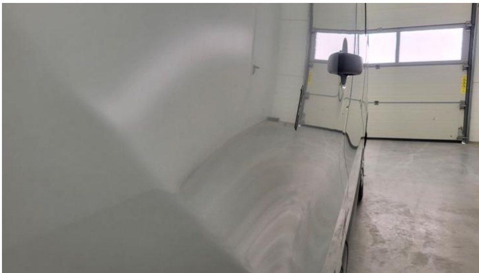
Photo 55. Drzwi przed L - Wgniecenie/odkształcenie 1
