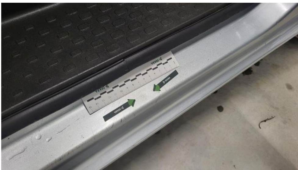
Photo 42. Próg P - Wgniecenie/odkształcenie 1
