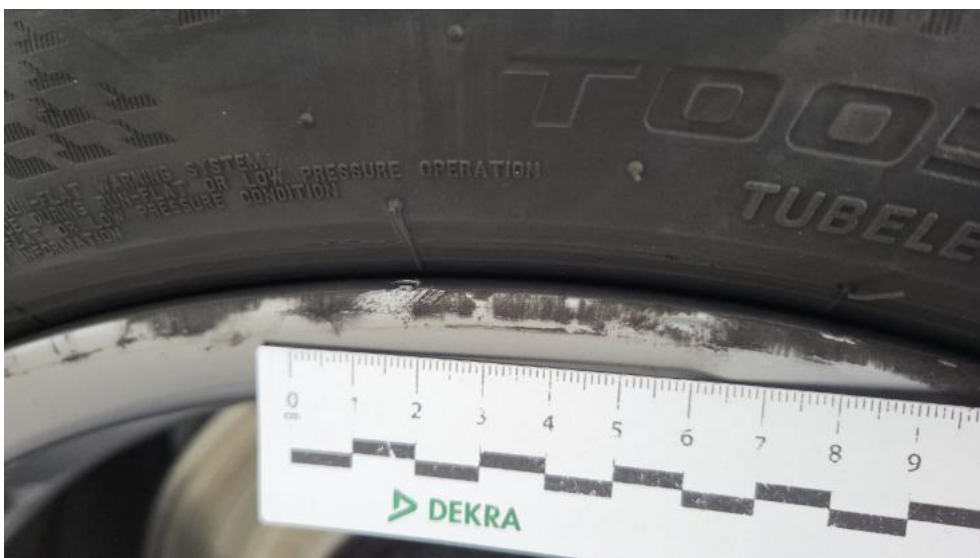
Photo 58. Felga Aluminiowa przednia L - Rysa/odprysk 1
