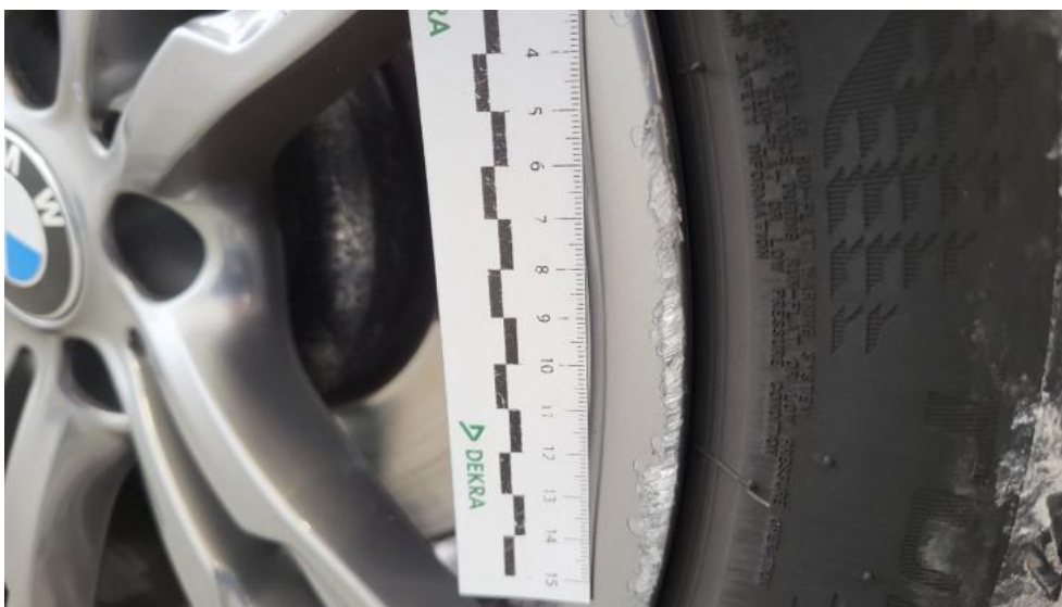
Photo 51. Felga aluminiowa przednia P - Rysa/odprysk 1
