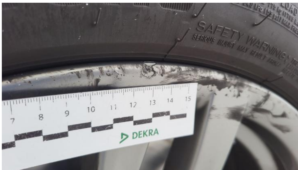
Photo 55. Felga aluminiowa tylna L - Rysa/odprysk 1
