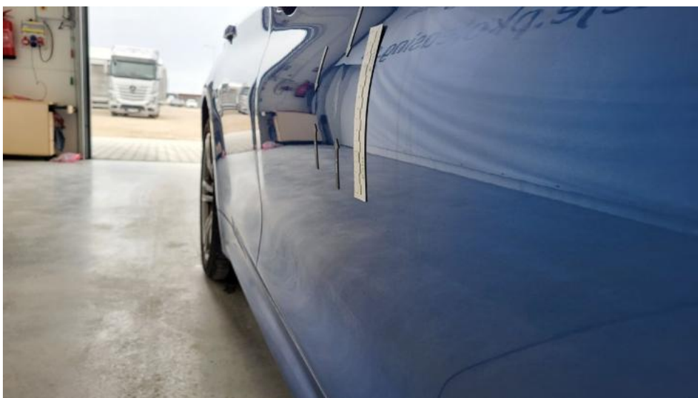
Photo 52. Drzwi przednie P - Wgniecenie/odkształcenie 1
