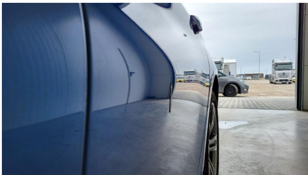
Photo 56. Drzwi tylne L - Wgniecenie/odkształcenie 1
