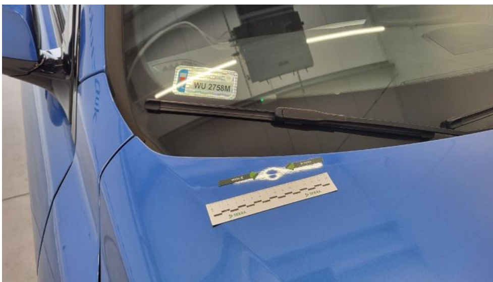
Photo 45. Pokrywa komory silnika - Wgniecenie/odkształcenie 1
