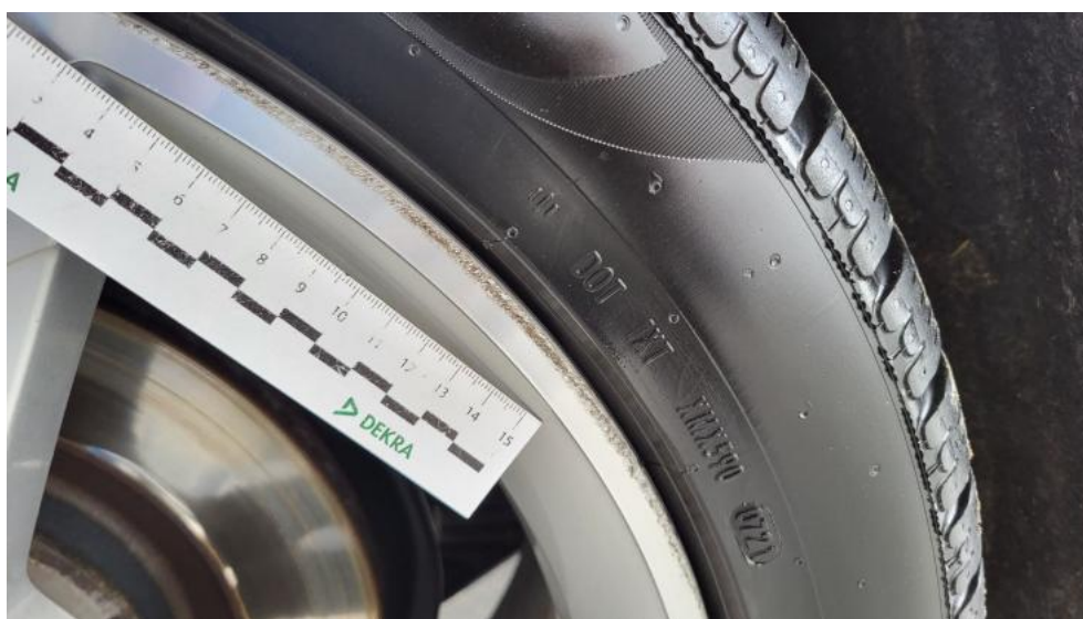
Photo 64. Felga aluminiowa tylna L - Rysa/odprysk 1
