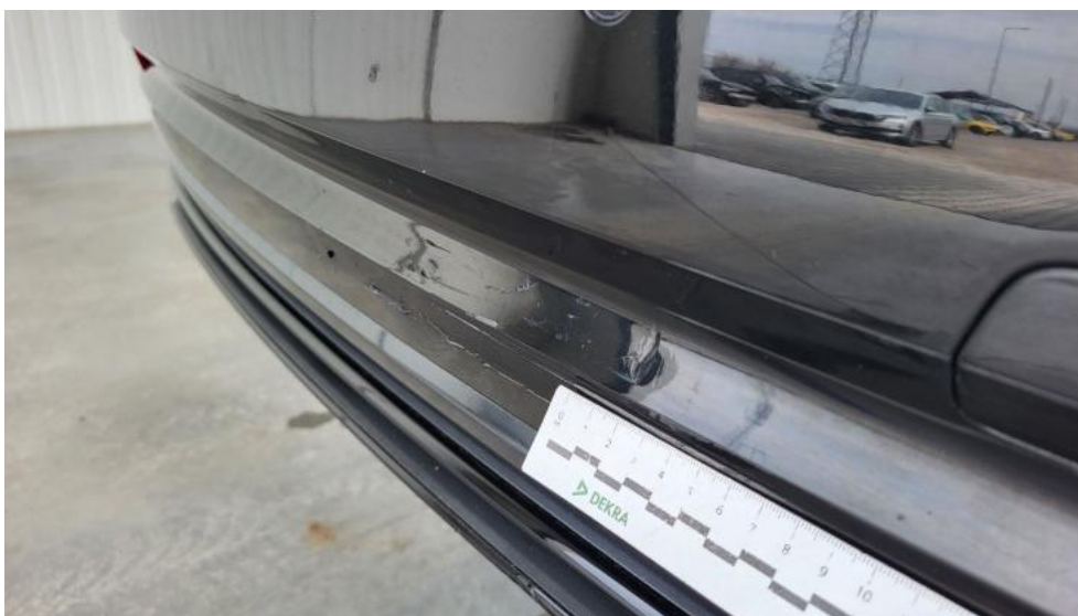
Photo 60. Zderzak tylny - Wgniecenie/odkształcenie 1
