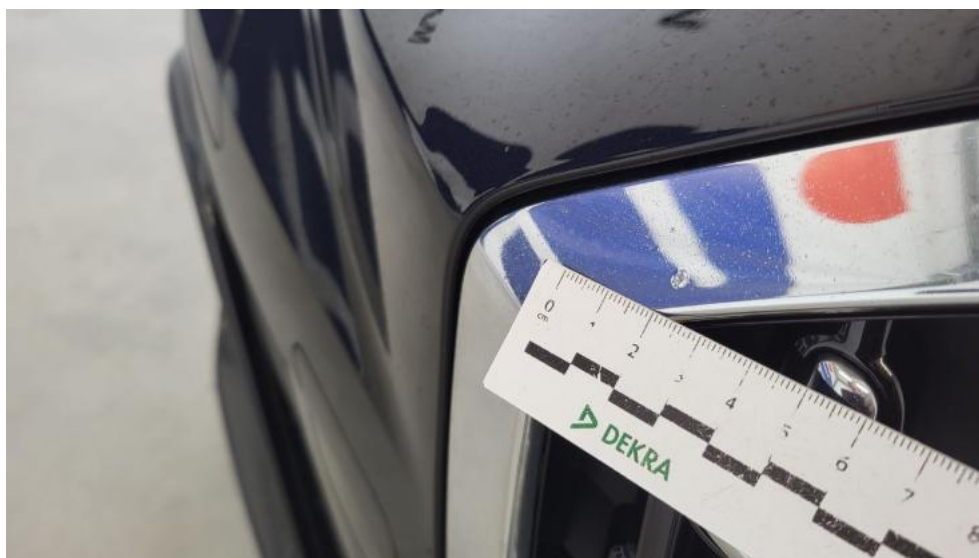
Photo 48. Listwa śr zderzaka przedniego - Wgniecenie/odkształcenie 1
