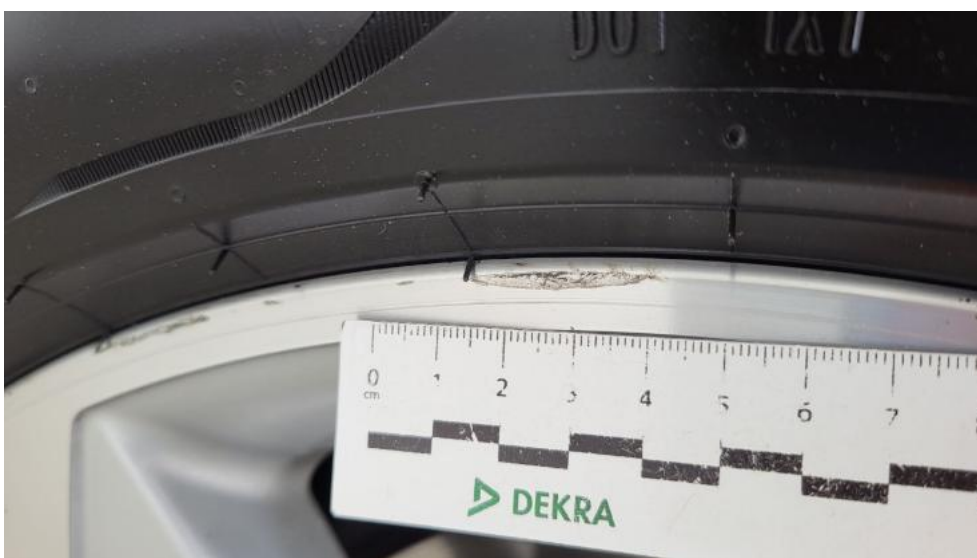
Photo 68. Felga Aluminiowa przednia L - Rysa/odprysk 1
