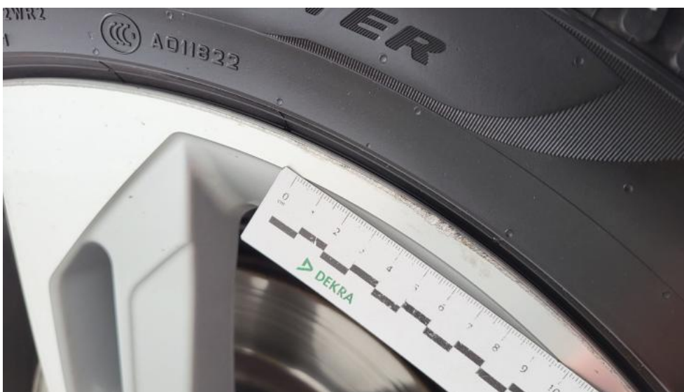
Photo 58. Felga aluminiowa tylna P - Rysa/odprysk 1
