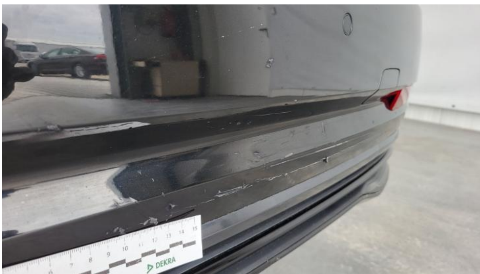
Photo 61. Zderzak tylny - Wgniecenie/odkształcenie 2
