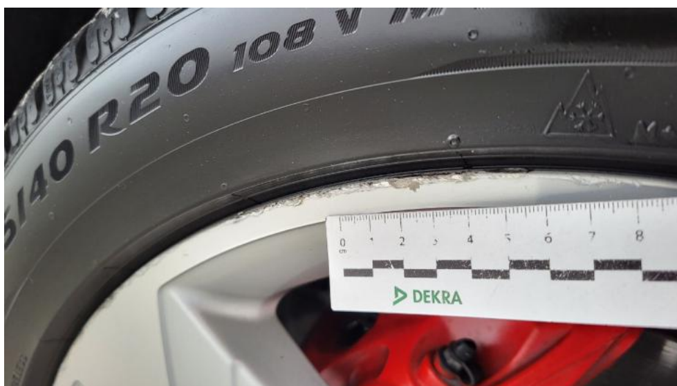
Photo 54. Felga aluminiowa przednia P - Rysa/odprysk 1
