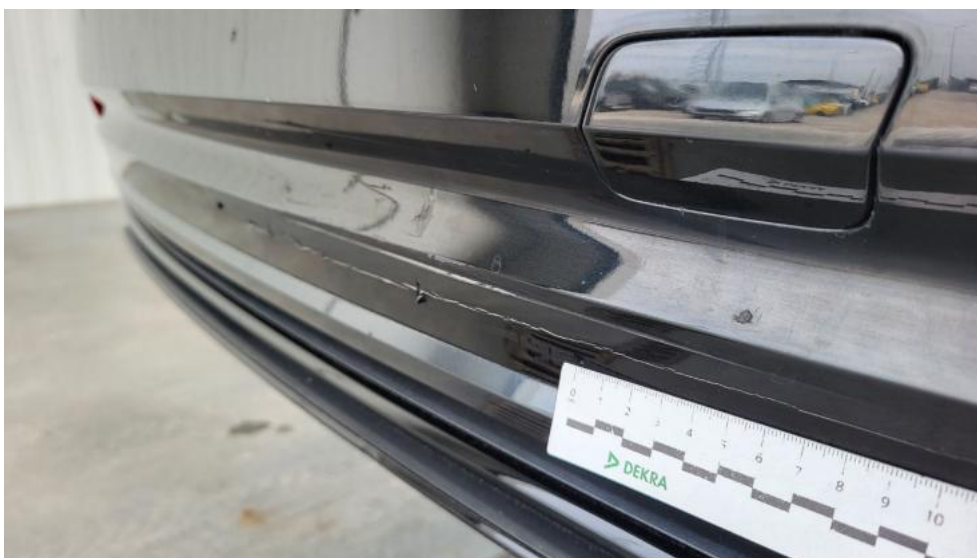
Photo 62. Zderzak tylny - Pęknięcie/rozerwanie 1
