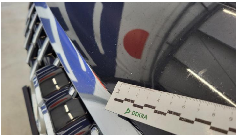
Photo 49. Pokrywa komory silnika - Rysa/odprysk 1
