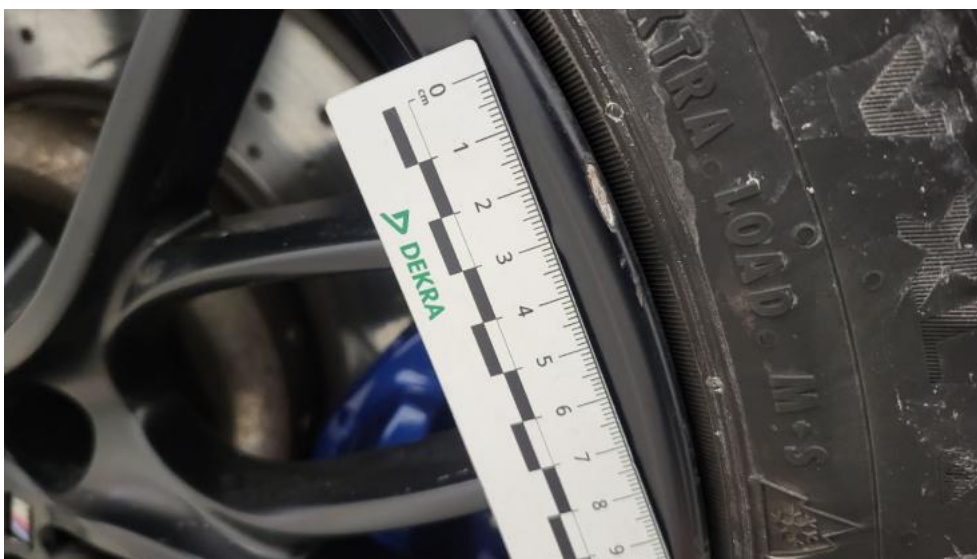
Fot. 59. Felga aluminiowa tylna P - Rysa/odprysk 1
