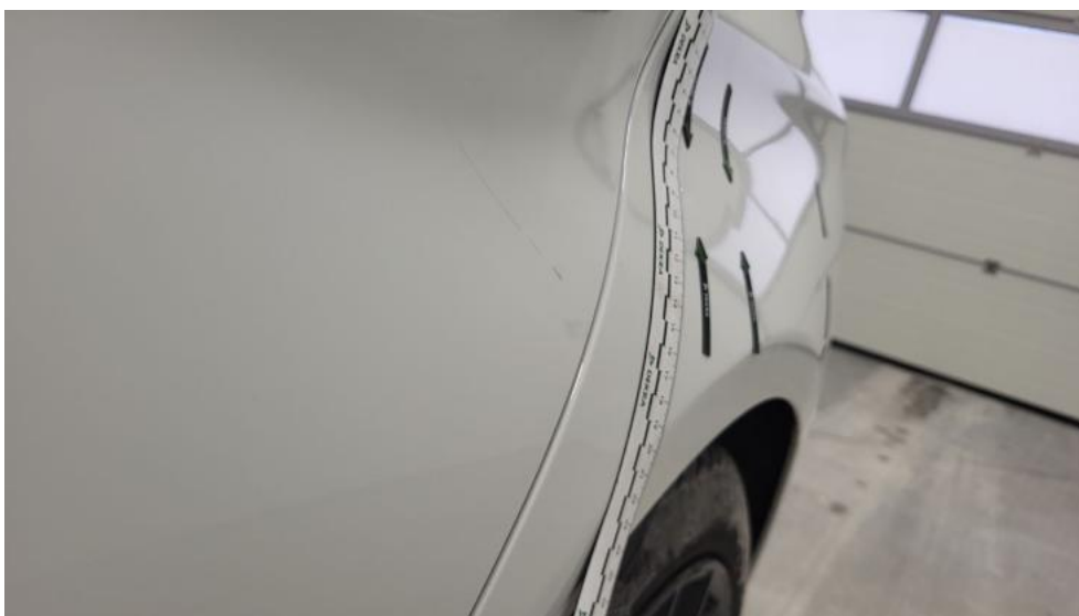
Fot. 62. Błotnik tylny L / Ściana boczna L - Wgniecenie/odkształcenie 1
