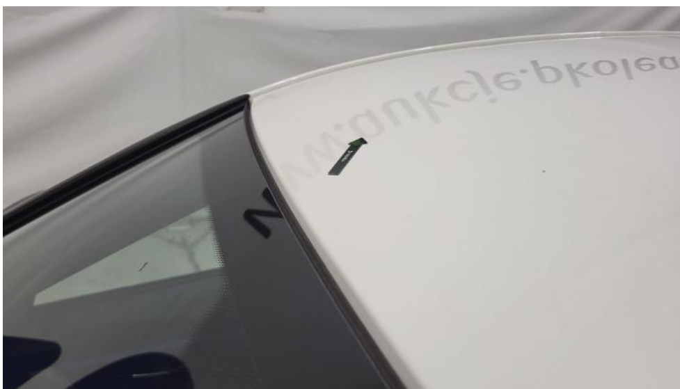
Fot. 61. Dach - Wgniecenie/odkształcenie 1
