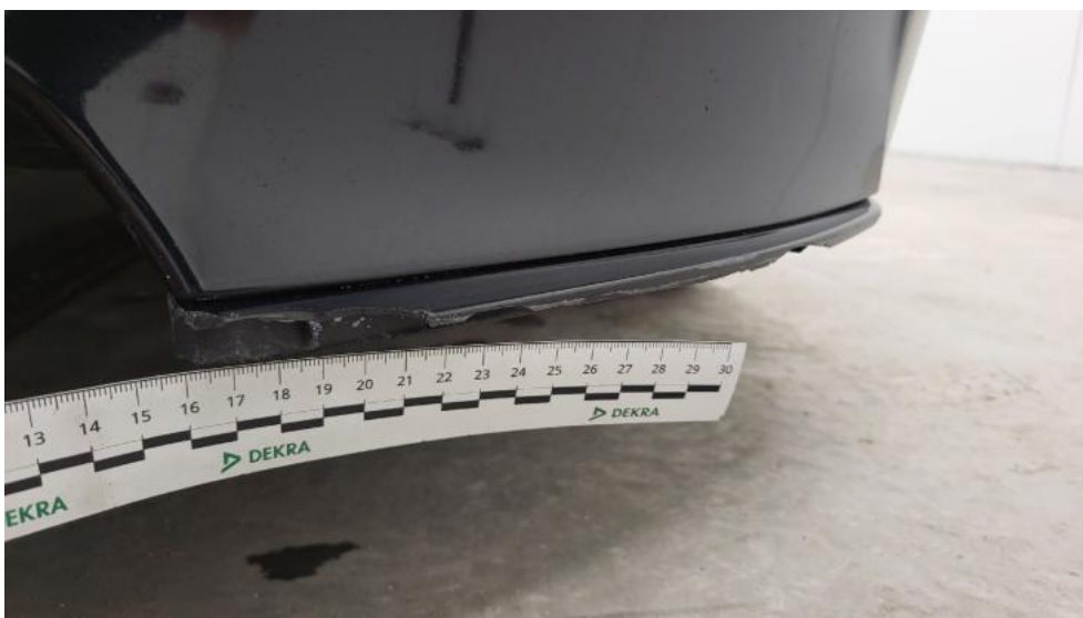
Fot. 46. Spoiler zderzaka przedniego - Pęknięcie/rozerwanie 1
