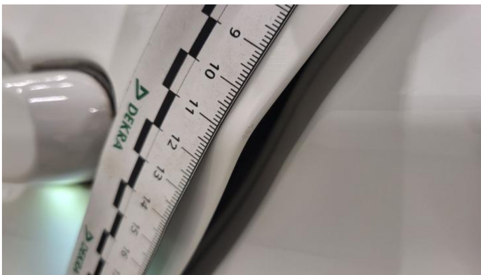
Fot. 67. Drzwi tylne L - Rysa/odprysk 1
