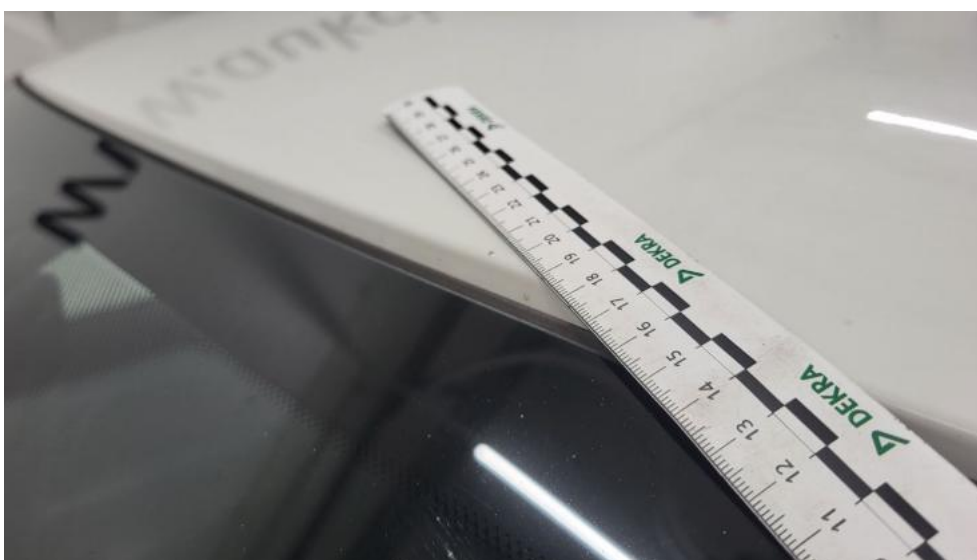
Fot. 60. Dach - Rysa/odprysk 1
