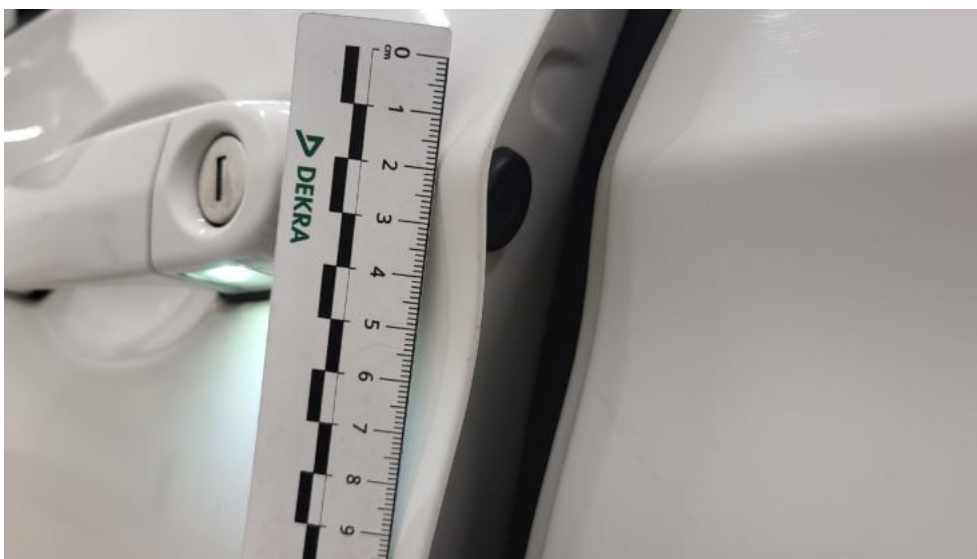
Fot. 65. Drzwi przed L - Rysa/odprysk 1
