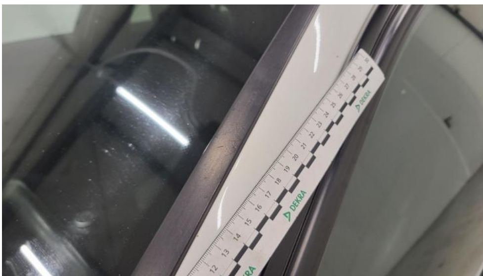
Fot. 69. Słupek przedni L - Rysa/odprysk 1
