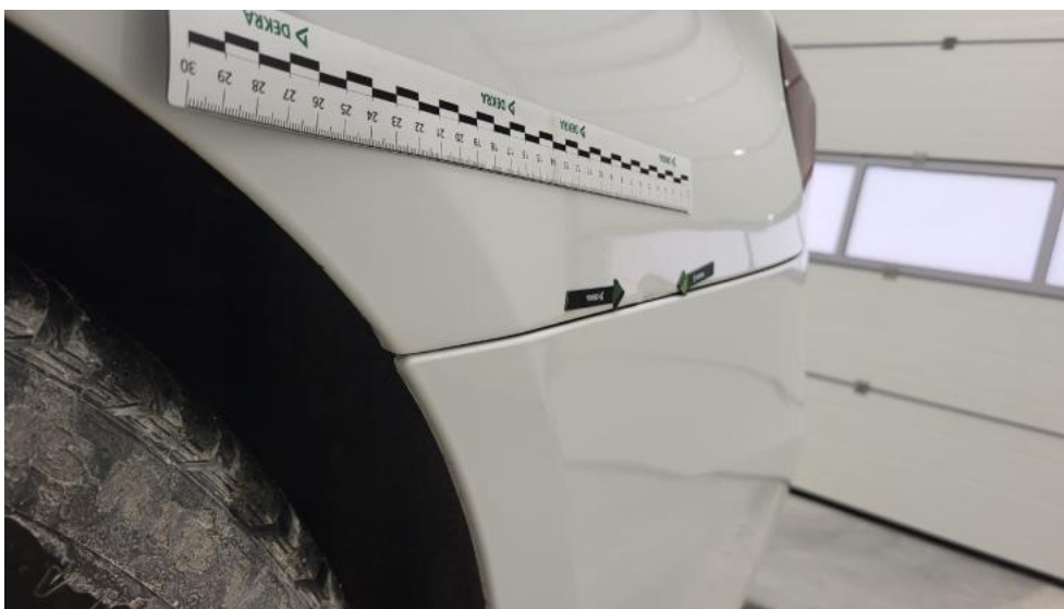
Fot. 63. Błotnik tylny L / Ściana boczna L - Wgniecenie/odkształcenie 2
