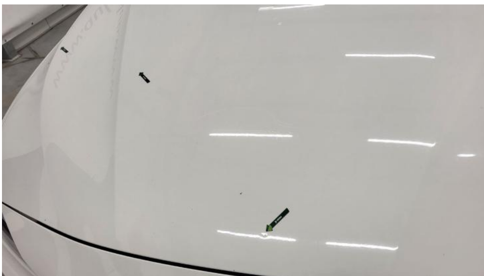
Fot. 44. Pokrywa komory silnika - Wgniecenie/odkształcenie 1
