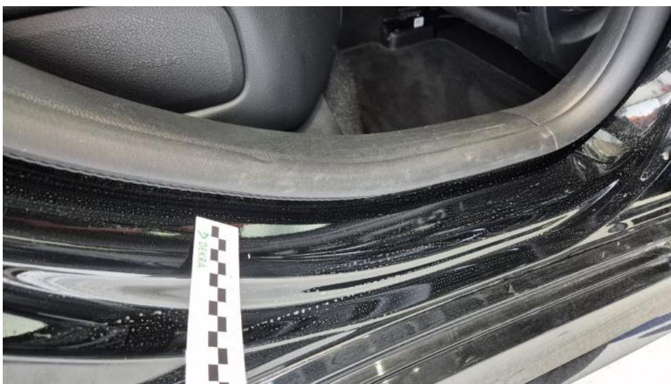
Fot. 53. Próg P - Rysa/odprysk 1
