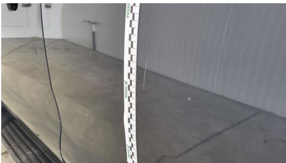
Photo 62. Drzwi tylne L - Rysa/odprysk 1
