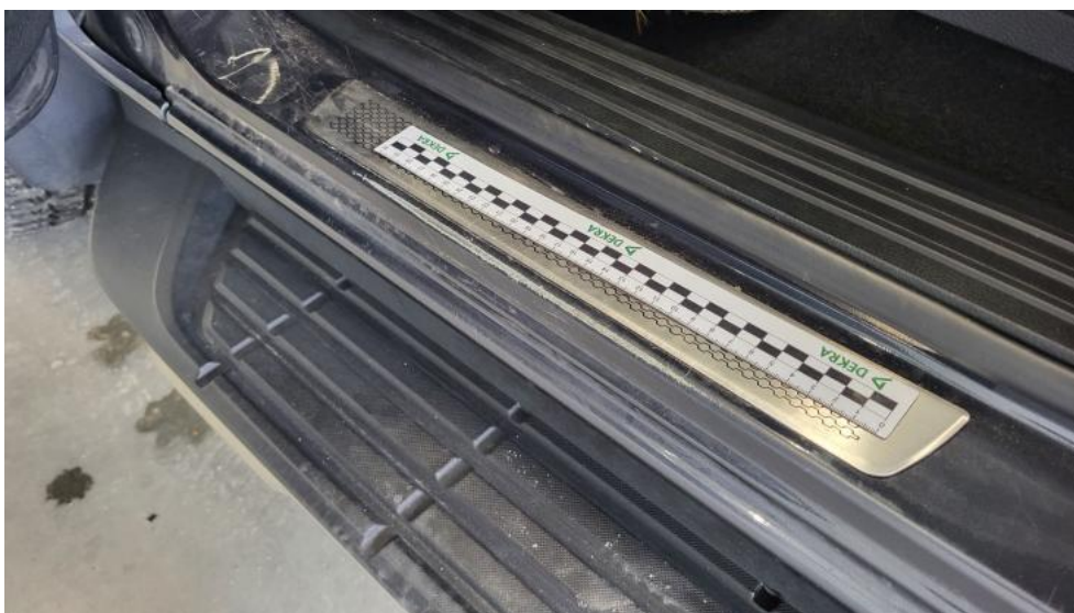
Photo 66. Próg L - Rysa/odprysk 2
