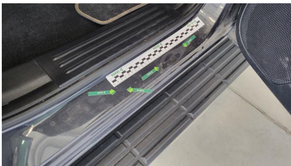
Photo 46. Próg P - Wgniecenie/odkształcenie 2
