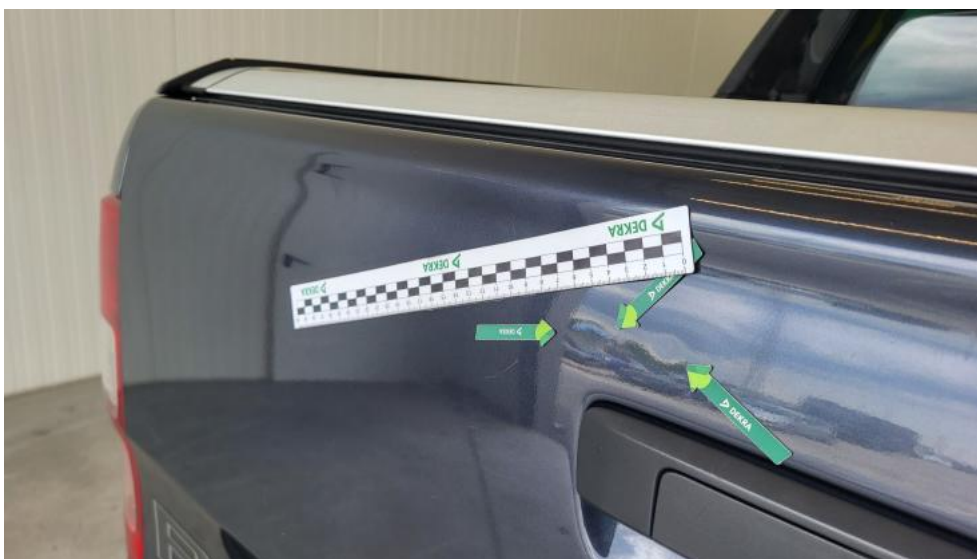
Photo 51. Pokrywy bagażnika - Wgniecenie/odkształcenie 1
