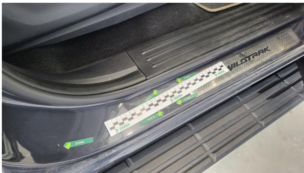
Photo 45. Próg P - Wgniecenie/odkształcenie 1
