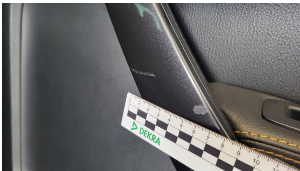
Photo 75. Uchwyt drzwi tyl P - Rysa/odprysk 1
