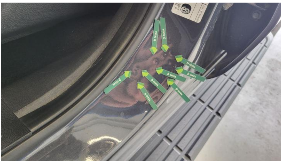
Photo 67. Próg L - Wgniecenie/odkształcenie 1
