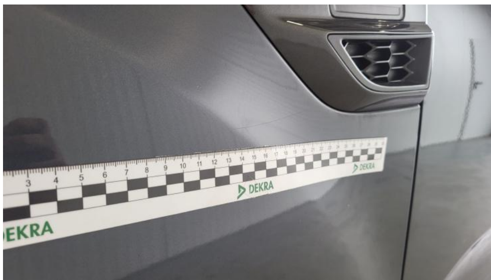
Photo 69. Błotnik przedni L - Rysa/odprysk 1
