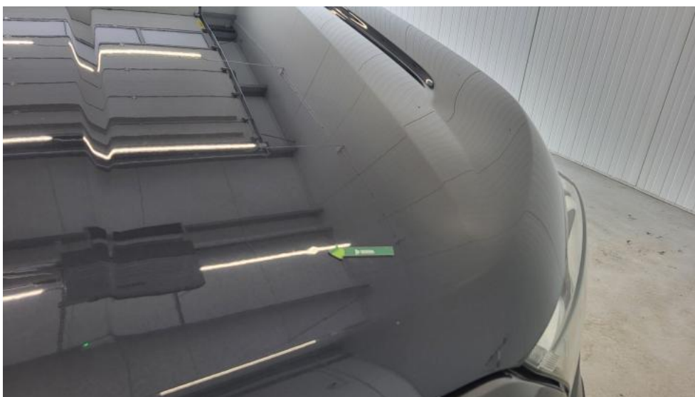
Photo 37. Pokrywa komory silnika - Wgniecenie/odkształcenie 1
