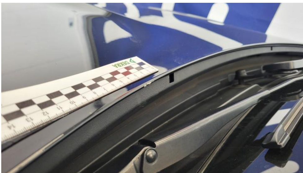
Fot. 51. Pokrywa komory silnika - Rysa/odprysk 1
