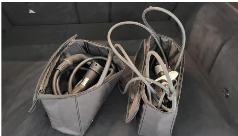
Fot. 36. Przewód ładowania baterii trakcyjnej
