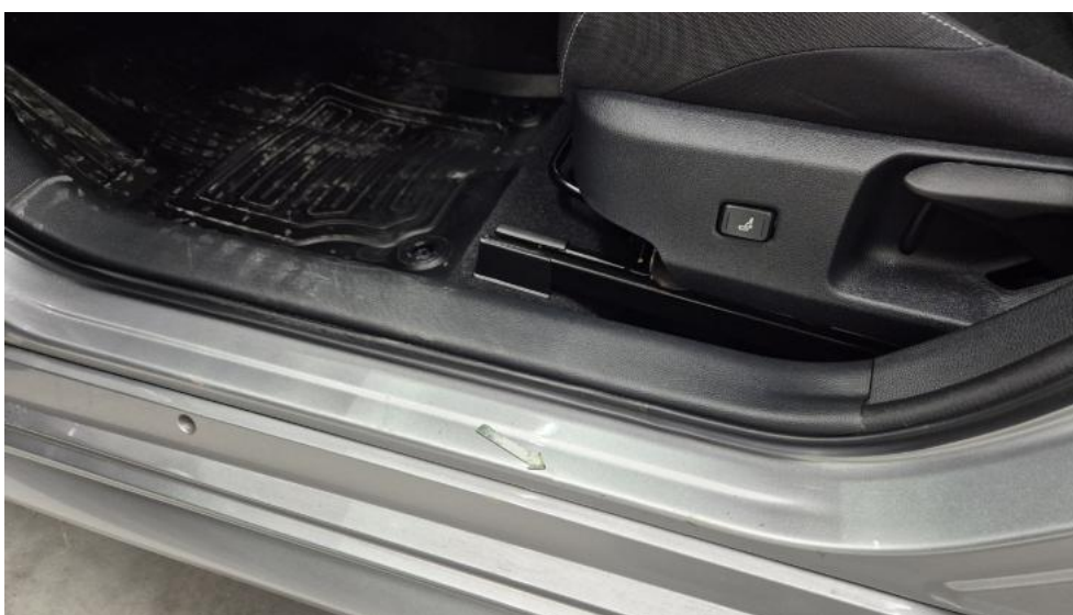
Fot. 54. Próg L - Wgniecenie/odkształcenie 1
