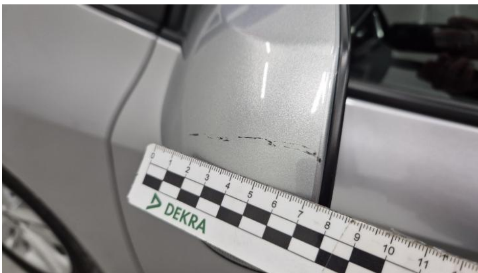
Fot. 53. Lusterko zew L - Rysa/odprysk 1
