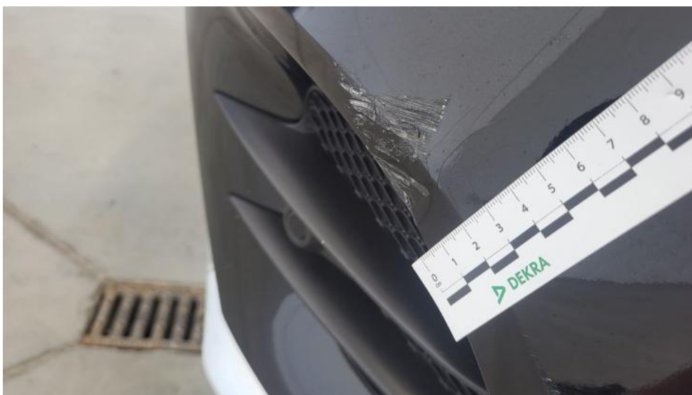
Fot. 44. Zderzak - Pęknięcie/rozerwanie 1
