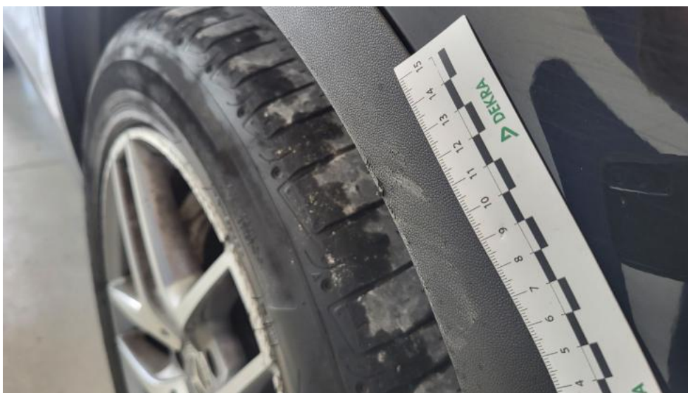
Fot. 46. Listwa błotnika przedniego P - Rysa/odprysk 1
