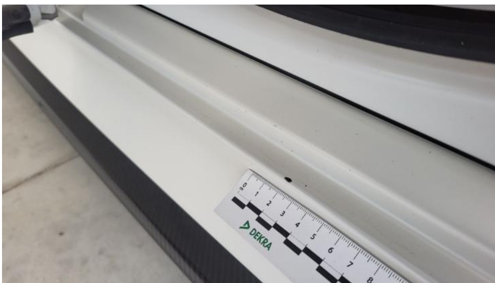
Fot. 71. Próg L - Rysa/odprysk 1
