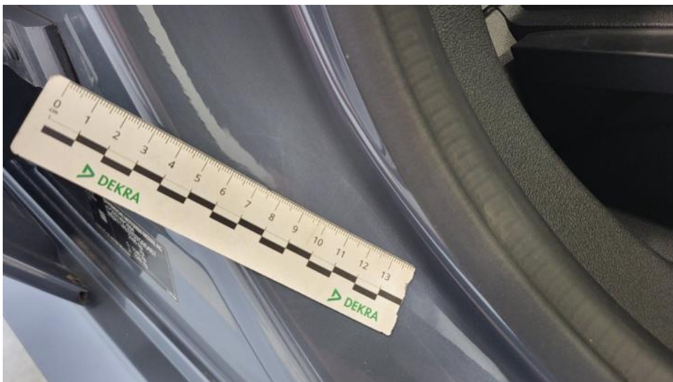
Fot. 57. Słupek środkowy P - Rysa/odprysk 1
