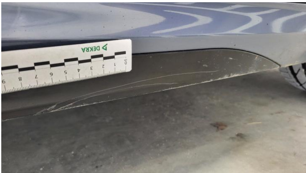
Fot. 55. Próg P - Rysa/odprysk 1
