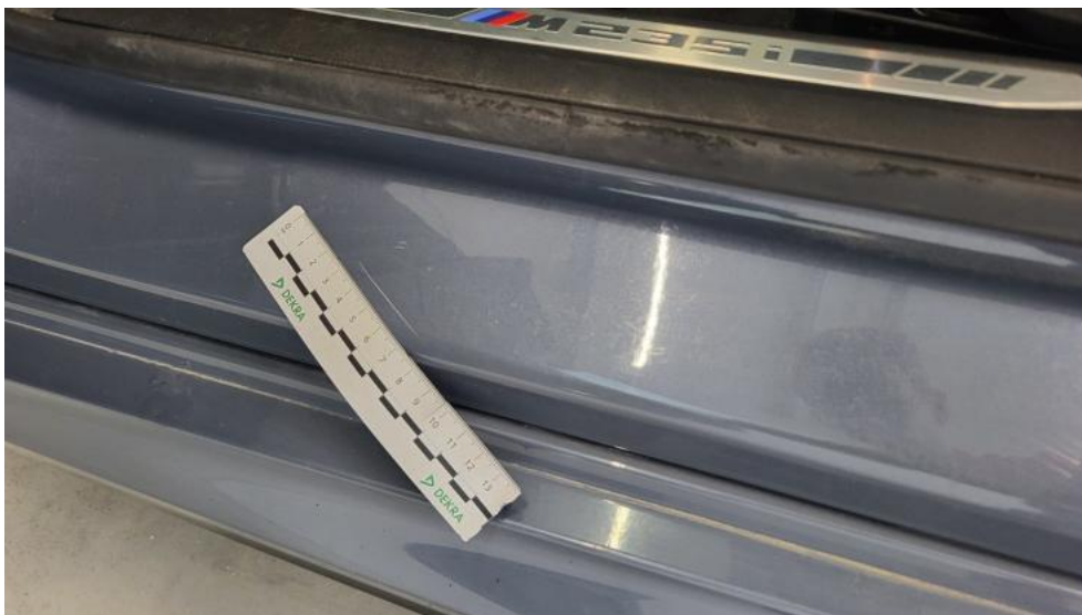
Fot. 73. Próg L - Rysa/odprysk 2
