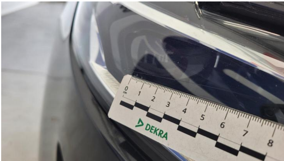
Photo 61. Reflektor P - Rysa/odprysk 1
